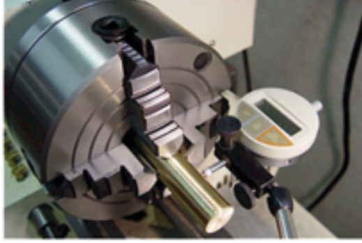
Görsel 4.28: Tornada iş parçasının komparatör ile salgı kontrolünün yapılması
