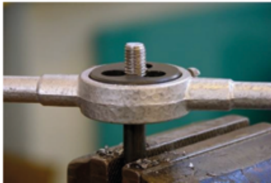
Görsel 3.38: Pafta ile vida açma işleminin yapılışı
