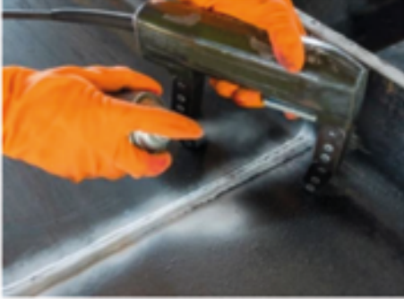
Görsel 2.6: Manyetik parçacık testi uygulaması
