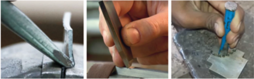
Görsel 1.72: Keski ile kesme, ezme ve koparma işlemlerinin yapılışı
