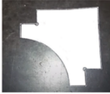
Görsel 1.64: Yapıştırma yöntemi ile markalama
