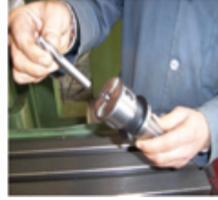
Görsel 5.20 Parmak freze çakısının pense takılması
