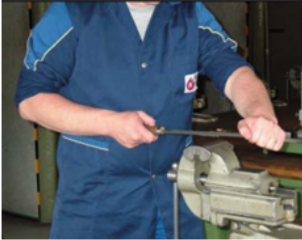
Görsel 1.38: Mengenede çalışma pozisyonu ve mengene yüksekliğinin ayarlanması
