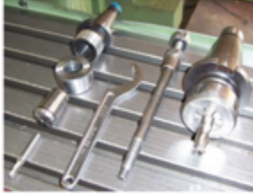
Görsel 5.20 Parmak freze çakısının pense takılması
