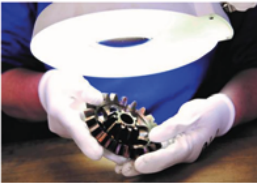
Görsel 2.4: Gözle muayenenin yapılışı
