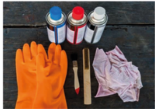
Görsel 2.5: Sıvı girinim (penetrant) testi malzemeleri
