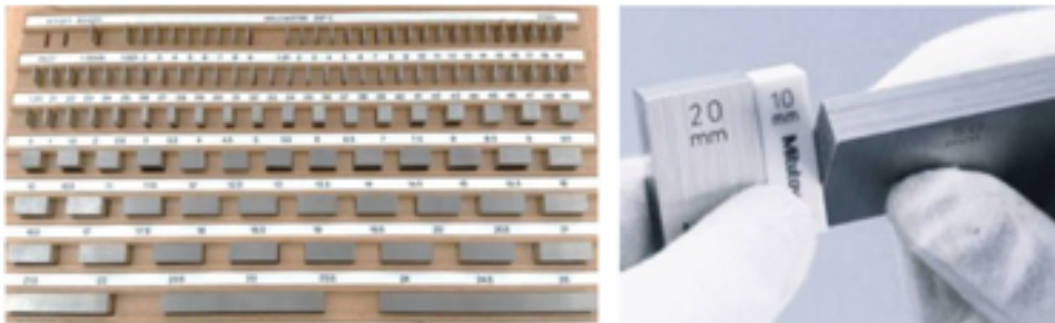
Görsel 1.28: Johnson masterı takımı ve masterların sökülmesi
