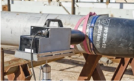
Görsel 2.9: Işın yöntemi (radyografik) testi
