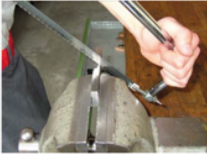
c. Testerenin hatalı olarak dik tutulması
