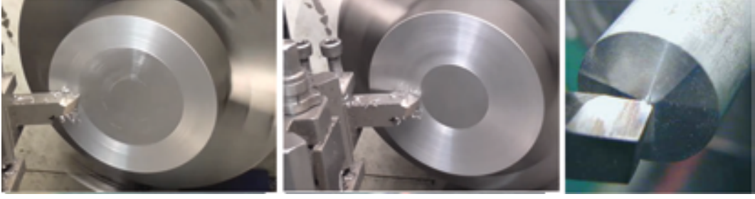
Görsel 4.29: Dıştan içe doğru alın tornalama işleminin yapılması
