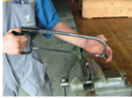
b. Testerenin eğik ağızlatılması
