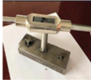
Görsel 3.30: Kırık kılavuz sökme takımı Görsel 3.31: Kırık kılavuzun çıkarılması
