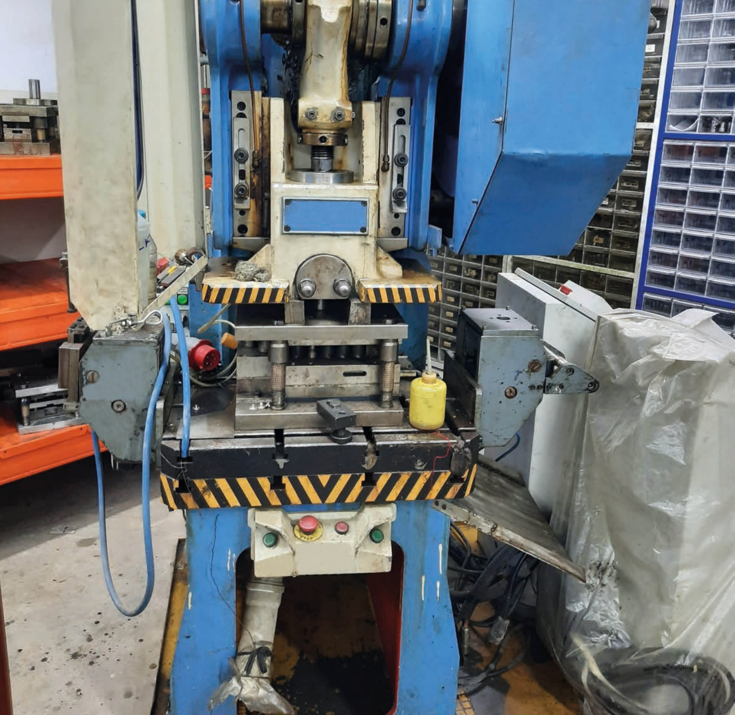
Görsel 8.54: Bükme kalıbının pres tezgâhına bağlanması
