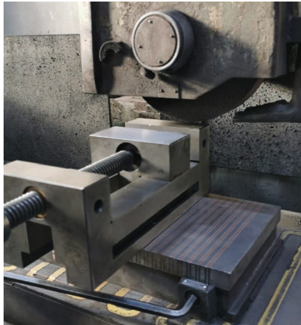
Görsel 7.3: Mengene ile iş parçasının bağlanması
