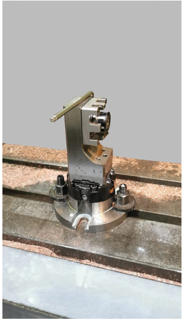
Görsel 7.5: Tablaya bağlama kalıplarıyla iş parçasının bağlanması
