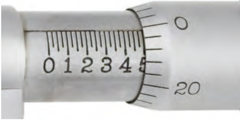
Görsel 49: 0,001" Hassasiyetli Mikrometrenin Okuma Örneği
