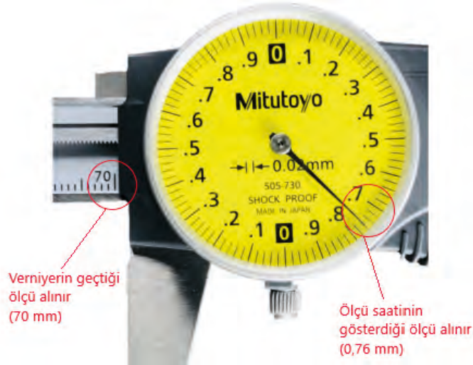
Görsel 28: 0,02mm Hassasiyetli Saatli Kumpasın Okuma Örneği
