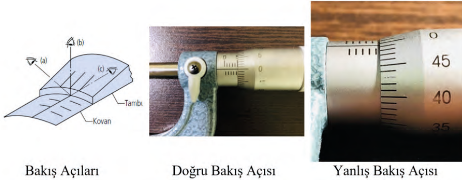
Görsel 34: Mikrometre Kullanımında Bakış Açısı
