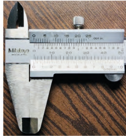
Görsel 25: 1/1000" Hassasiyetli Kumpasın Verniyer Bölüntüsü
