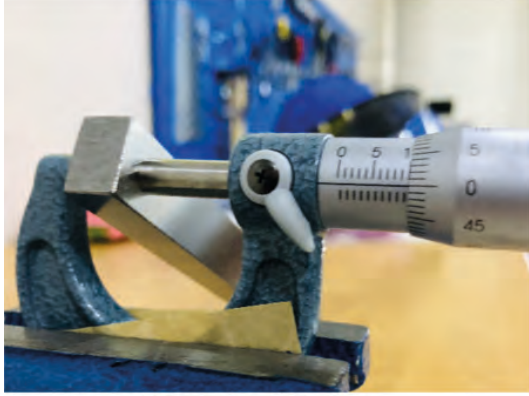
Görsel 39: Mikrometre Ölçü Tamlığı Kontrolü (10x14mm paralel master)
