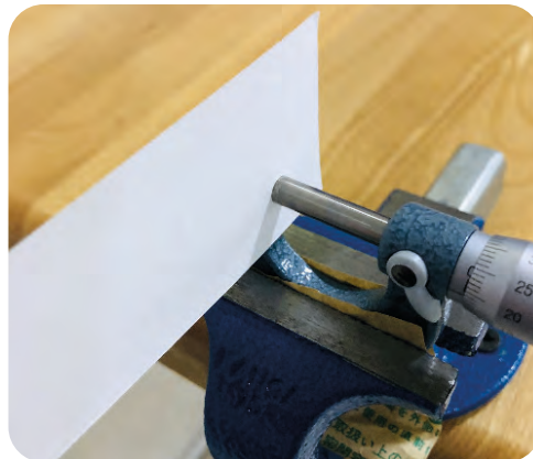
Görsel 35: Ölçüm Ağzlarının Temizlenmesi
