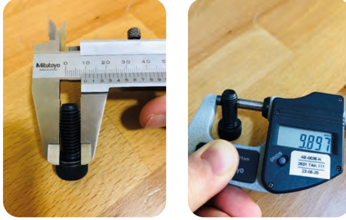
Görsel 86: Diş Üstü Çapının Ölçülmesi
