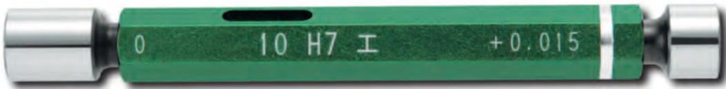
Görsel 95: \varnothing 10 H7 Toleransı için Tampon Mastar
