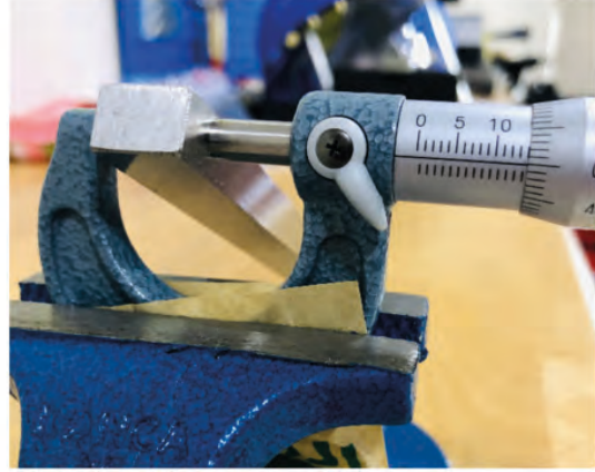
Görsel 39: Mikrometre Ölçü Tamlığı Kontrolü (10x14mm paralel master)
