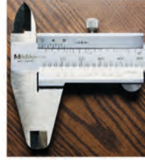
Görsel 23: 1/128" Hassasiyetli Kumpasın Verniyer Bölüntüsü
