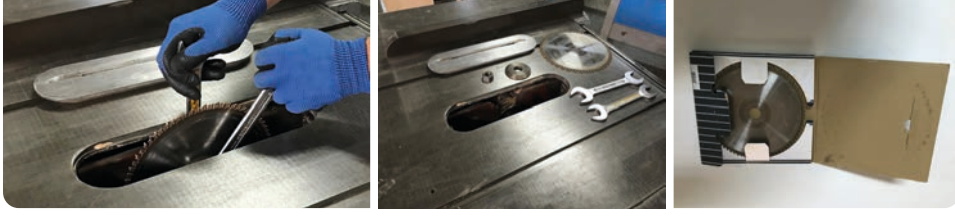
Görsel 2.28: Daire testere makine bıçaklarının sökülmesi
