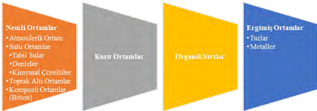
Görsel 46: Korozyona Sebep Olan Ortamlar
