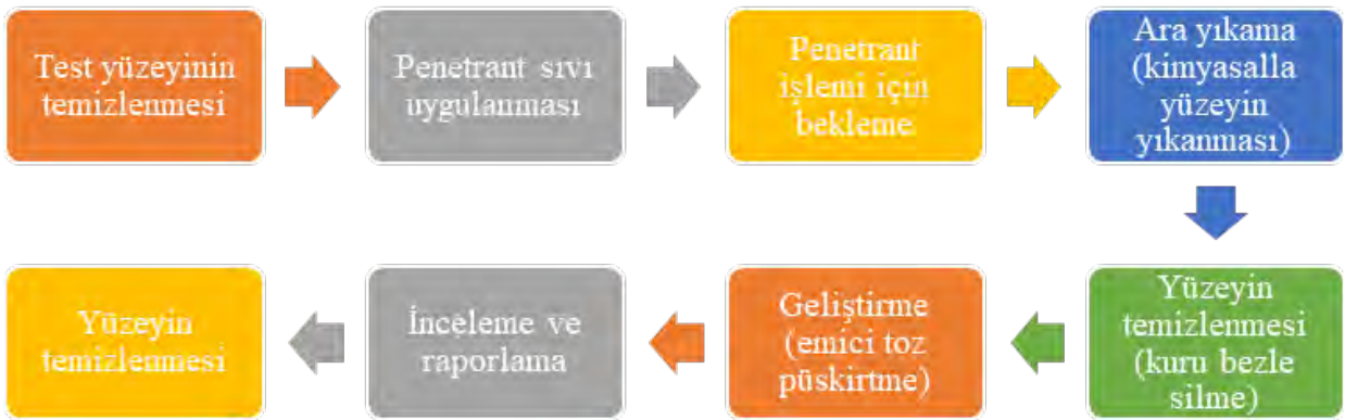
Görsel 68: Penetrant Sıvı ile Muayene İşlem Adımları
