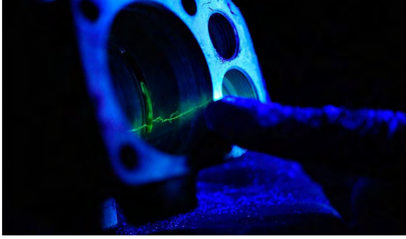
Görsel 69: Penetrant Uygulamasını Sonrası Yüzey Hatasının Görülmesi
