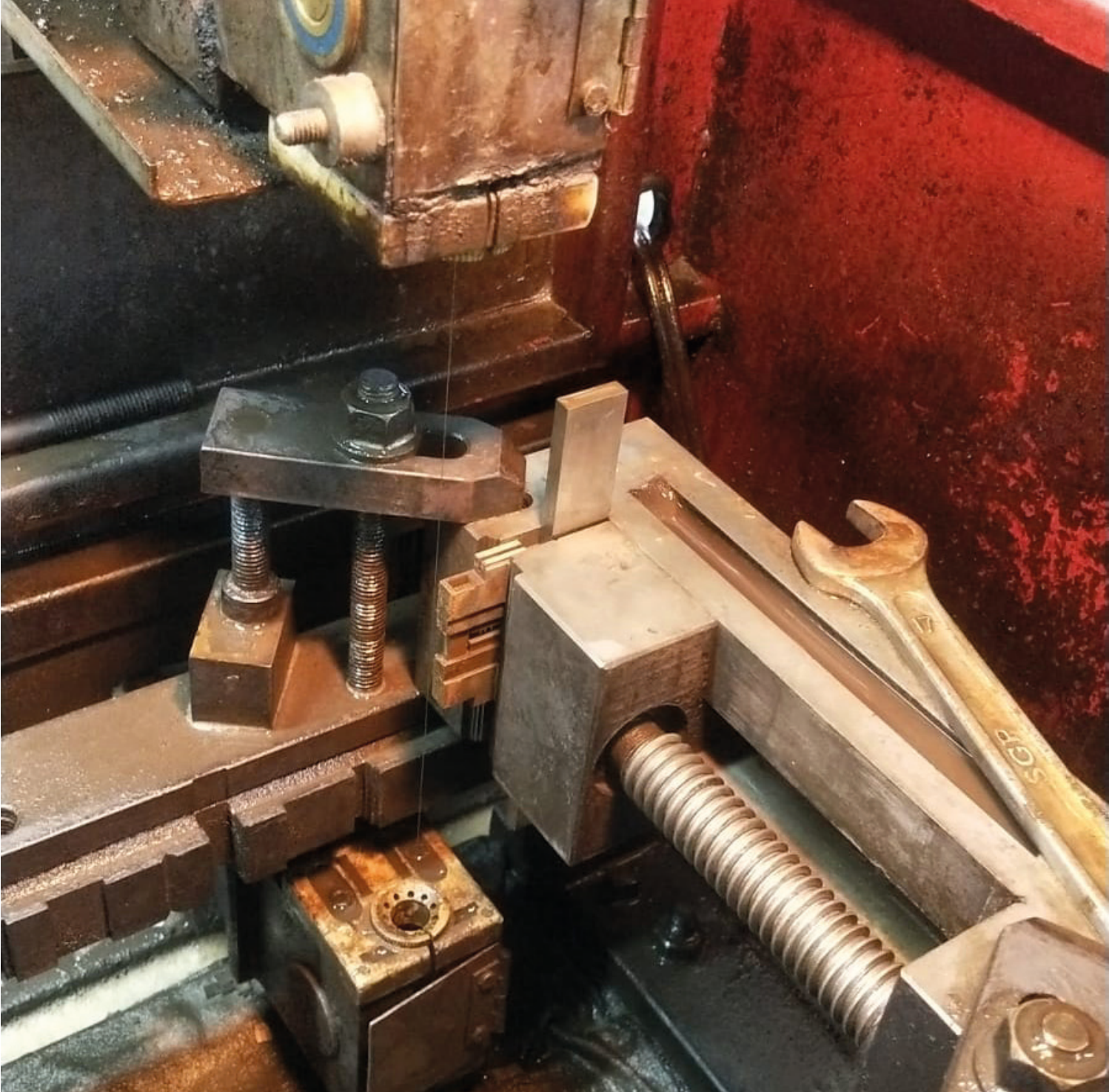
Görsel 6.44: Alıştırma yüzeyli kalıbın tel erezyon tezgâhında kesilmesi
