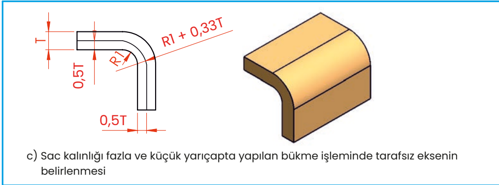
Görsel 2.3.c: Bükme olayı gerçekleşirken sac kalınlığı ve bükme yarıçapına göre tarafsız eksenin belirlenmesi
