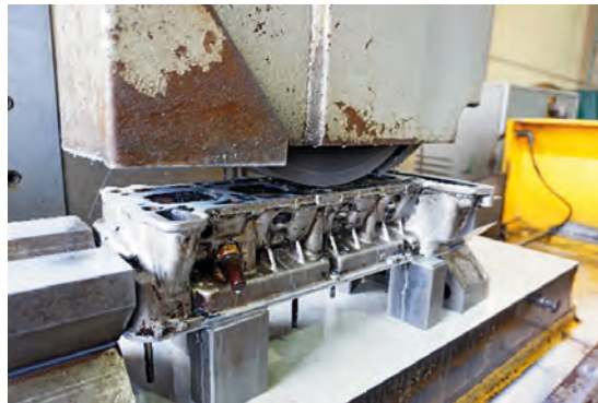
Görsel 3.20: Bağlama kalıplarıyla tablaya iş parçasının bağlanması
