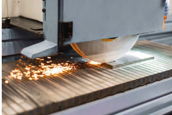
Görsel 3.17: Mıknatıslı tablaya işin bağlanması
