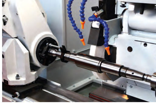
Görsel 3.30: İş parçasının iki punta arasında taşlanması
