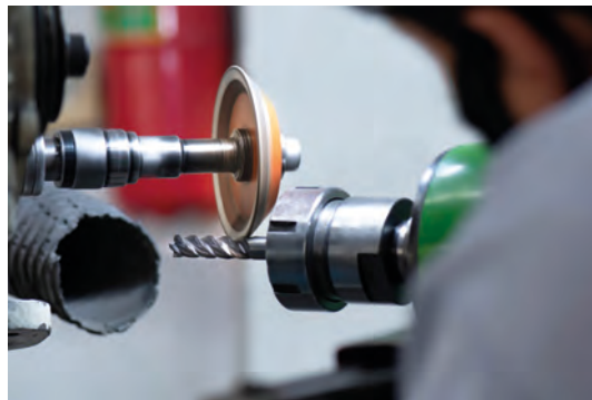
Görsel 3.32: İş parçasının penslere bağlanarak taşlanması
