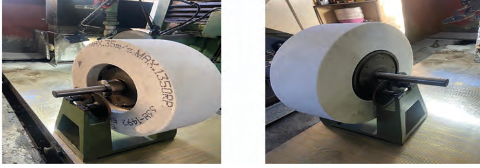
Görsel 3.12: Dengeleme aparatı ve dengeleme işleminin yapılışı
