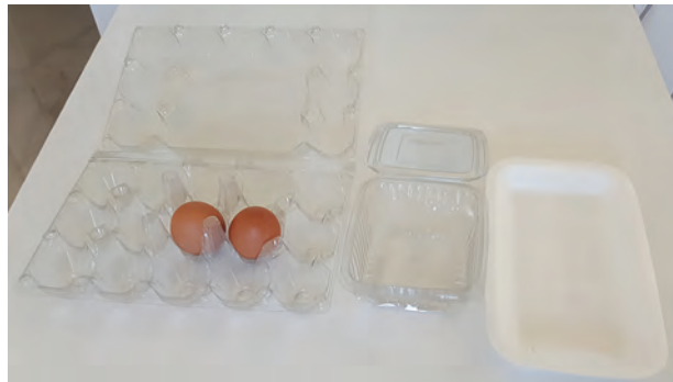
Görsel 1.5: Vakum kalıbında üretilen ürünlerden bazıları
