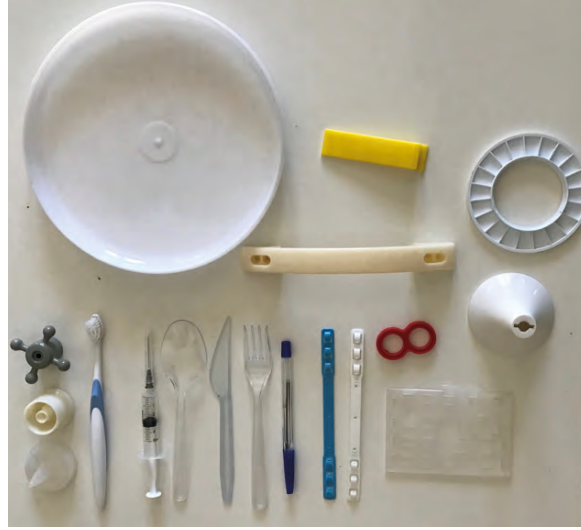
Görsel 1.3: Plastik enjeksiyon kalıbında üretilen ürünlerden bazıları
