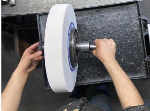
Görsel 3.15: Montajın tamamlanması
