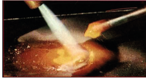
Asetileni fazla (karbürleyici) alev, daha karışıklı bir banyo oluşturur.
