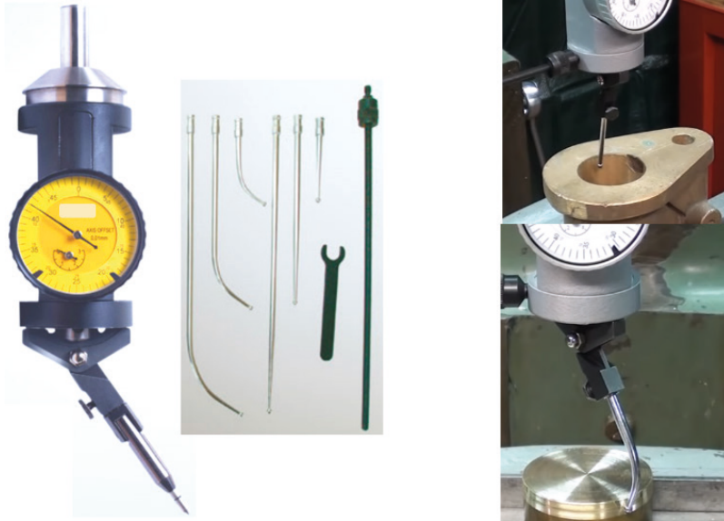
Görsel 3.5: Mekanik merkezleme saati (3D algılama probu)
