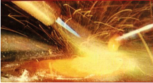
Oksijeni fazla (oksitleyici) alev, erimiş kaynak banyosunun üzerinde bir köpük oluşturur ve daha fazla kıvılcım çıkarır.
