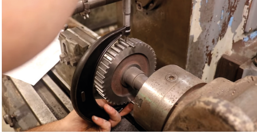
Görsel 4.8: Silindirik çubuk master ve mikrometreyle dişli kontrolü
