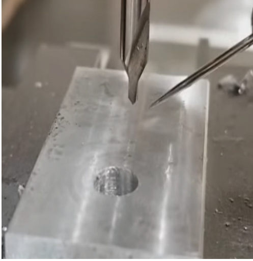
Görsel 3.14: Punta matkabı ve normal matkapla ikinci delme işlemi
