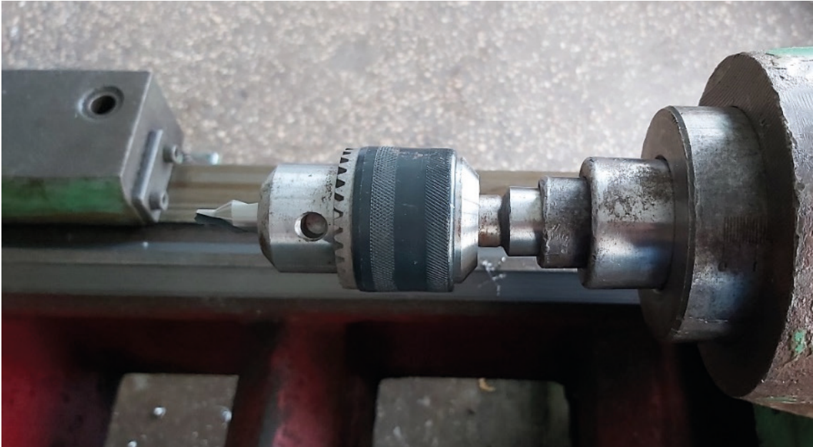
Görsel 1.5: Punta matkabı mandren ve gezer punta bağlantısı
