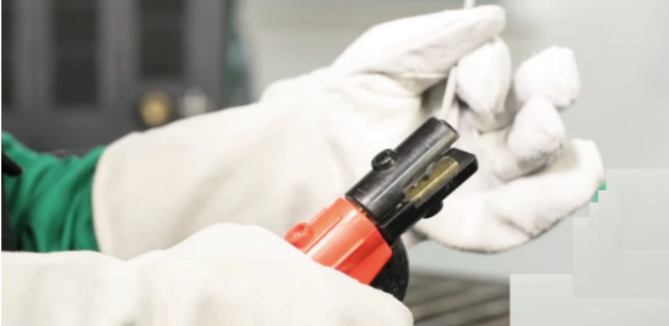
Görsel 6.7: Kaynak pensesine elektrotun bağlanması
