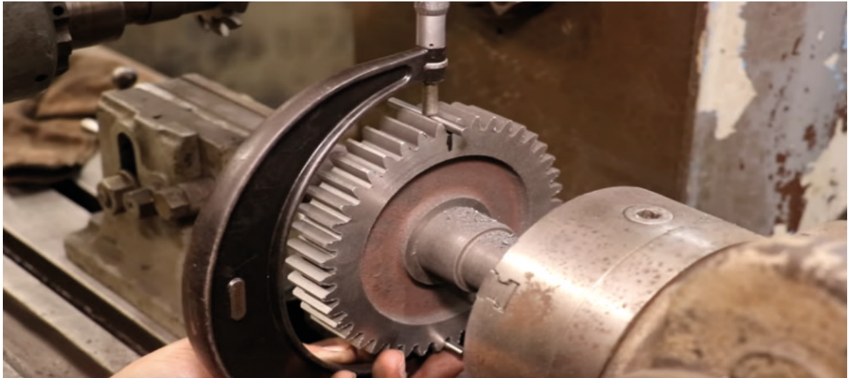
Görsel 4.9: Silindirik çubuk master ve mikrometreyle son dişli kontrolü
