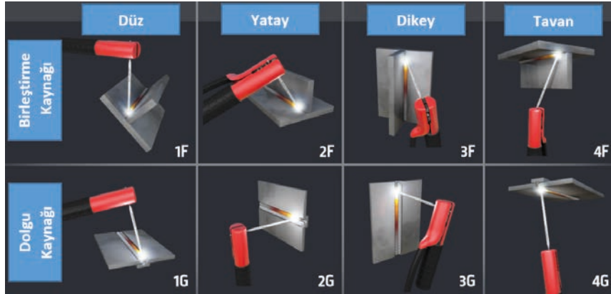
Şekil 6.6: ISO Birleştirme ve dolgu kaynağı isim ve numaraları
