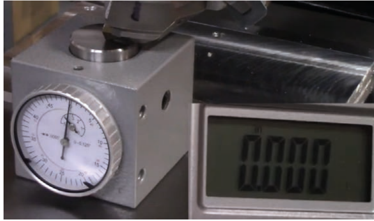
Görsel 3.16: Z eksenı ve dijital ekran sıfırlama işlemi
