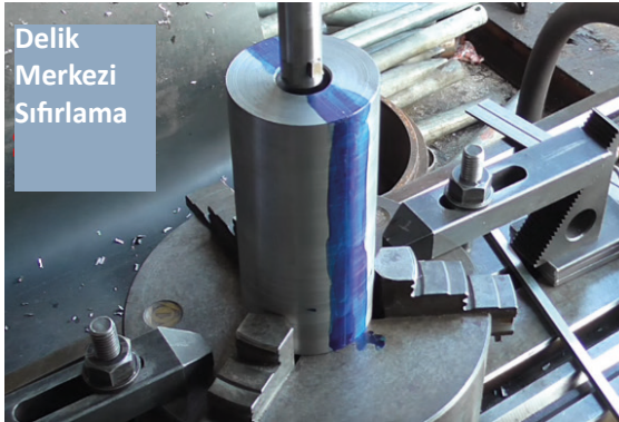
Görsel 3.19: Delik sıfırlama ve kontrol işlemi
