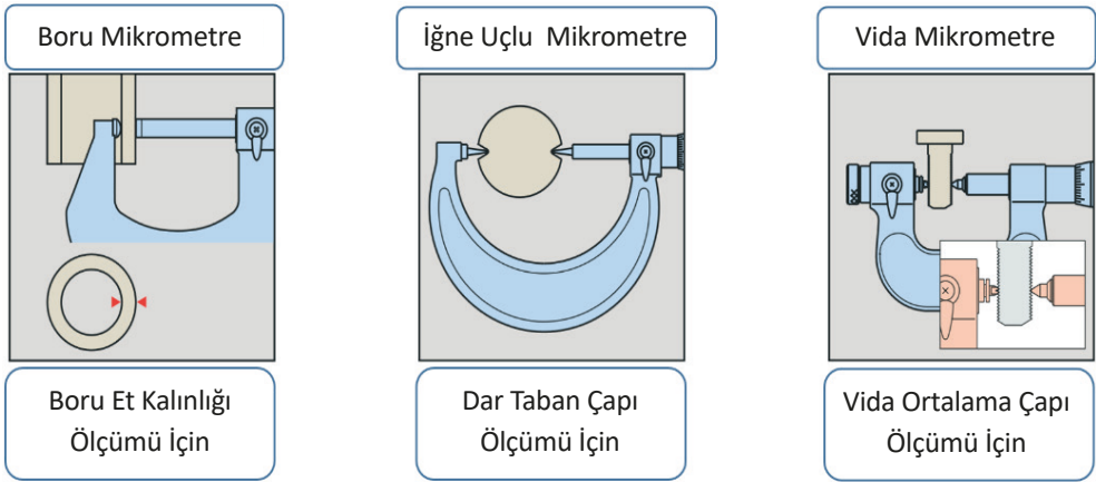
Şekil 1.54: Özel amaçlı mikrometre uygulamaları
