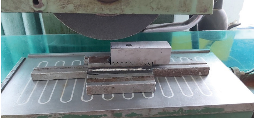
Görsel 5.15: Yüksek boylu iş parçasının desteklenerek bağlanması
