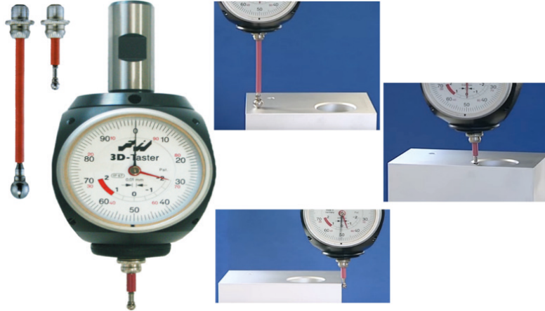
Görsel 3.4: 3D algılama probu ve sıfırlama konumları
