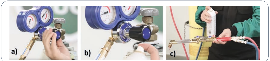
Görsel 7.4: Hamlaç ve regülatör kısmının gaz kontrolü
