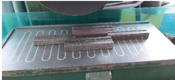
Görsel 5.14: Yapışma yüzeyi az olan iş parçasının destelenmesi
