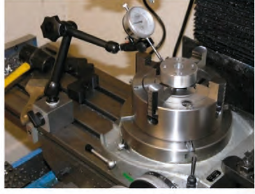
Görsel 7.10: Döner tabla ekseninin ve parça ekseninin komparatör ile kontrolü
