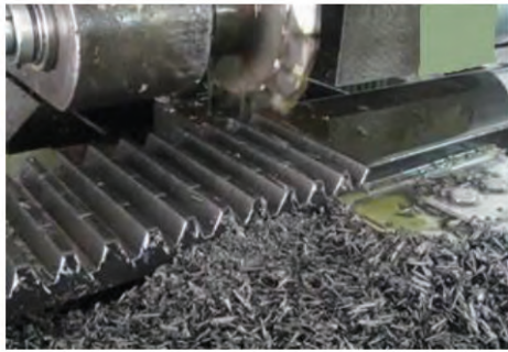
Görsel 7.36: Kremayer dişli açma işlemleri
