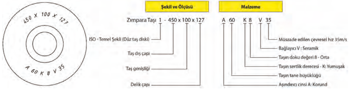
Görsel 8.3: Zımpara taşının etiketlenmesi
