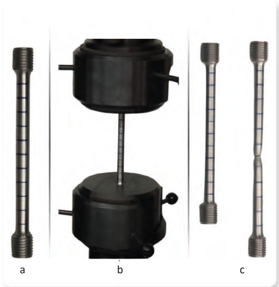
Görsel 2.7: Çekme testi aşamaları
