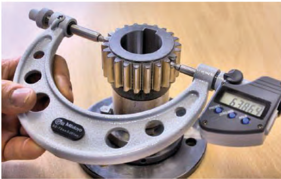
Görsel 7.29: Diş dibi çapının ve adının dijital modül mikrometreleri ile ölçülmesi
