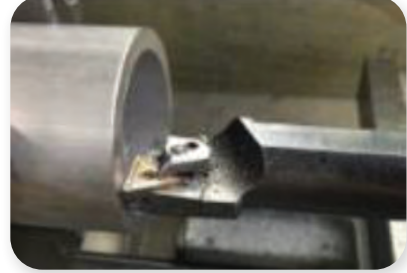
Görsel 4.4: Kalemin parçaya değdirilmesi
