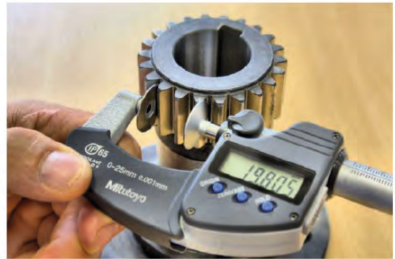
Görsel 7.29: Diş dibi çapının ve adının dijital modül mikrometreleri ile ölçülmesi
