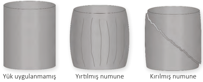
Görsel 2.8: Basma deney aşamaları
