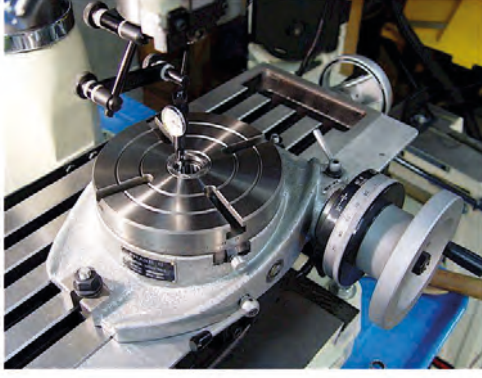
Görsel 7.10: Döner tabla ekseninin ve parça ekseninin komparatör ile kontrolü
