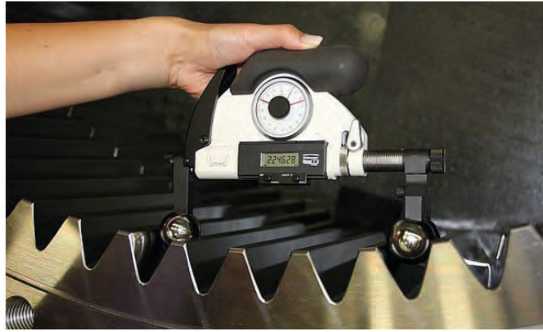
Görsel 7.28: Dişlerin modül kumpası ve özel ölçüm aletleri ile ölçülmesi
