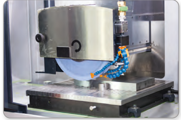
Görsel 8.1: Düzlem yüzey taşlama işlemi
