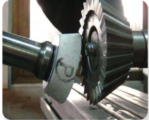
Görsel 9.14: Açılı freze çakısının bilenmesi
