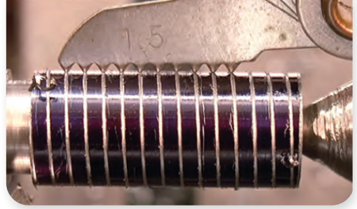
Görsel 3.7: Yüzey boyama ve vida tarağı ile adım kontrolü
