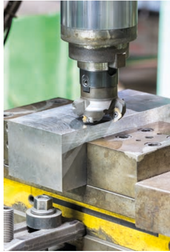
Görsel 1.60: Tabla üzerinde mengene ve ayna bağlanması
