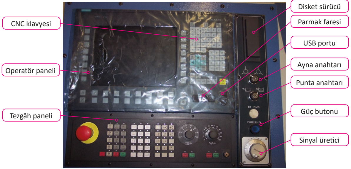
Görsel 1.15: CNC kontrol paneli üzerinde bulunan kısımlar
