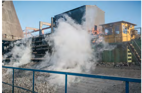
Görsel 3.14: Kok kamarasından çıkan kömürün basınçlı su ile söndürülmesi
