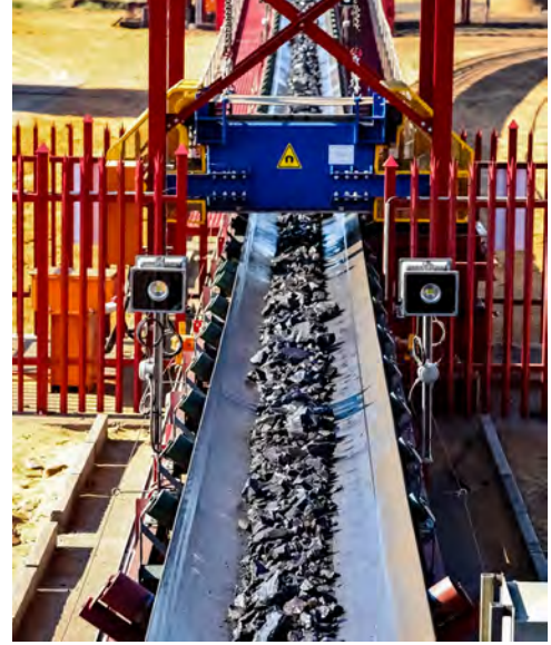
Görsel 4.16: Konveyör bant sistemi ile cevher nakli
