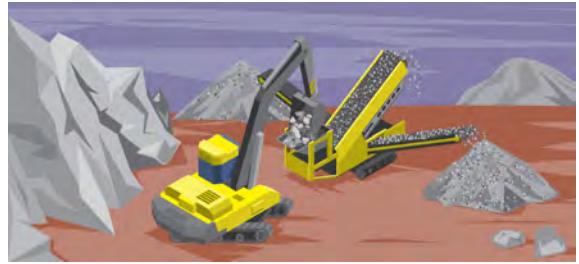
Görsel 4.14: Cevherin kırılması ve tane boyutlarına ayrılması
