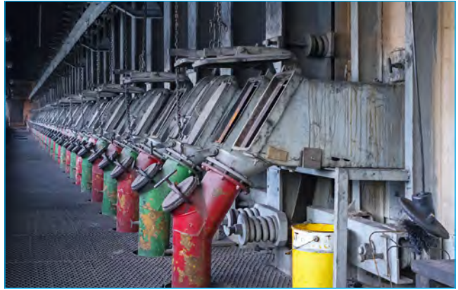
Görsel 3.8: Kok bataryası üzerindeki gaz dağıtım kanalındaki baca gazı kutusu
