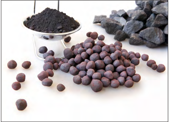
Görsel 4.19: Cevherin taş, öğütülmüş ve peletlenmiş halleri
