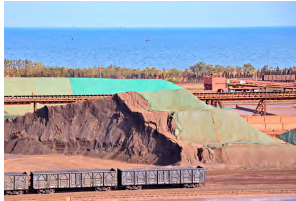
Görsel 4.11: Cevherin stok sahasına yığınlar halinde stoklanması
