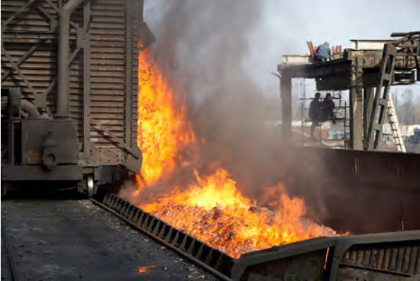
Görsel 3.4: Yanmış kok kömürünün söndürme arabasına alınması
