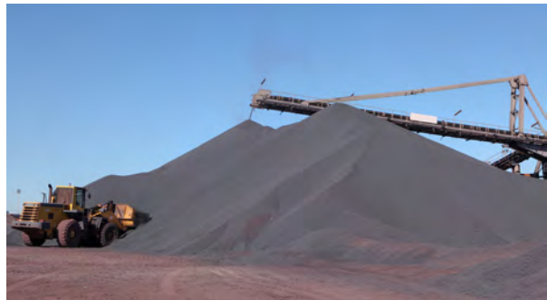
Görsel 4.12: Cevherin konveyör bant sistemi ile yığınlar halinde stoklanması
