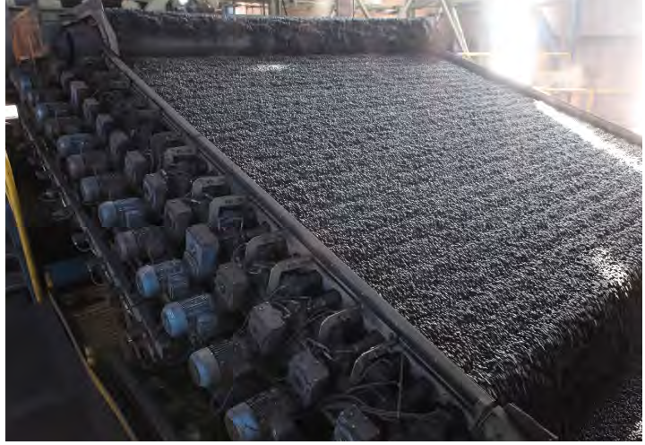
Görsel 4.18: Demir cevheri rulolu besleyici ile peletleme
