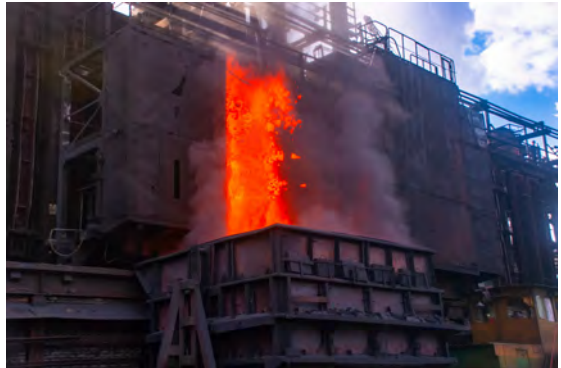
Görsel 3.13: Koklaşan kömür zaman kaybetmeden söndürme ünitesine taşınır
