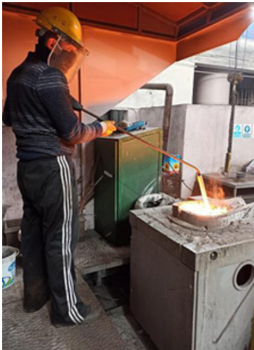
Görsel 10.2: Daldırılmalı pirometre uygulaması
