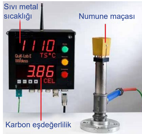
Görsel 10.17: Dökme demir için karbon-silis analiz cihazı
