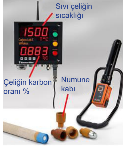
Görsel 10.18: Çelik için karbon analiz cihazı
