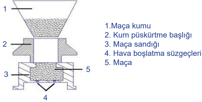
Görsel 5.8: Kumun püskürtülerek doldurulması
