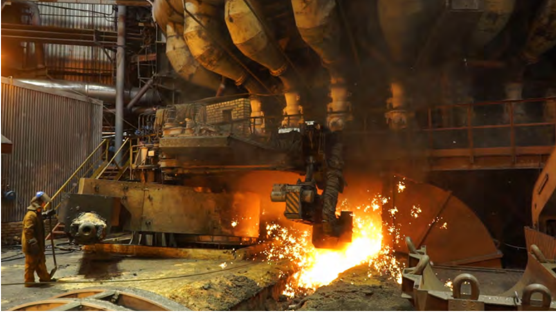
Görsel 10.5: Yüksek fırın akış ağızı açma ve sıvı ham demirin potaya taşınması
