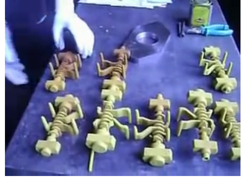
Görsel 5.5: Makinede sıcak kutu yöntemi ile üretilmiş maçalar
