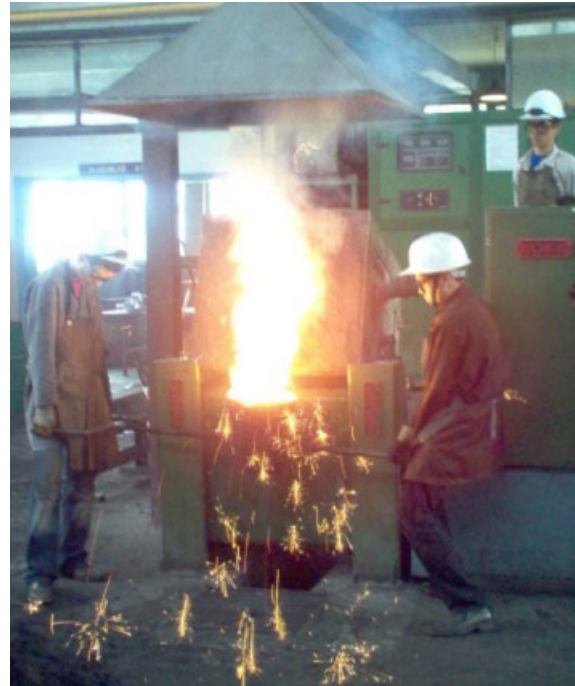
Görsel 8.7: Ocakta ergitilmiş metalin taşıma potasına alınması
