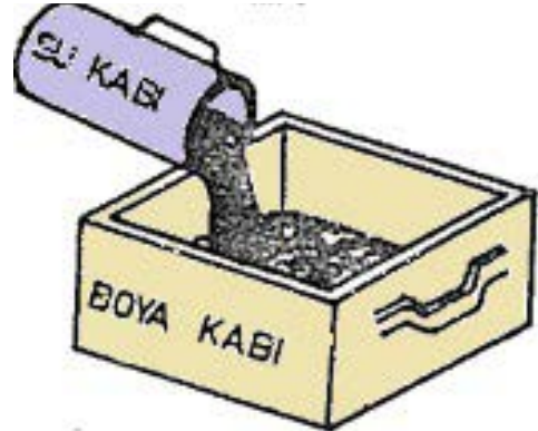
Görsel 1.8: Maça boyası hazırlamada su katma işlemi
