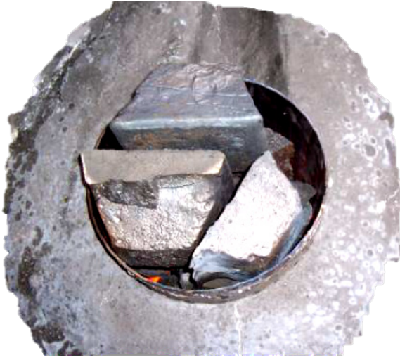
Görsel 8.6: Ocak potasına katı metali yüklenmesi
