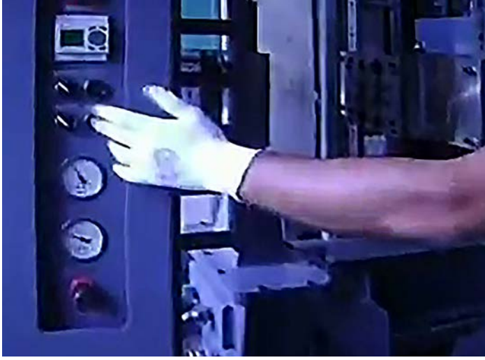
Görsel 5.1: Sıcak kutu maça yapma makinesi
