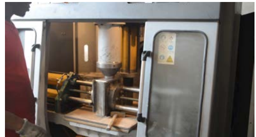
Görsel 5.8: Maça sandığına karbondioksit gazı basılması
