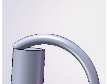
Görsel 6.12: Piston modeli ve boynuz yolluk uygulaması
