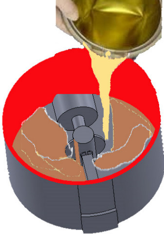
Görsel 2.1: Karıştırıcıya sıvı reçine ilave edilmesi
