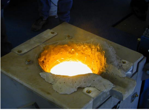
Görsel 8.4: Endüksiyon ocağında ergitme
