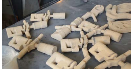
Görsel 5.10: Maça yapma makinesinde soğuk kutu yöntemi ile yapılmış maçalar
