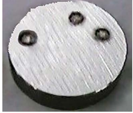
Görsel 10.6: Yanmış numune
