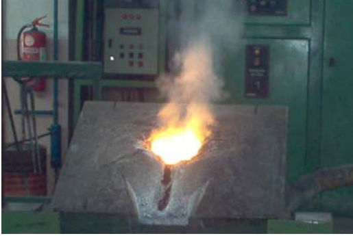
Görsel 9.2: Endüksiyon ocağında döküm sıcaklığına gelmiş sıvı metal
