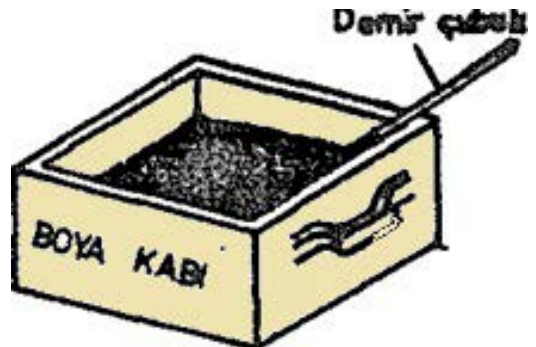
Görsel 1.9: Boyanın demir çubukla karıştırılması
