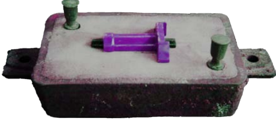
Görsel 9.1: Yatık modelli kalıp
