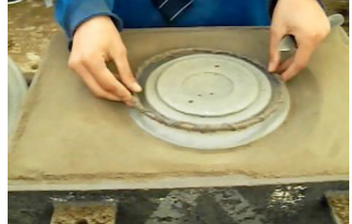
Görsel 6.3: Çevirme maçaya uygun iskelet hazırlama
