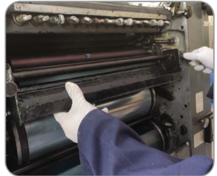
Görsel 5.65: Temizleme raglesinin sökülmesi
