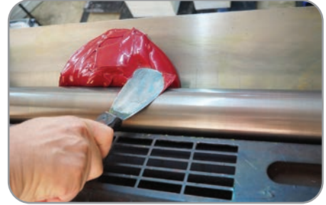
Görsel 3.13: Hazneye mürekkep verilmesi
