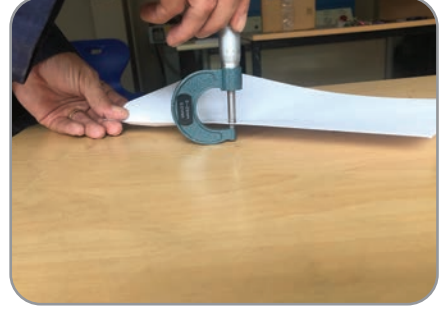
Görsel 5.48: Kâğıt kalınlığının ölçülmesi
