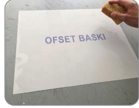
Görsel 2.15: Zambkın sürülmesi
