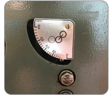
Görsel 5.3: Baskı kazanı basınç ayarı
