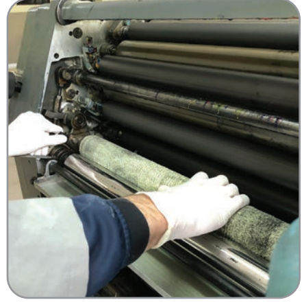
Görsel 5.63: Nemlendirme merdanelerinin sökülmesi
