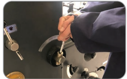
Görsel 5.43: Nemlendirme merdanelerinin kalıba temas ettirilmesi
