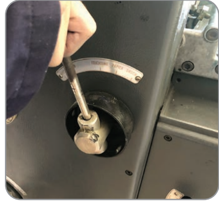
Görsel 6.25: Nemlendirme merdanelerinin kalıba temas ettirilmesi
