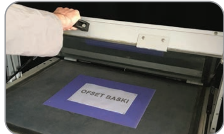
Görsel 2.6: Kalıbın şaseye yerleştirilmesi
