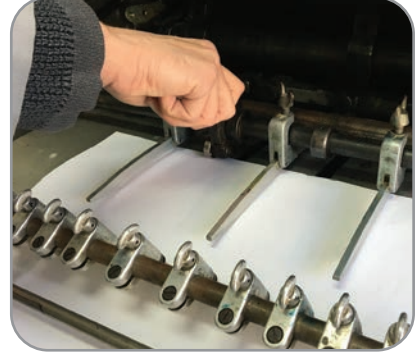
Görsel 4.29: Kontak tertibatının açılması
