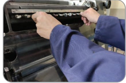
Görsel 5.8: Mürekkep hazne ayarının yapılması
