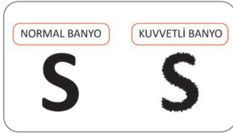
Şekil 2.10: Kuvvetli banyo sonucu görüntü
