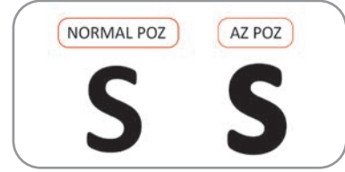
Şekil 2.8: Az poz sonucu şişme oluşması
