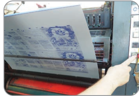
Görsel 3.11: Kalıbın makas yönünden takılması
