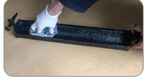
Görsel 5.58: Mürekkep raglesinin temizlenmesi
