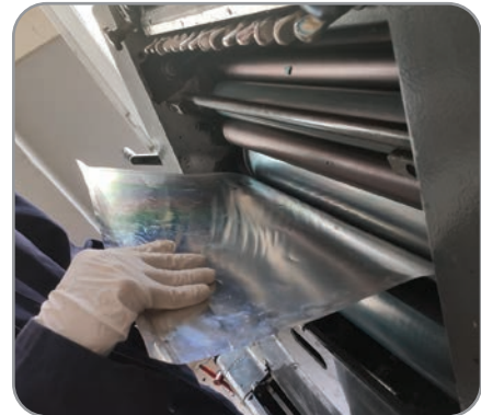
Görsel 5.62: Kalıbın sökülmesi
