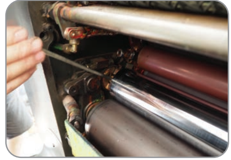
Görsel 3.20: Merdanelerin yuvalarına takılması
