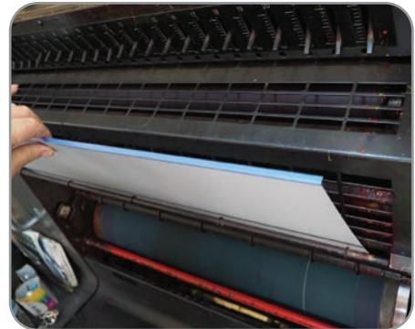
Görsel 3.18: Kalıbın takılması
