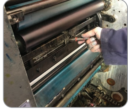
Görsel 6.1: Kalıbın takılması
