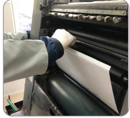
Görsel 3.2: Kalıbın takılması
