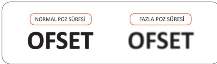
Şekil 2.7: Fazla poz sonucu incelme oluşması
