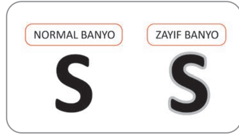
Şekil 2.11: Zayıf banyo sonucu görüntü
