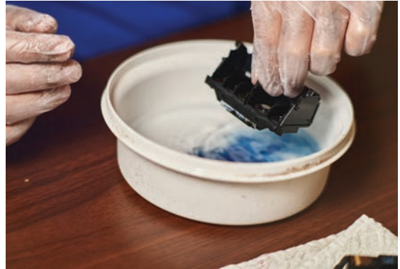
Görsel 2.40: Daldırma yöntemiyle kafa temizliği
