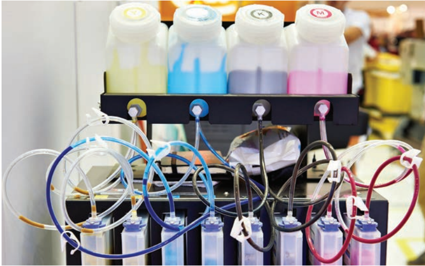
Görsel 2.24: Bidon mürekkep sistemi
