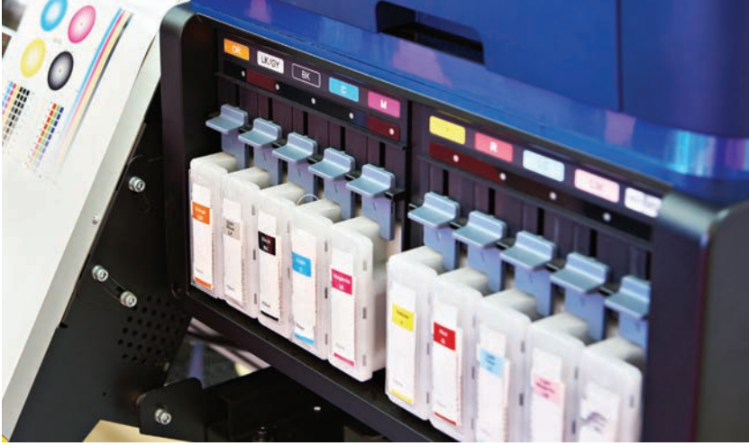
Görsel 2.23: Kaset mürekkep sistemi
