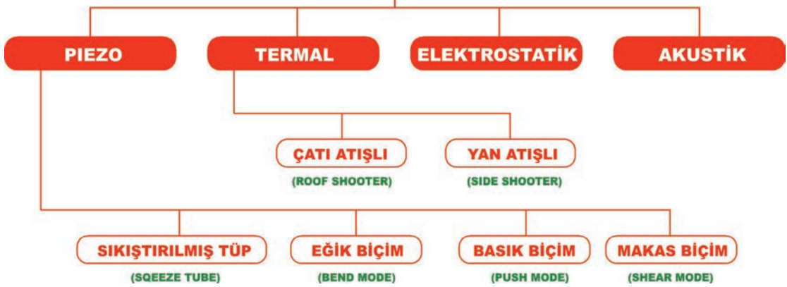
Görsel 1.13: Ink-jet baskı (püskürtme) teknolojileri
