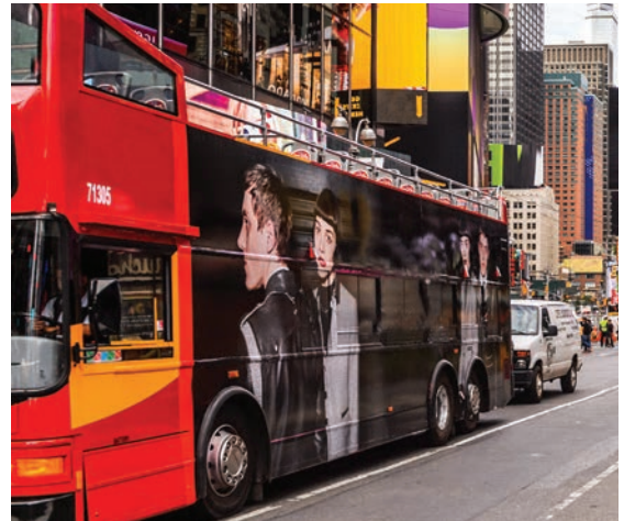
Görsel 4.56: Camlarında one way vision kullanılmış otobüs
