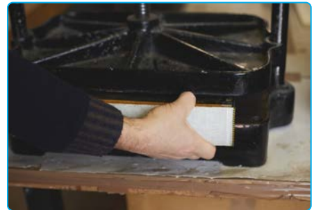
Görsel 2.25: Sırtına tela yapıştırılmış bir iç blok
