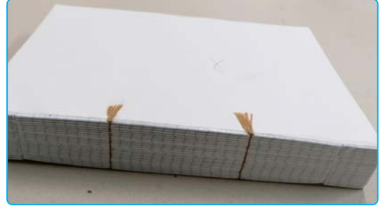
Görsel 2.4: Püsküllerin yapıştırılması
