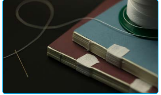
Görsel 1.13: Ekstraforla birleştirilmiş bir cilt
