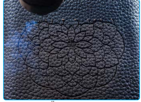
Görsel 4.37: Üzerine lazer baskı uygulanmış sert kapak
