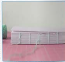
Görsel 1.2: İplik dikme yöntemiyle iç blok birleştirme
