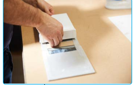
Görsel 3.27: İç blokla sert kapağın birleştirilmesi
