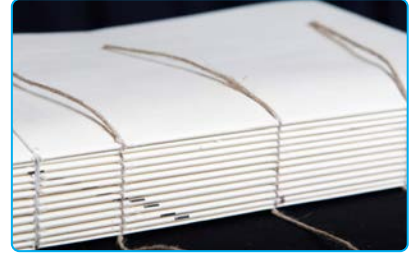
Görsel 1.19: Sicimle çentik dikişle birleştirilmiş bir cilt
