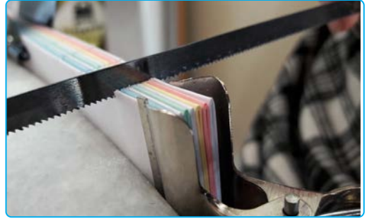
Görsel 1.17: Formalara testere ile çentik açılması
