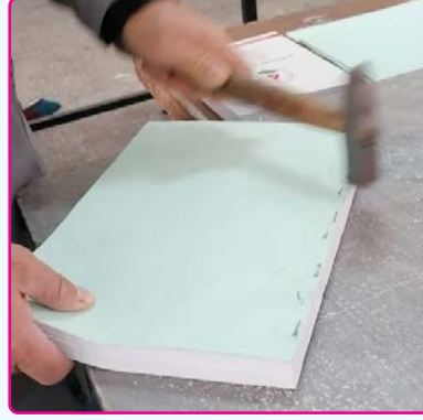
Görsel 1.69: Tellerin çekiçle düzeltilmesi
