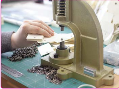
Görsel 3.60: Malzemenin kuşgözünün üzerine yerleştirilmesi
