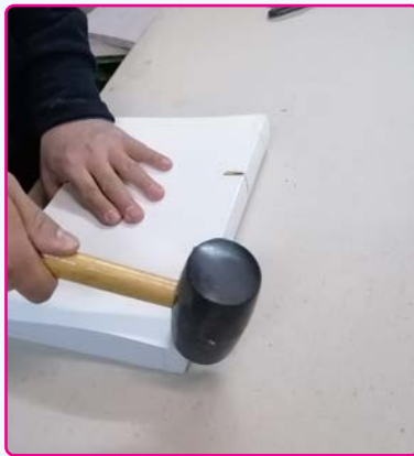
Görsel 2.17: İç bloğun ağız kısmına doğru çekilmesi
