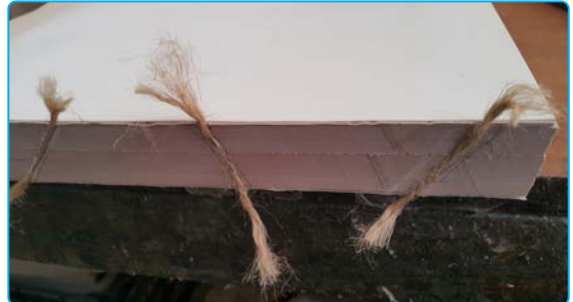
Görsel 1.54: Sicimlerin çentiklere yerleştirilmesi
