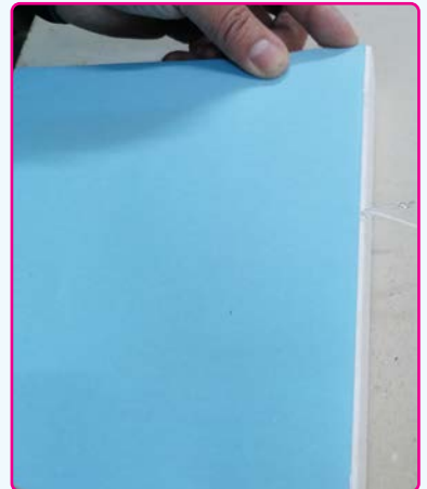
Görsel 2.13: Yan kâğıdın iç bloğa yapıştırılması
