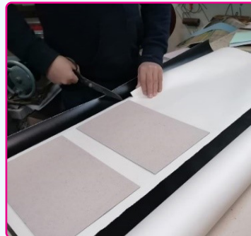
Görsel 3.30: Kaplama malzemesinin kesilmesi
