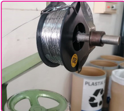
Görsel 1.66: Makineye zimba telinin takılması
