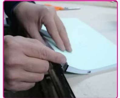
Görsel 2.28: Şirazenin yapıştırılması
