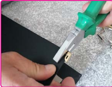
Görsel 4.42: Köşebenti pense ile sıkıştırma
