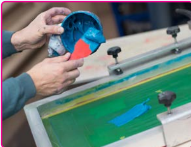
Görsel 4.35: Mürekkebin dökülmesi
