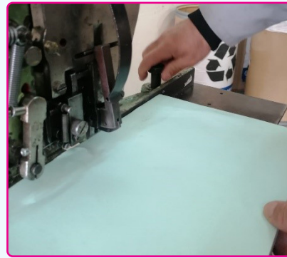
Görsel 1.67: Kâğıt bloğunun makineye yerleştirilmesi
