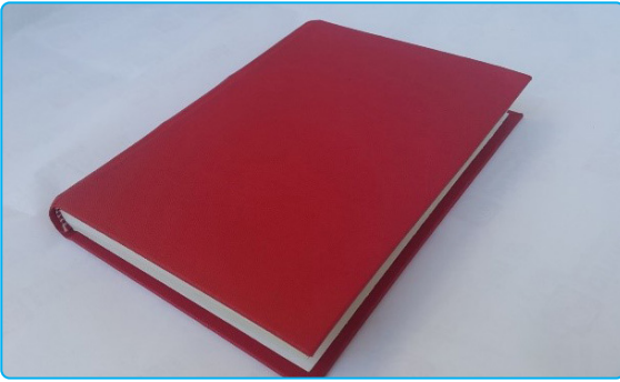
Görsel 3.6: Cilt bezi ile kaplanmış sert kapak örneği
