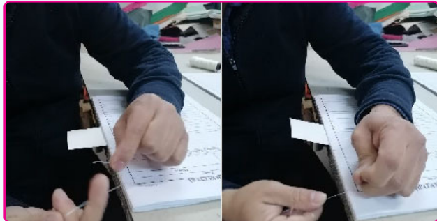
Görsel 1.29: Birinci ve ikinci formanın birbirine bağlanması
