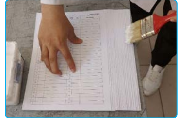
Görsel 6.20: Sırtı elle açarak tutkal sürme
