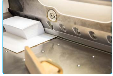
Görsel 2.7: Giyotin ile kesim işlemi
