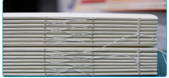
Görsel 1.27: Çapraz dikişle birleştirilmiş bir cilt
