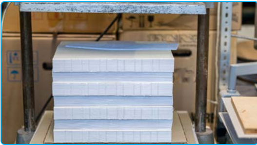
Görsel 2.5: Sırtı tutkallanan iç blokların prese konulması
