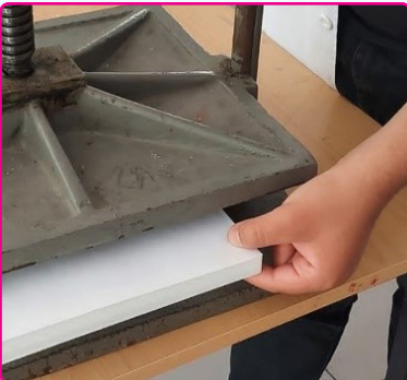
Görsel 6.21: Kâğıt bloğunun prese yerleştirilmesi
