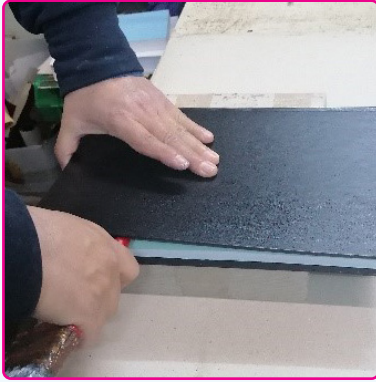
Görsel 3.52: Kapağın iç blok üzerine yapıştırılması
