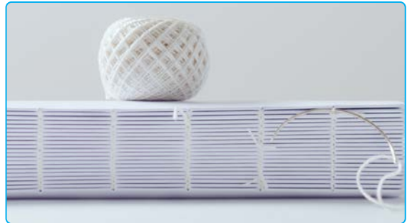
Görsel 1.25: Zincir dikişle birleştirilmiş bir cilt
