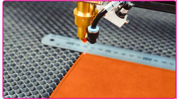
Görsel 4.39: Sert kapağın makine üzerine yerleştirilmesi
