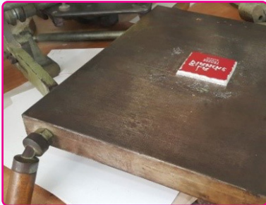
Görsel 4.21: Klişenin kalıp yüzeyine yerleştirilmesi
