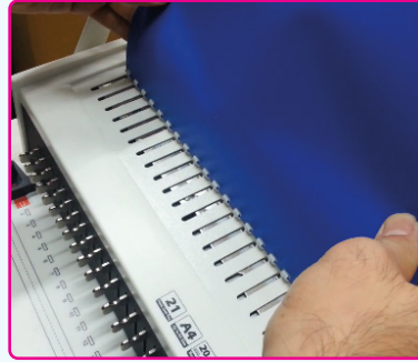
Görsel 6.15: Sayfaların spirale geçirilmesi
