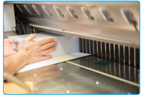
Görsel 5.4: Giyotin ile kesim
