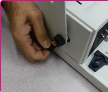
Görsel 6.10: Deliklerin sırta olan uzaklığının ayarlanması
