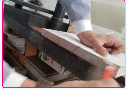
Görsel 1.57: Sicim geçirilmiş kâğıt bloğunun tutkallanması
