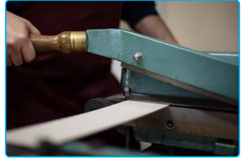
Görsel 3.13: Mukavvanın mukavva makası ile kesilmesi
