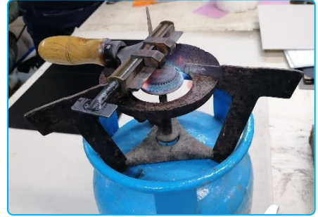
Görsel 4.8: Kumpasın ısıtılması
