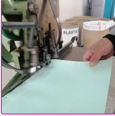
Görsel 1.68: Kâğıt bloğunun tel ile birleştirilmesi
