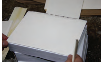
Görsel 5.34: İkinci yan kâğıdın yapıştırılması
