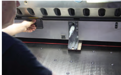
Görsel 1.36: Yeni bıçağı yerleştirme
