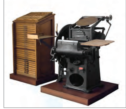
Görsel 7.4: Maşalı tipo baskı makinesi
