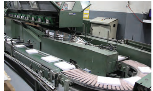
Görsel 3.10: Çok üniteli sıcak tutkallı kapak takma makinesi
