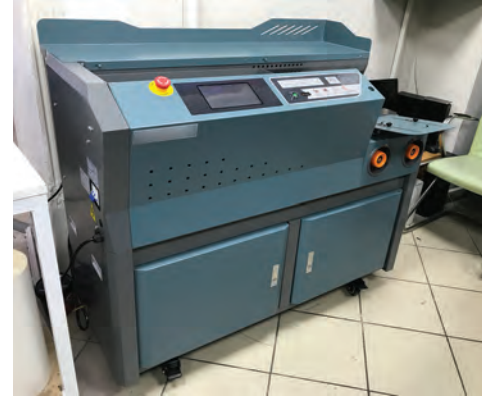
Görsel 3.9: Tek üniteli sıcak tutkallı kapak takma makinesi
