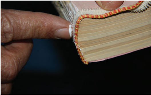
Görsel 5.55: Etek kısmına şiraze yapıştırılması
