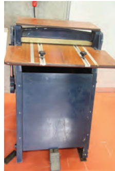
Görsel 2.2: Yarı otomatik (pedallı) piliyaj-perforaj makinesi
