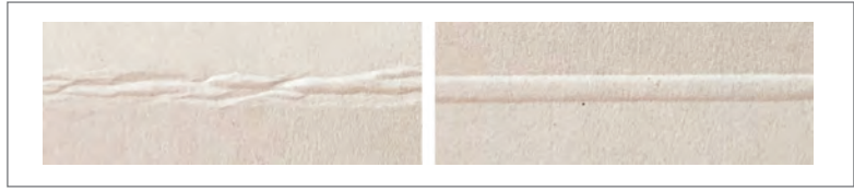
Görsel 2.1: Piliyaj işlemi yapılmadan katlanan kartonun (soldaki) ve piliyaj işlemi yapılarak katlanan kartonun (sağdaki) mikroskobik görüntüsü
