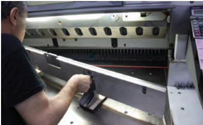
Görsel 1.35: Lama bağlama aparatı
