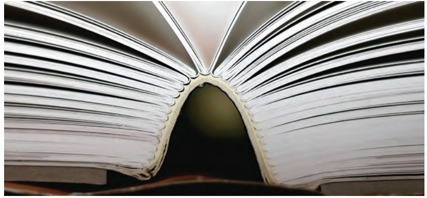
Görsel 4.1: Formalardan oluşan iç blok
