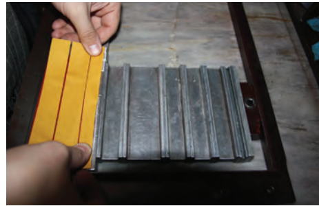
Görsel 7.28: Klişe bandı yapıştırma
