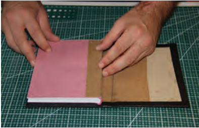
Görsel 6.33: İç bloğun yerleştirilmesi
