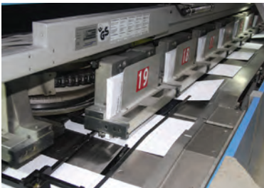
Görsel 3.2: Sıcak eriyik yapıştırıcılar ile kapak takma
