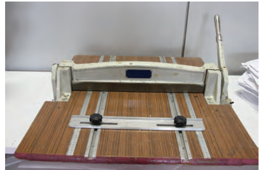
Görsel 2.3: Manuel (kollu) piliyaj-perforaj makinesi
