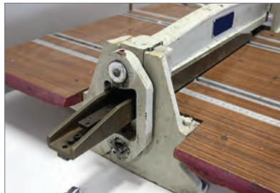
Görsel 2.23: Perforaj kolunu kaldırma
