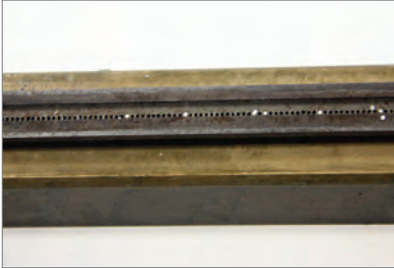
Görsel 2.19: Dişi-erkek perforaj kalıbı
