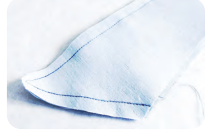
Görsel 2.6: Yakaya makine çekilmesi
