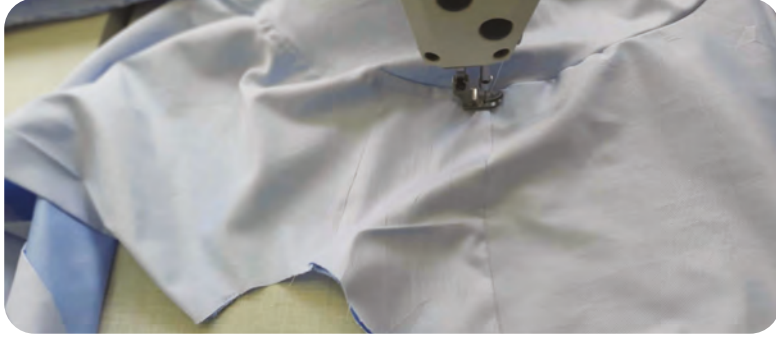
Görsel 2.24: Kolun bedene temiz dikiş tekniği ile takılması
