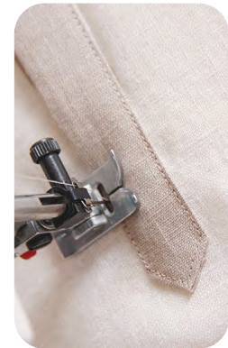
Görsel 2.17: Aparturaya çıma çekilmesi
