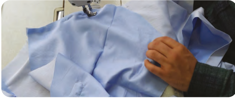
Görsel 2.23: Kolun bedene overlok dikişi ile takılması
