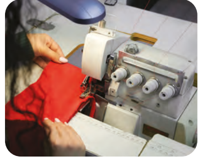
Görsel 1.12: Overlok ile kenar temizleme
