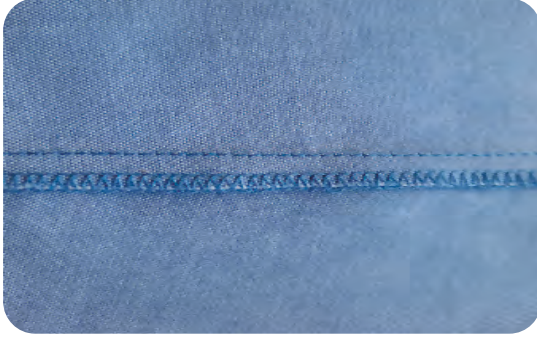
Görsel 4.46: 5 iplik overlok makinesi ile yan dikiş çalışması
