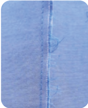
Görsel 4.47: Ters yüzlerin birleştirilmesi
