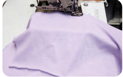
Görsel 3.31: Yanların birleştirilmesi
