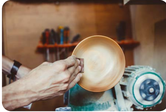
Görsel 5.16: Tornalı parçaların zımparalanması
