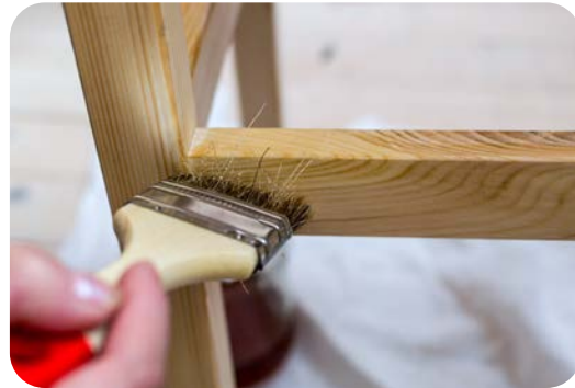
Görsel 5.19: Fazla verniğin fırçadan alınması ve uygulanması
