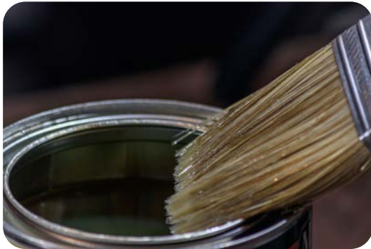
Görsel 5.19: Fazla verniğin fırçadan alınması ve uygulanması
