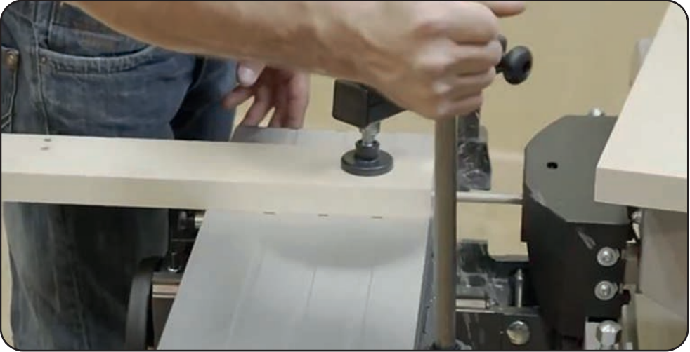
Görsel 2.28: Hareket kolu ve parça sabitleme düzeneği
