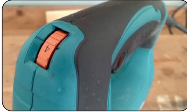
Görsel 3.35: El dekupaj makinesi motor devir ayar volanı
