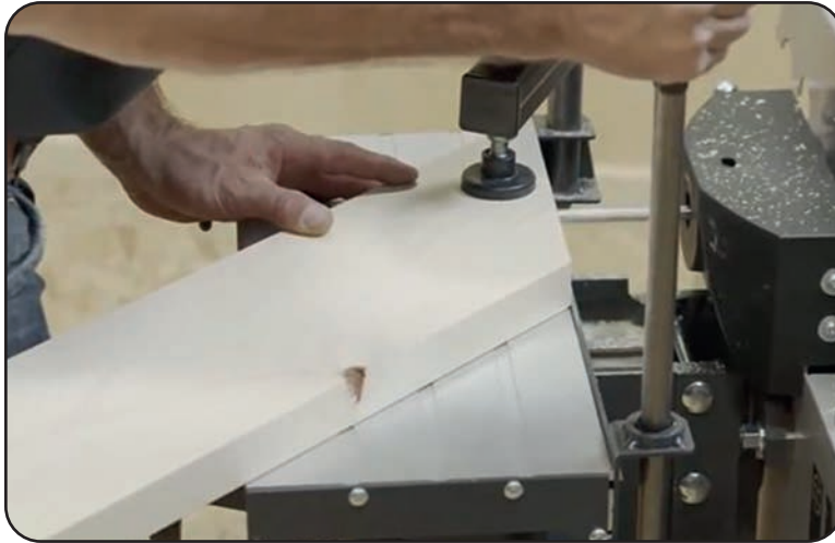
Görsel 2.30: İş parçasının makineye bağlanması
