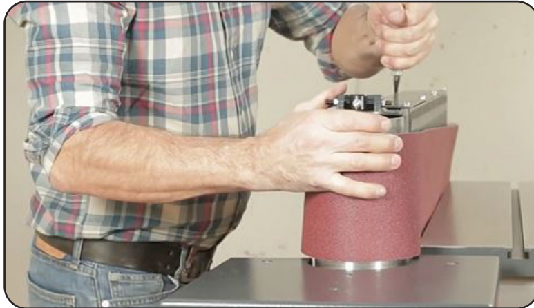
Görsel 4.22: Bant zımparanın gerginlik ayarının yapılması
