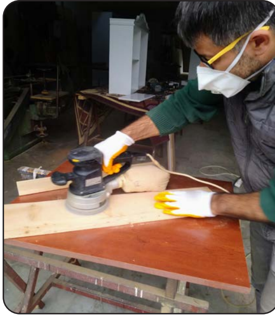
Görsel 3.71: Titreşimli el zımpara makinesi ile ahşap yüzeyin zımparalanması
