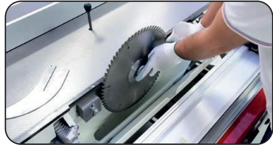
Görsel 1.56: Daire testere makinesi bıçaklarının sökülüp takılması
