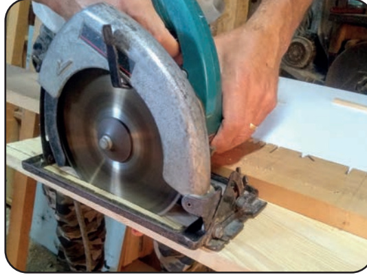
Görsel 3.56: İş parçasını el daire testere makinesi ile mastar kullanarak kesme
