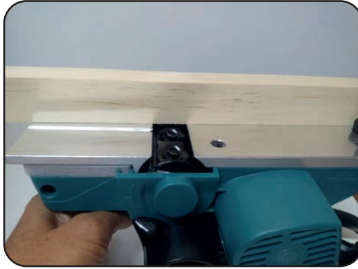
Görsel 3.26: El planya makinesi taban kontrolünün yapılması
