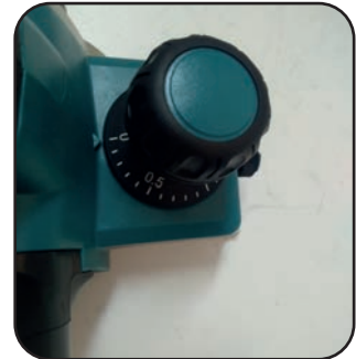
Görsel 3.24: Sıfır konumuna getirilmiş talaş kalınlık ayar kolu
