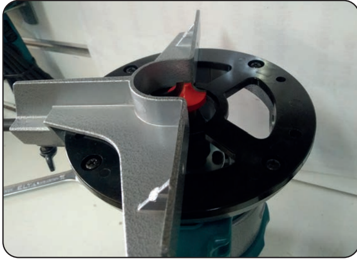
Görsel 3.8: Taban siperi takılmış el freze makinesi
