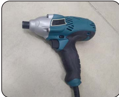
Görsel 3.103: Vidalama amaçlı üretilmiş brey
