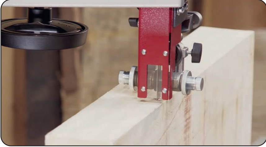
Görsel 1.11: Üst kılavuz düzeninin ayarlanması
