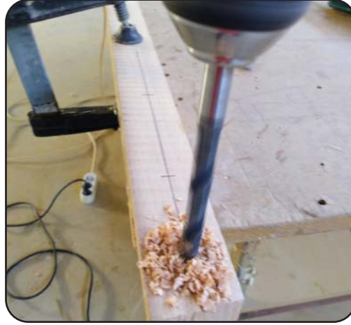
Görsel 3.108: Tezgâha baėlı iř parasına delik delinmesi
