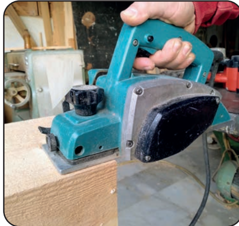
Görsel 3.29: Ön tabanı iş parçası üzerine yerleştirme
