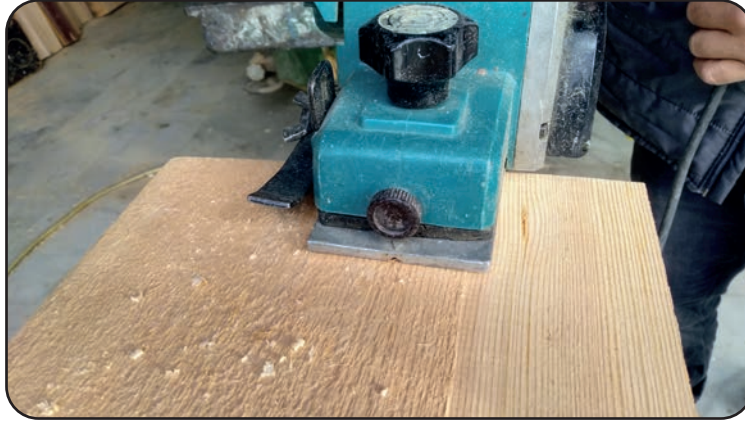
Görsel 3.20: El planya makinesi ile yüzey rendeleme
