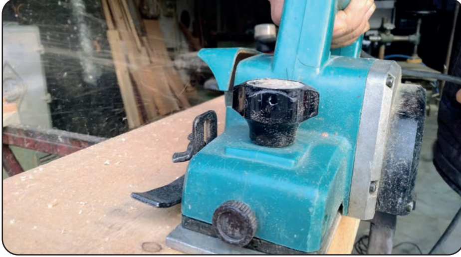
Görsel 3.30: El planya makinesi ile rendeleme yapılması
