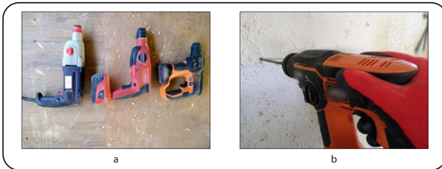
Görsel 3.100: Darbeli el delik makinesi (hilti) çeşitleri ve hilti ile delik delme
