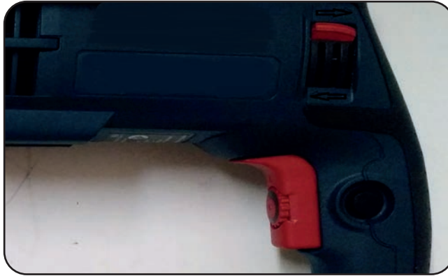
Görsel 3.102: Breylerde ayarlı tetik ve dönüş yönü değiştirme kolu
