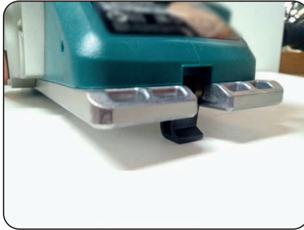
Görsel 3.31: Bıçağın korunması için yükseltme aparatının kullanılması
