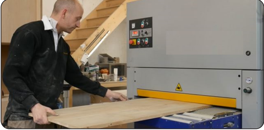
Görsel 4.33: İş parçasının kalibre zımpara makinesine verilmesi
