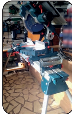
Görsel 3.125: Kendinden tezgâhlı gönyeburun daire testere makinesi
