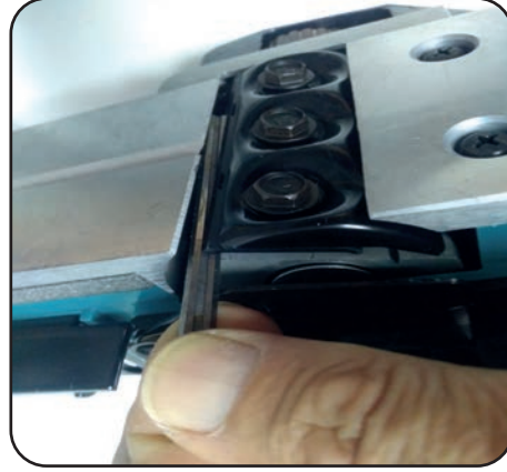
Görsel 3.28: El planya makinesine kullan at bıçağın takılması
