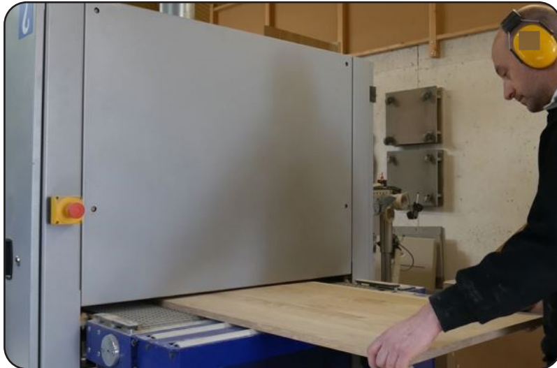
Görsel 4.34: İş parçasının kalibre zımpara makinesinden alınması
