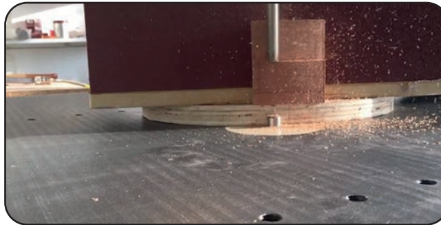
Görsel 2.19: Kalıbın kılavuz pimine dayanarak iş parçasının frezelenmesi
