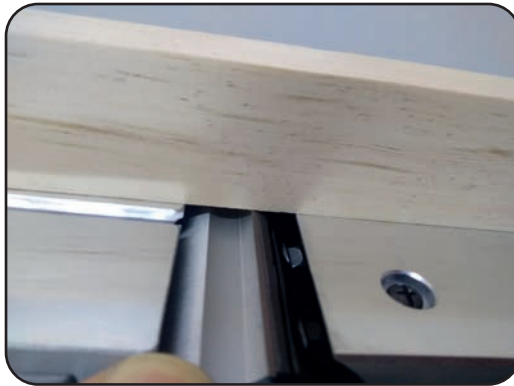
Görsel 3.27: Master yardımıyla bıçak uçuş seviye kontrolü
