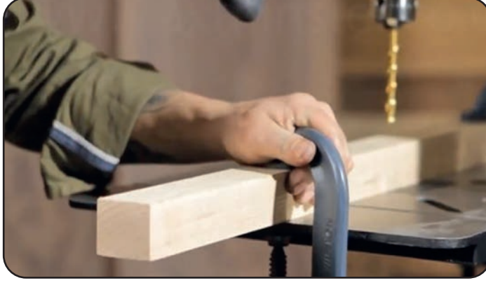
Görsel 2.40: Mengene yardımıyla tablaya bağlanmış iş parçası
