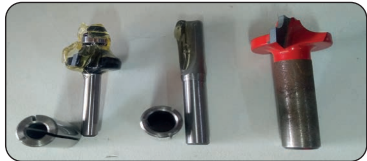
Görsel 3.9: Değişik gövde çapındaki freze bıçakları ve genişletme kapsülleri
