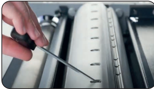
Görsel 1.33: Kalınlık makinesi bıçaklarının sökülüp takılması
