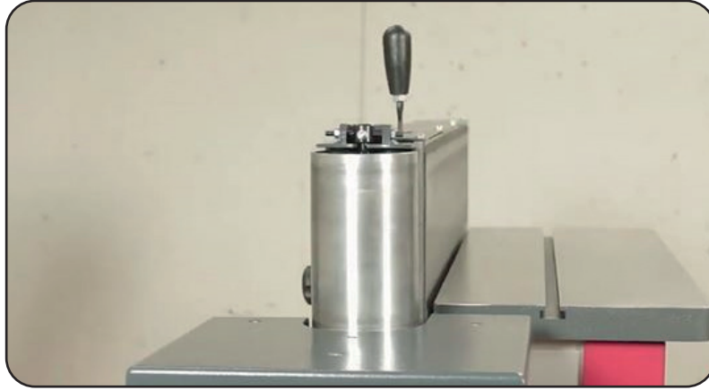
Görsel 4.21: Bant zımparanın takılması
