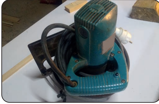
Görsel 3.59: El daire testere makinesi elektrik kablosunun makine üzerine sarılması
