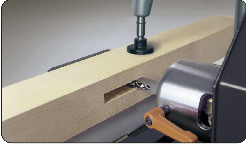
Görsel 2.31: İş parçasının köşeli matkapla delinmesi
