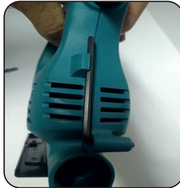
Görsel 3.33: Alyan anahtarının el dekupaj makinesi üzerindeki konumu
