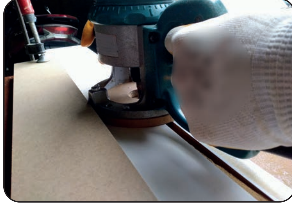
Görsel 3.17: El freze makinesi ile master kullanarak iş parçası yüzeyine kanal açılması
