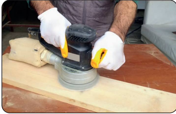
Görsel 3.62: Toz torbası takılı titreşimli el zımpara makinesi ile çalışma
