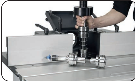
Görsel 2.14: Yatay freze makinesinde kullanılan mil ve bıçaklar
