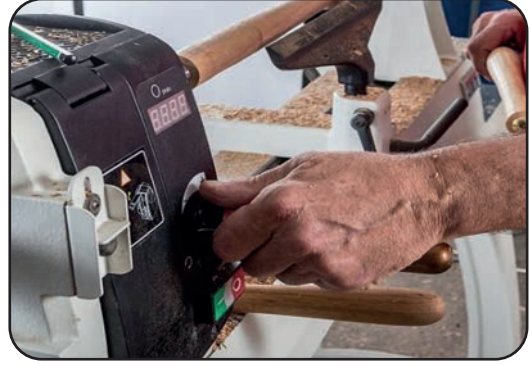
Görsel 2.63: Torna makinesinin dönüş devir hızının ayarlanması
