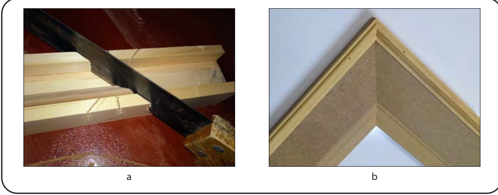
Görsel 3.112: Gönye kutusu ile kesim yapma ve gönyeburun birleştirme
