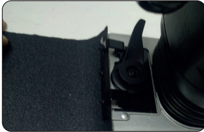
Görsel 3.63: Titreşimli el zımpara makinesi tabanına mandal ile zımpara kağıdının kenarını sabitleme
