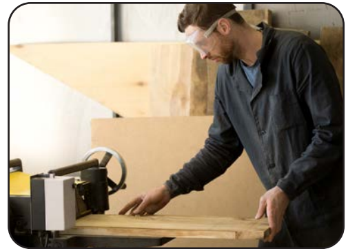
Görsel 1.32: Kalınlık makinesinde çalışma ve iş güvenliği
