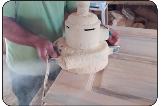
Görsel 3.85: Disk el zımpara makinesi ile kapı kanadı zımparalama
