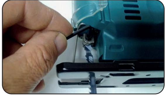
Görsel 3.40: El dekupaj makinesine testerenin takılması
