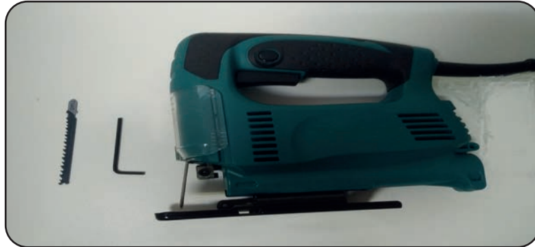
Görsel 3.39: El dekupaj makinesi ile testere laması ve alyan anahtar
