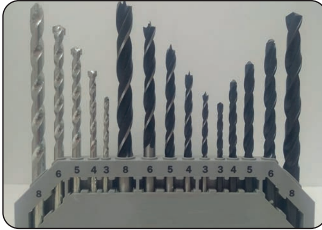
Grsel 3.96: Beton, aēřap ve metal delmek iin kullanılan matkaplar
