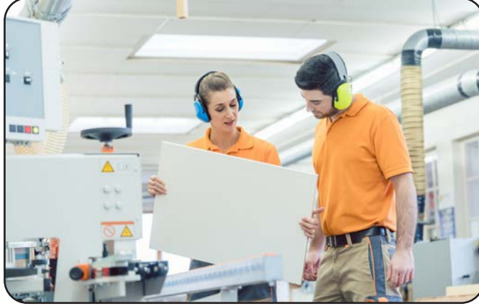
Görsel 5.33: Kenar bantlama makinesine iş parçasının verilmesi
