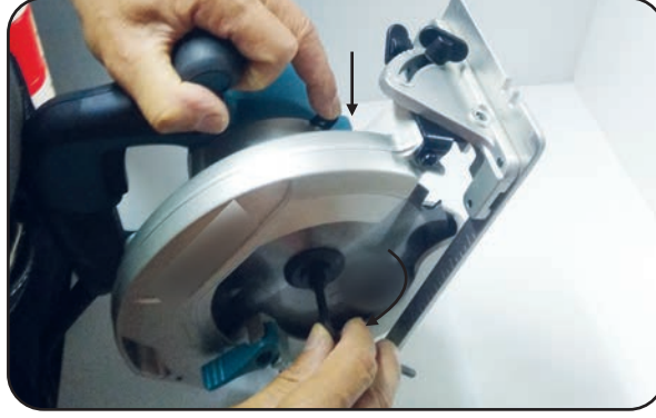
Görsel 3.49: Daire testere makinesi testere laması vidasının sıkılması
