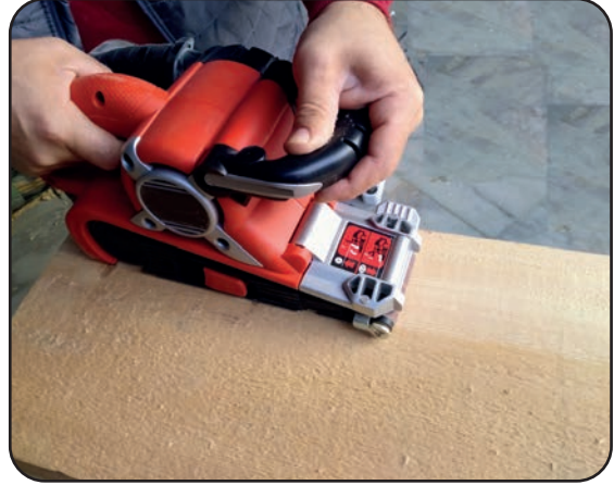
Görsel 3.92: Bant zımpara makinesi ile yüzey zımparalama
