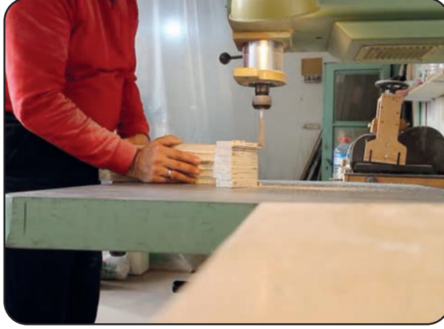
Görsel 2.23: Kılavuz pimi kullanılarak eğmeçli parçanın işlenmesi
