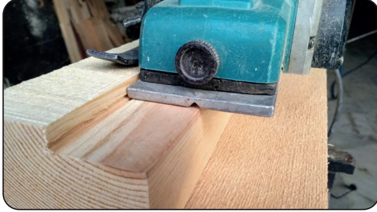
Görsel 3.22: El planya makinesi ile lamba açma
