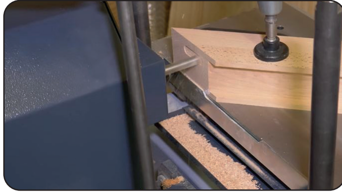
Görsel 2.34: İş parçasına dişi zivana açılması
