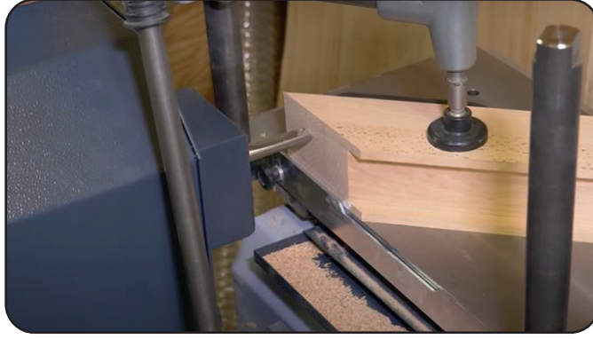
Görsel 2.33: İş parçasının delik merkezinin ayarlanması
