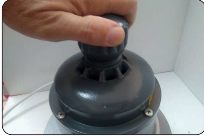
Görsel 3.84: Baskı ayar vidası ile zımpara talaşı ayarlama
