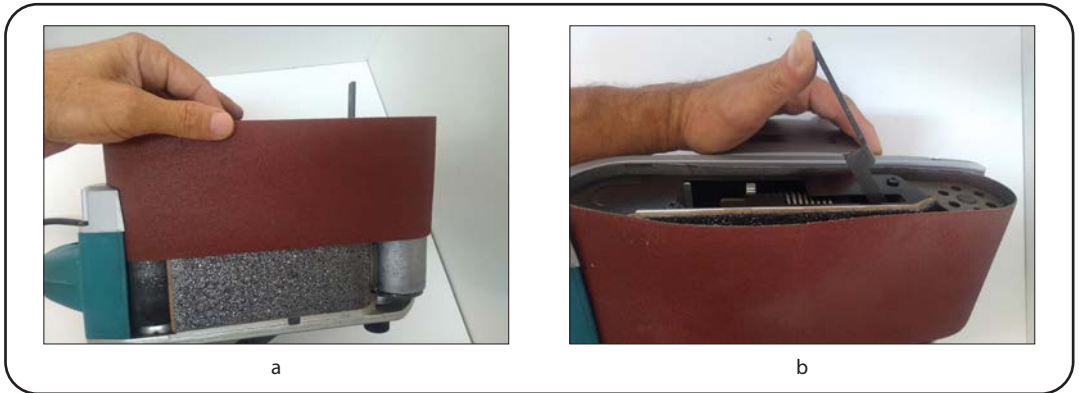
Görsel 3.90: Bant zımparanın makineye takılma aşaması
