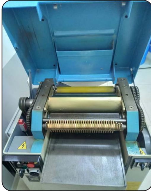
Görsel 1.30: Kalınlık makinesi geri tepme emniyet desteği
