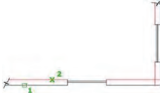
Görsel 1.2.40: Path Array komutu kullanımı
