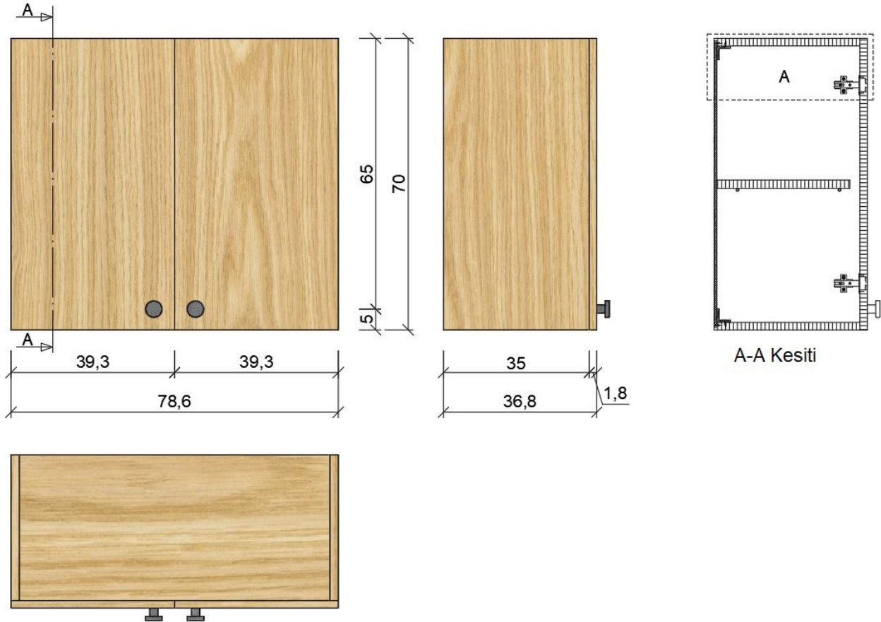
Görsel 1.64: Asma dolap kesit yeri ve çizimi
