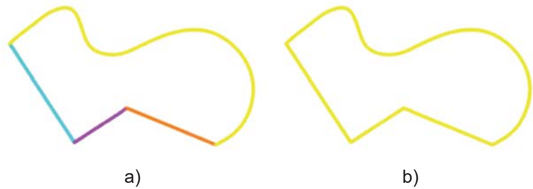
Görsel 2.19: a) Birleşik olmayan çizgiler b) Join ile oluşturulmuş kapalı alan
