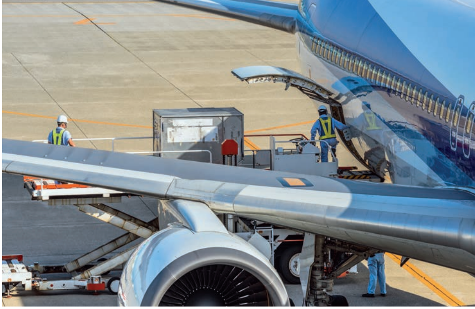
Görsel 2.21: Uçağa yük platformu yükleme
