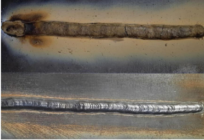
Görsel 6.12: Bazik elektrot ile cürufu ve cürufu kaldırılmış kaynak
