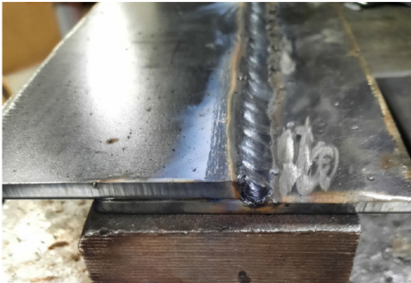
Görsel 7.7: Yatayda kalınlıkları farklı parçaların tamamlanmış kaynak görünümü
