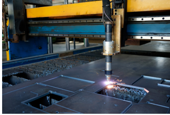
Görsel 11.3: Kalın bir iş parçasının plazma ile kesimi
