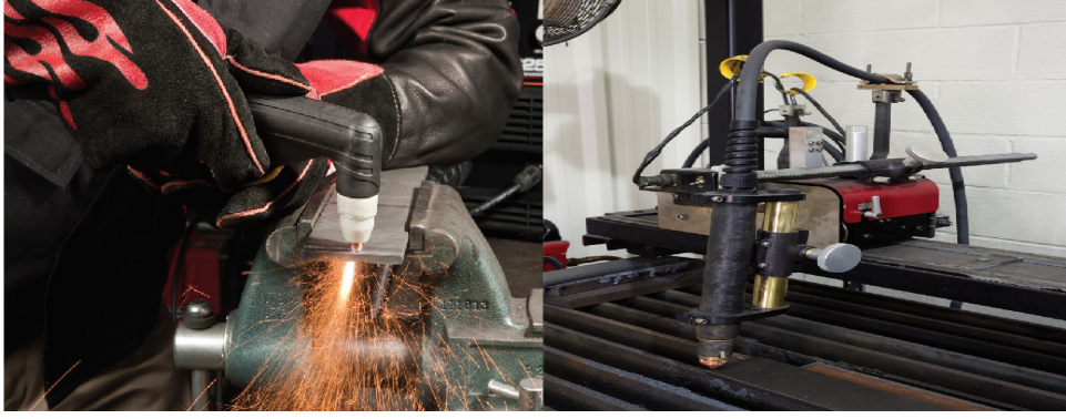
Görsel 11.2: El ve otomatik tezgâh ile plazma kesimi
