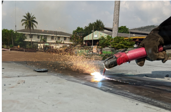
Görsel 11.1: Karbon elektrot ile kesme hareketi
