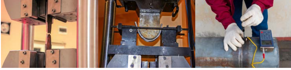
Görsel 2.10: Tahribatlı test yöntemleri
