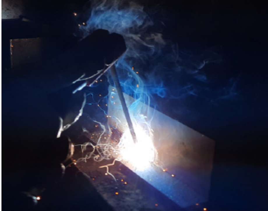
Görsel 8.1: Yatayda iç köşe kaynağı uygulaması
