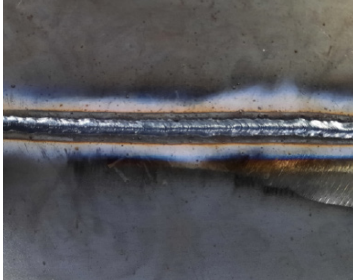
Görsel 7.3: Yatayda tamamlanmış küt ek kaynağı görünümü
