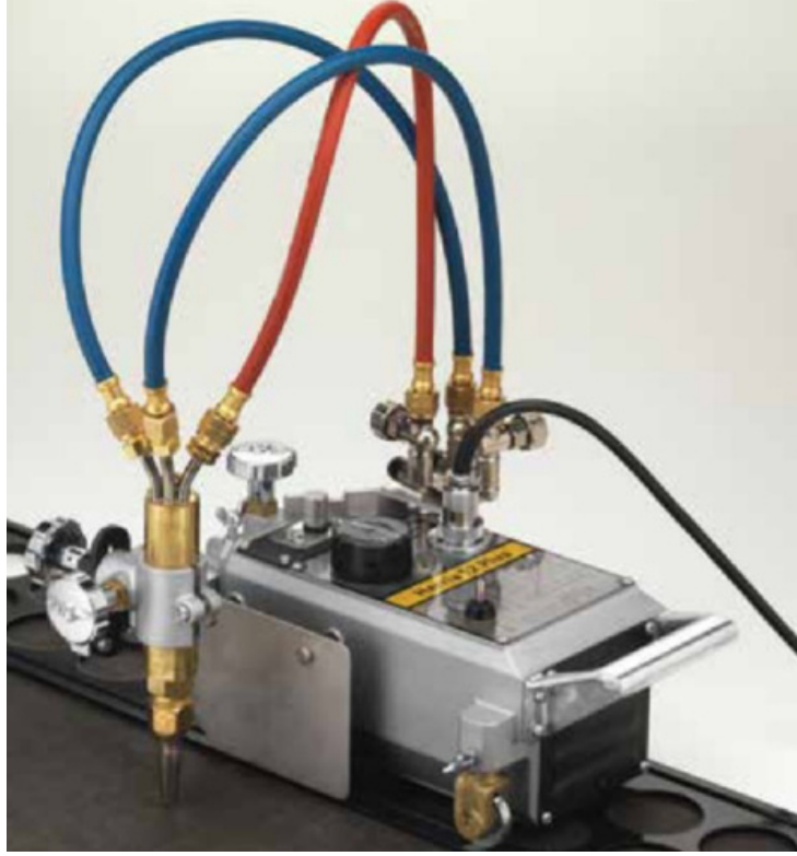
Görsel 3.5: Otomatik raylı ekipman ile yapılan oksî-gaz kesimi
