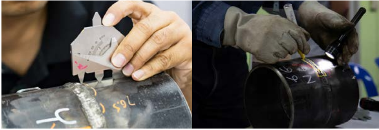
Görsel 2.12: Kaynak kumpası ve el feneri ile kontrol
