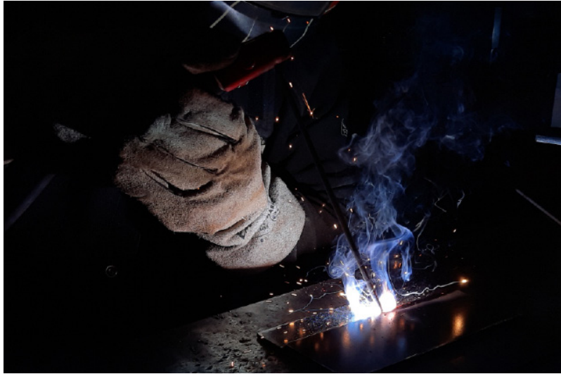
Görsel 7.6: Yatayda kalınlıkları farklı parçaların kaynağının uygulaması
