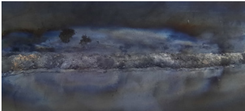
Görsel 2.9: Yatayda soldan sağa tamamlanmış telli dikiş kaynağı
