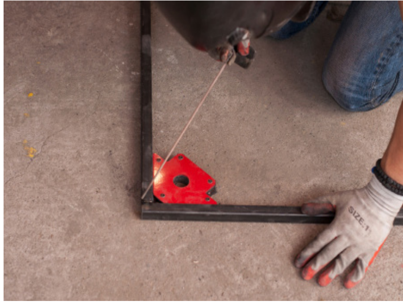
Görsel 10.6: Şekil değişimini engelleyen gönyeli birleştirme uygulaması
