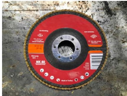
Görsel 2.2: Çelik malzemeler için uygun zımpara
