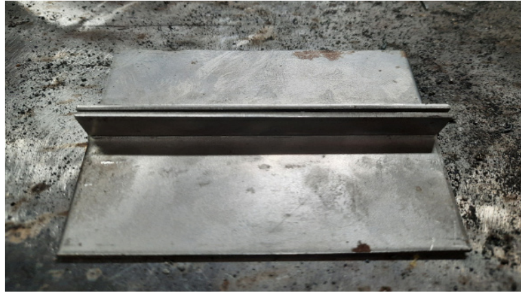
Görsel 2.1: Kenet eki hazırlanmış iş parçası
