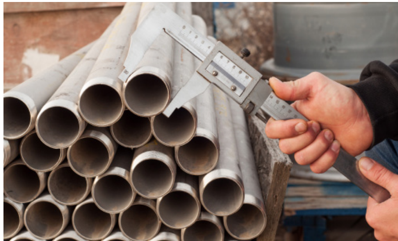
Görsel 9.1: Metal boru çap ölçümü
