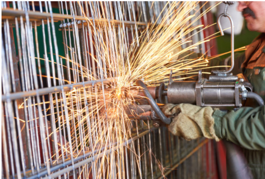
Görsel 5.5: Taşınabilir nokta kaynağı makinesi
