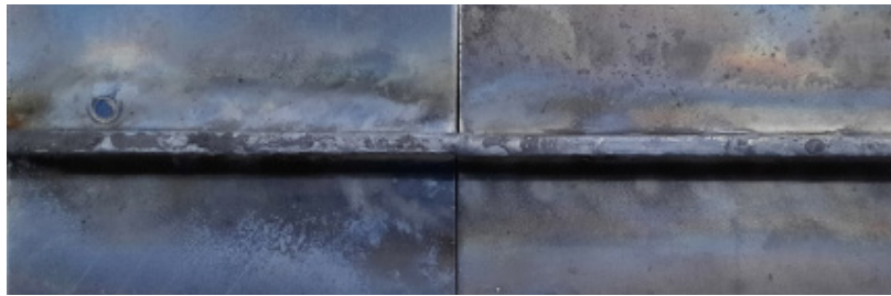
Görsel 2.5: Kenetli dikişi tamamlanmış kaynak
