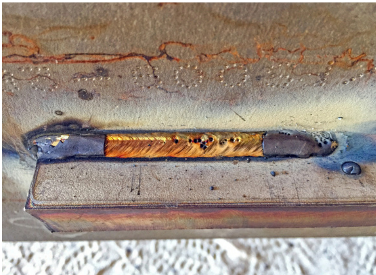
Görsel 10.5: Paslanmaz iş parçasına ait kaynakta gözenek hataları
