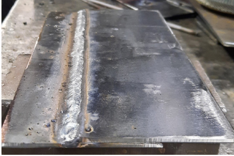
Görsel 7.5: Yatayda tamamlanmış bindirme kaynağı görünümü
