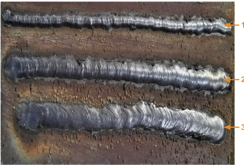
Görsel 6.18: Düşük, uygun ve yüksek amper ile kaynak uygulaması
