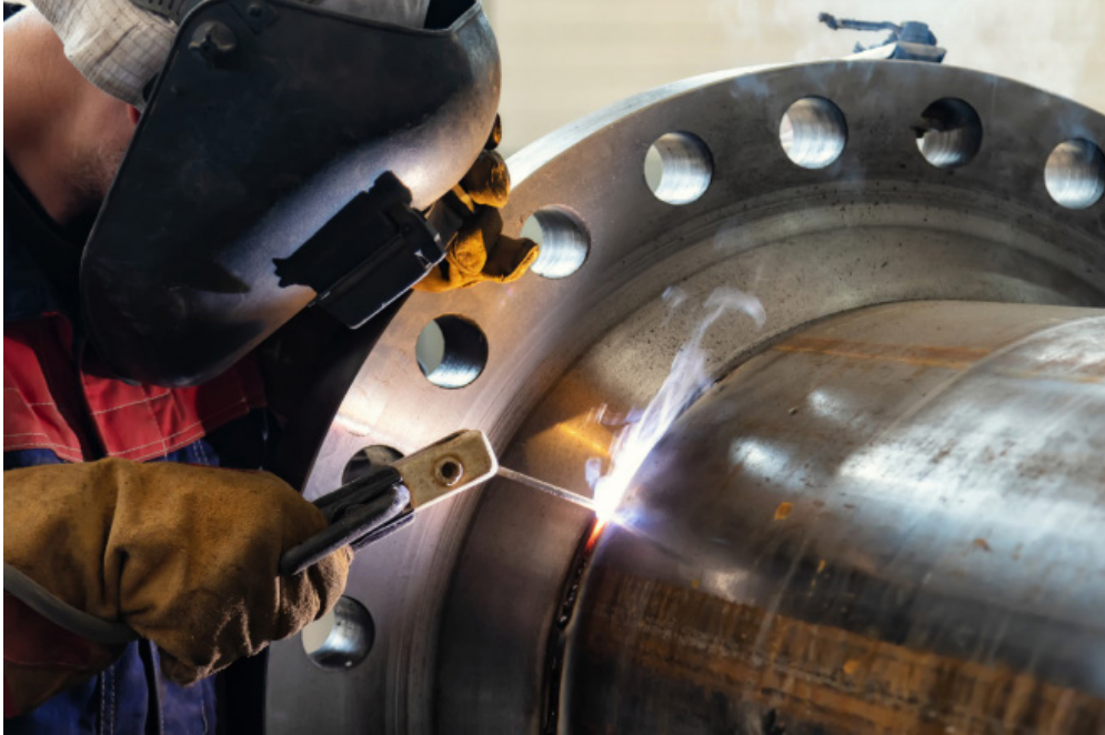
Görsel 8.6: Flanş kaynağı
