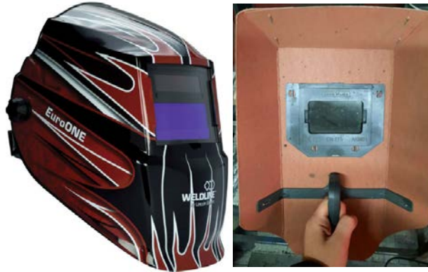
Görsel 6.6: Dijital ve el kaynak maskesi
