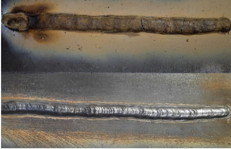
Görsel 6.14: Selülozik elektrot ile cürüflu ve cürufu kaldırılmış kaynak
