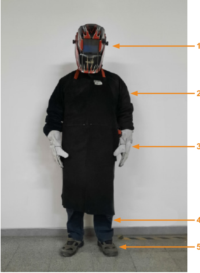
Görsel 6.19: Kişisel koruyucu donanıma sahip kaynak operatörü
