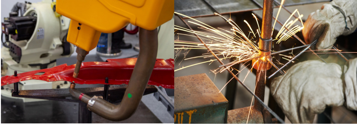
Görsel 5.1: Elektrik direnç kaynağının otomatik ve el ile uygulamaları
