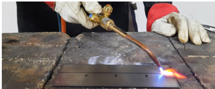
Görsel 1.26: Oksi-gaz kaynağında telsiz dikiş
