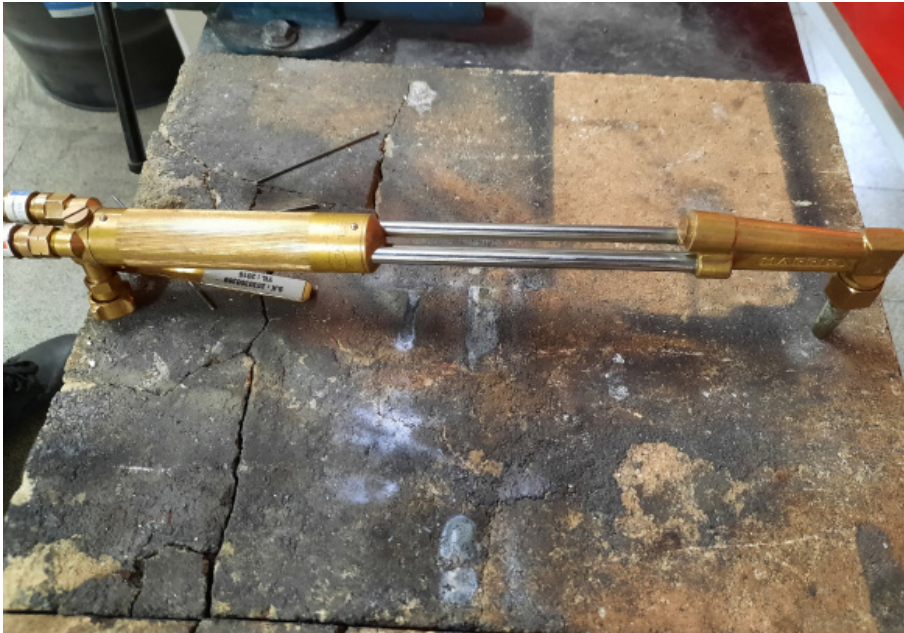
Görsel 3.4: Oksi-gaz ile kesme üfleci
