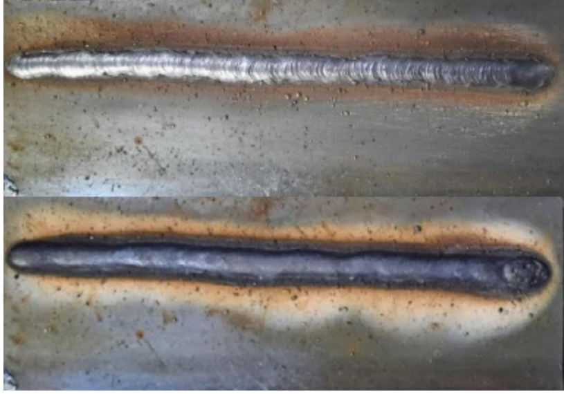
Görsel 6.10: Rutil elektrot ile cürufu ve cürufu kaldırılmış kaynak
