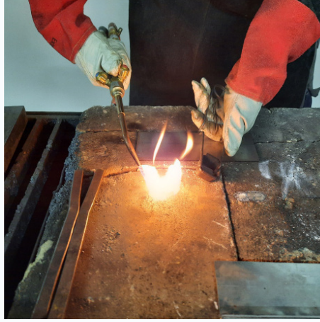
Görsel 1.17: Asetilen ile alev oluşturma
