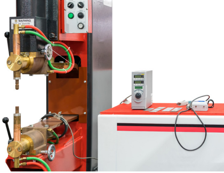
Görsel 5.4: Kollu nokta kaynağı makinesi
