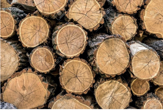
Görsel 7.2: İç çatlak olan ağaç
