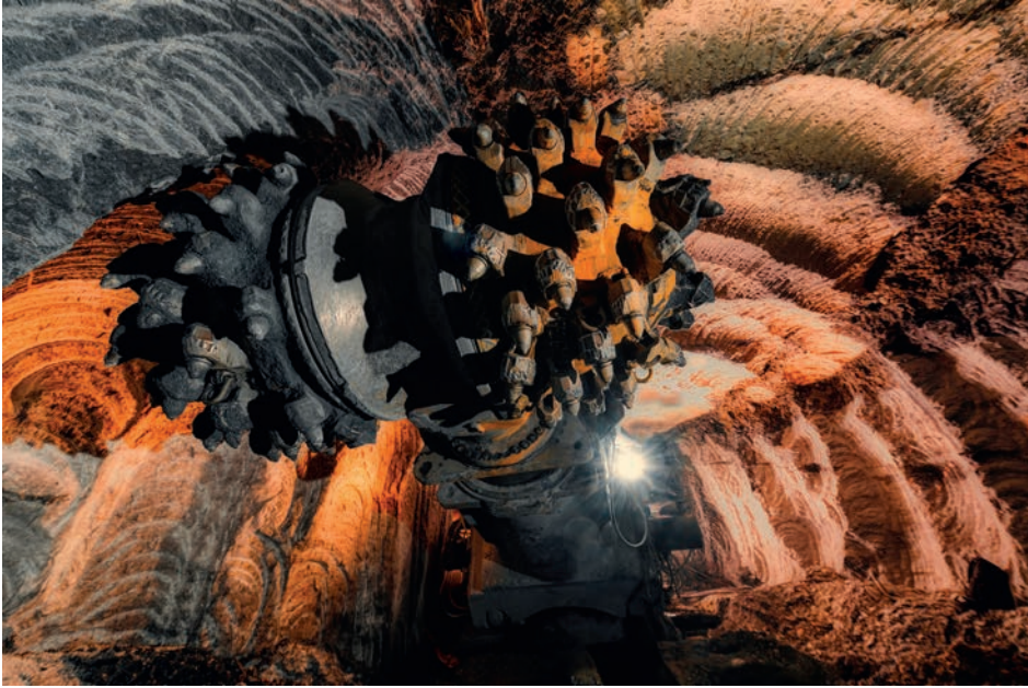
Görsel 2.2: Kollu galeri açma makinesi (kısmi kesit açan galeri açma makinesi)
