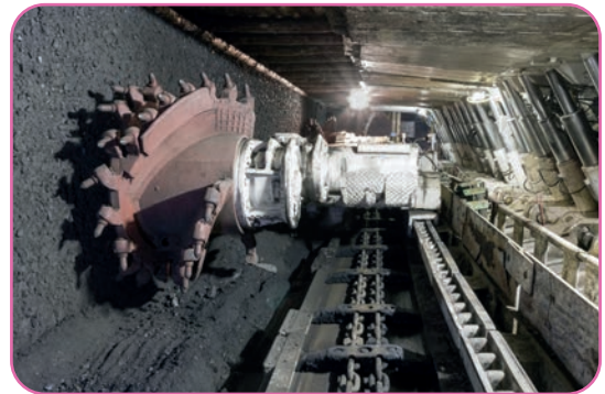
Görsel 3.20: Kömür madeninde kesici yükleyici ile birlikte kullanılan zincirli konveyör
