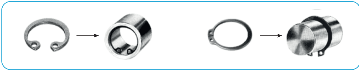
Görsel 1.28: Deliklere ve mile segman takılması
