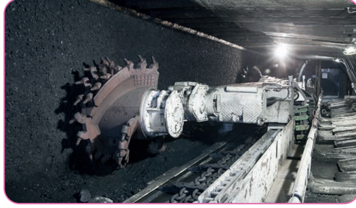
Görsel 3.13: Kesici yükleyici makinenin kömür madenindeki uygulaması
