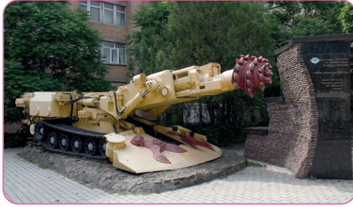
Görsel 3.9: Kol eksenine paralel galerî açma makinesi
