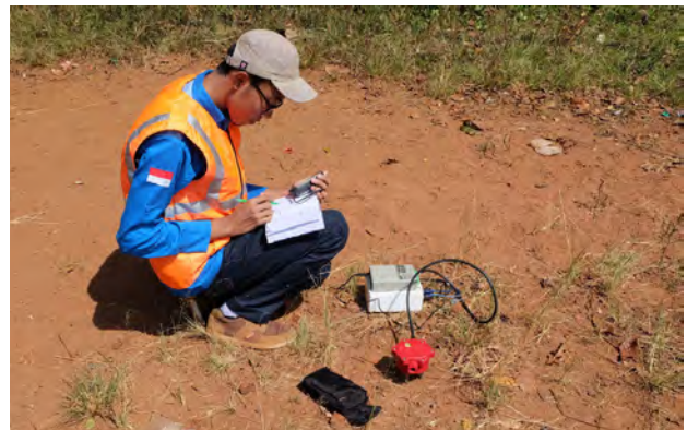
Görsel 11.4: Alan titreşimi ölçme işlemi ve Jeofon
