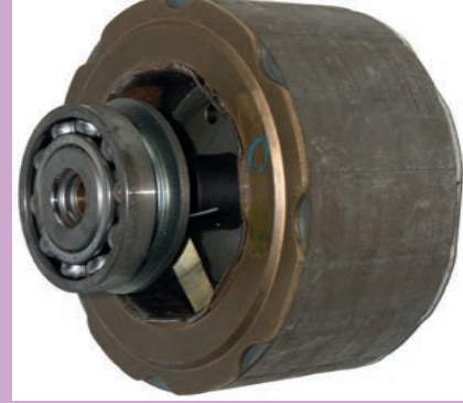
Görsel 7.9: Rotorun görsel kontrolü
