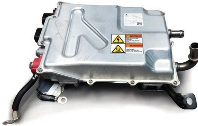
Görse 1.23: Üst segment tamamı elektrikli bir araçta kullanılan DC-DC konvertör
