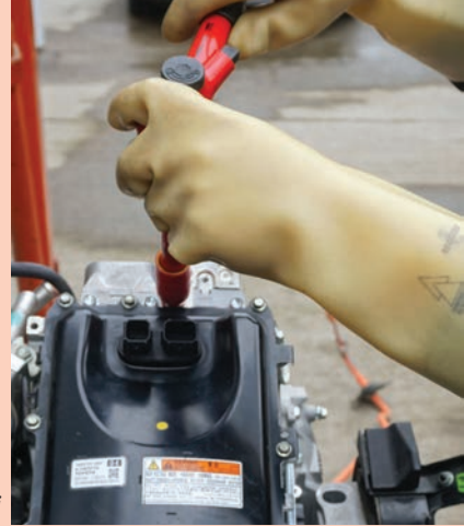
Görsel 1.28: Batarya kablosunun sökülmesi
