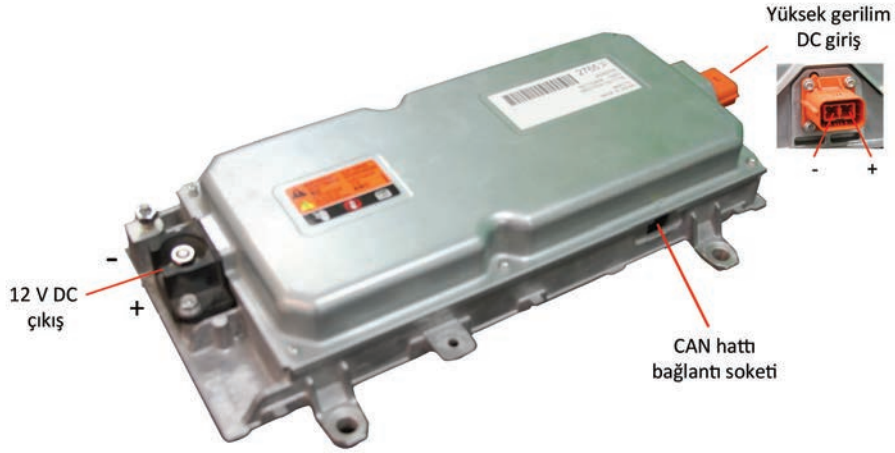
Görse 1.22: Elektrikli bir araçta kullanılan DC-DC dönüştürücü
