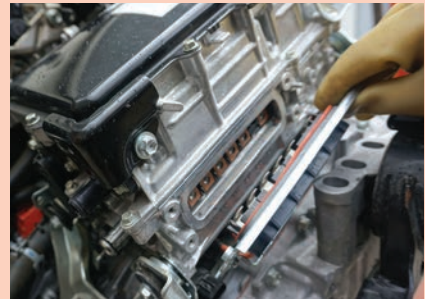
Görsel 1.33: Elektrik motorları kablosunun sökölmesi
