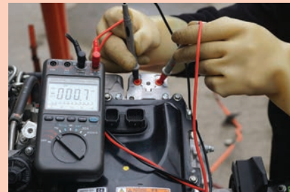
Görsel 1.25: İnvertör grubu kondansatörü geriliminin ölçümü
