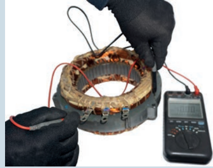
Görsel 5.21: Stator sargılarının şasiye kaçak kontrolü
