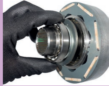
Görsel 7.8: Daimî mıknatıslı rotor rulmanlarının kontrolü
