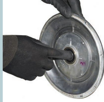
Görsel 6.11: Stator rulmanlarının kontrolü
