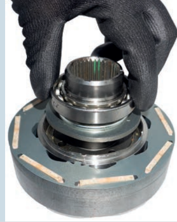
Görsel 5.16: Rotor rulmanlarının kontrolü
