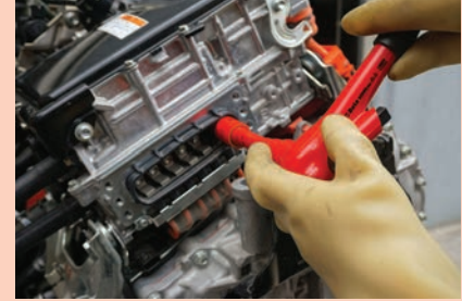
Görsel 1.32: Elektrik motoru yüksek gerilim terminallerinin sökölmesi
