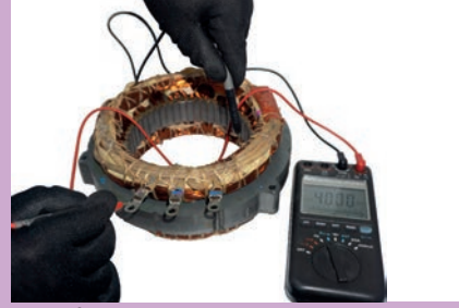
Görsel 7.12: Stator sargılarının kısa devre kontrolü
