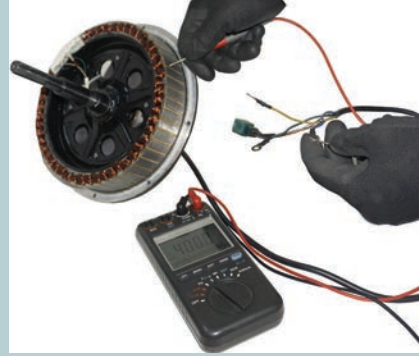
Görsel 6.16: Stator sargılarının şasiye kaçak kontrolü
