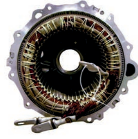
Görsel 4.14: Motor gövdesi ve stator sargıları
