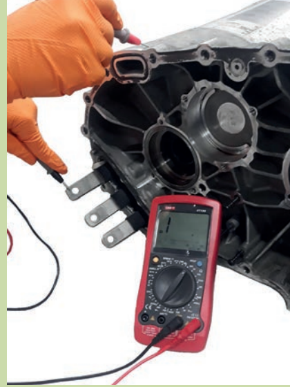
Görsel 4.17: Şaseye kaçak kontrolü
