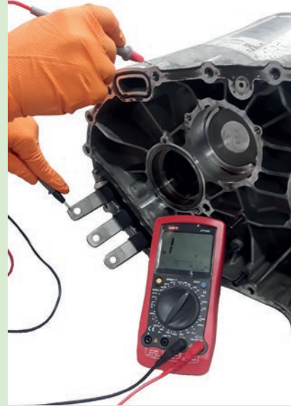
Görsel 3.21: Şaseye kaçak kontrolü
