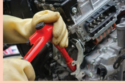
Görsel 1.34: İnvörtör grubunun şanzıman gövdesinden sökülmesi
