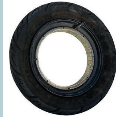
Görsel 5.12: Rotorun görsel kontrolü
