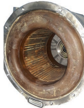
Görsel 3.3: Motor gövdesi ve stator
