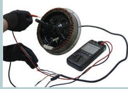
Görsel 6.15: Stator sargılarının kısa devre kontrolü
