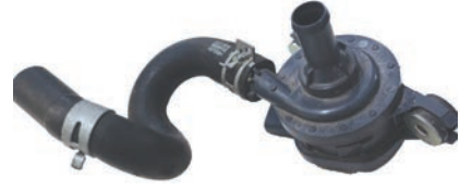
Görsel 8.6: Su pompası
