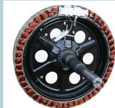
Görsel 6.13: Statorun görsel kontrolü
