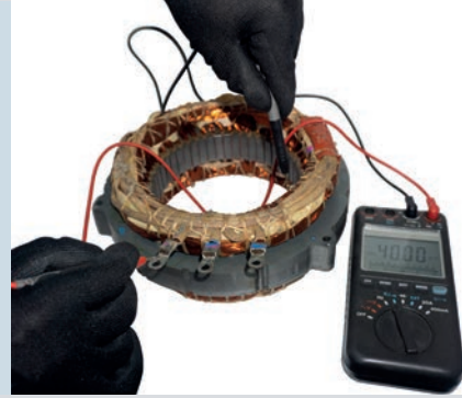
Görsel 5.20: Stator sargılarının kısa devre kontrolü
