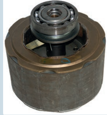
Görsel 5.17: Rotorun görsel kontrolü
