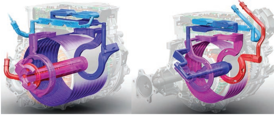
Görsel 8.10 – Görsel 8.11: Su soğutmalı sistem su dolaşımı
