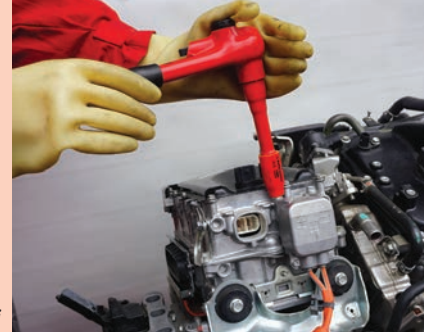
Görsel 1.29: Klima kablosunun sökülmesi
