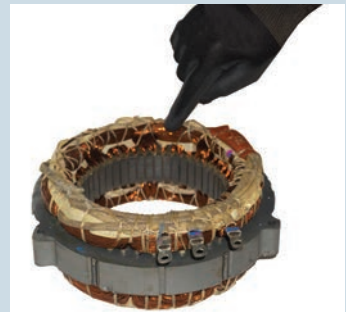
Görsel 5.18: Statorun görsel kontrolü
