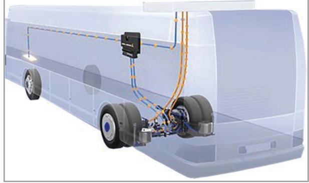
Görsel 6.8: Tekerlek içi motor kullanan elektrikli bir otobüs
