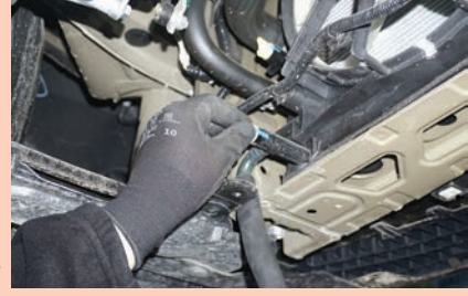
Görsel 1.26: İnvörtör soğutma suyunun boşaltılması
