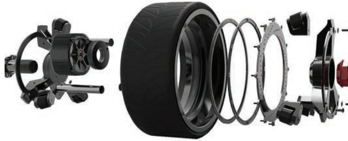
Görsel 6.10: Farklı yapıdaki tekerlek içi motorun yapısı
