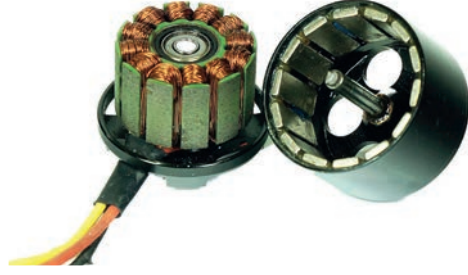
Görsel 2.21: Dış rotorlu fırçasız doğru akım motoru
