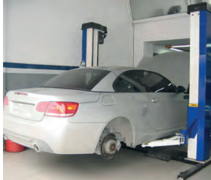
Görsel 3.85: Lift ile araç kaldırılması
