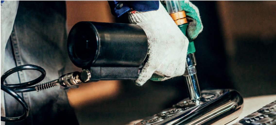
Görsel 2.51: Pnömatik perçin tabancasının kullanımı
