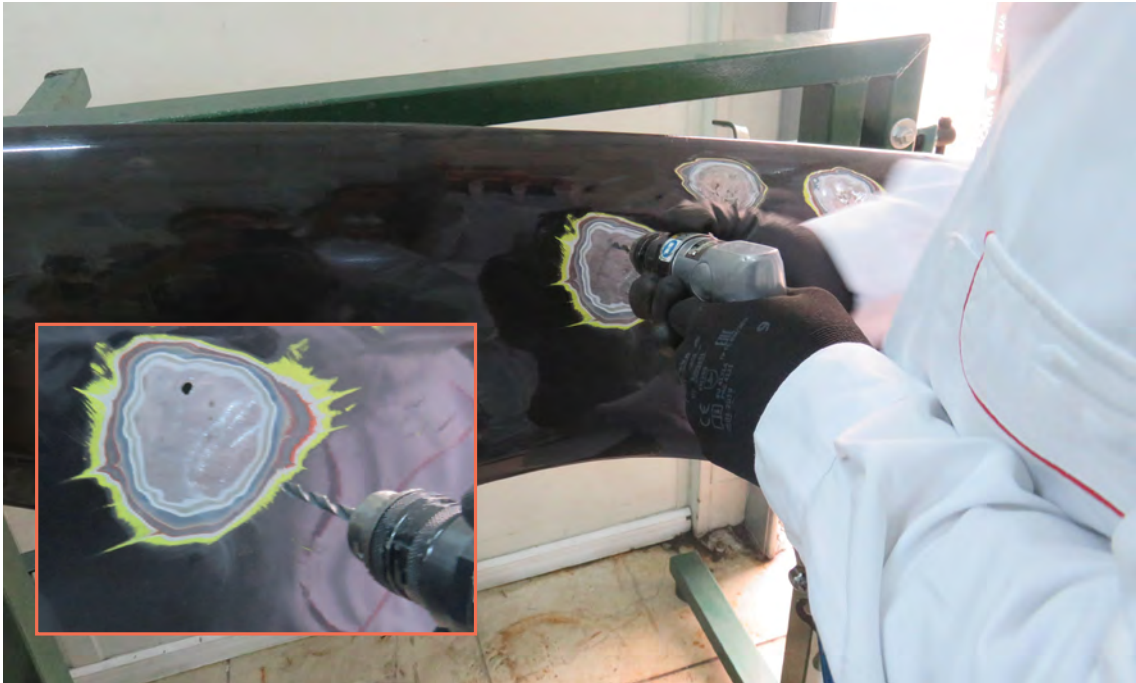
Görsel 2.41: Pnömatik el matkabı ile delme işlemi
