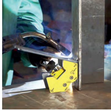
Görsel 3.69: Manyetik pozisyon tutucunun kullanımı
