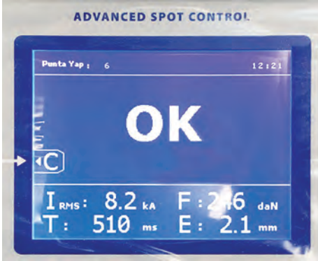
Görsel 1.79: Kaynak sonucu bilgi ekranı
