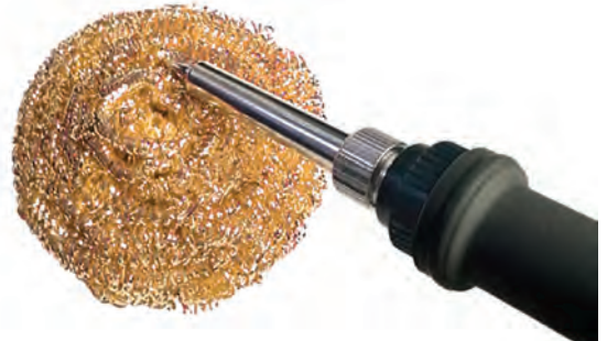
Görsel 1.107: Havaya ucunun tel ile temizlenmesi
