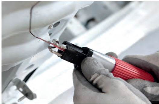
Görsel 2.18: Pnömatik karoseri testeresi ile kesme işleminin yapılması
