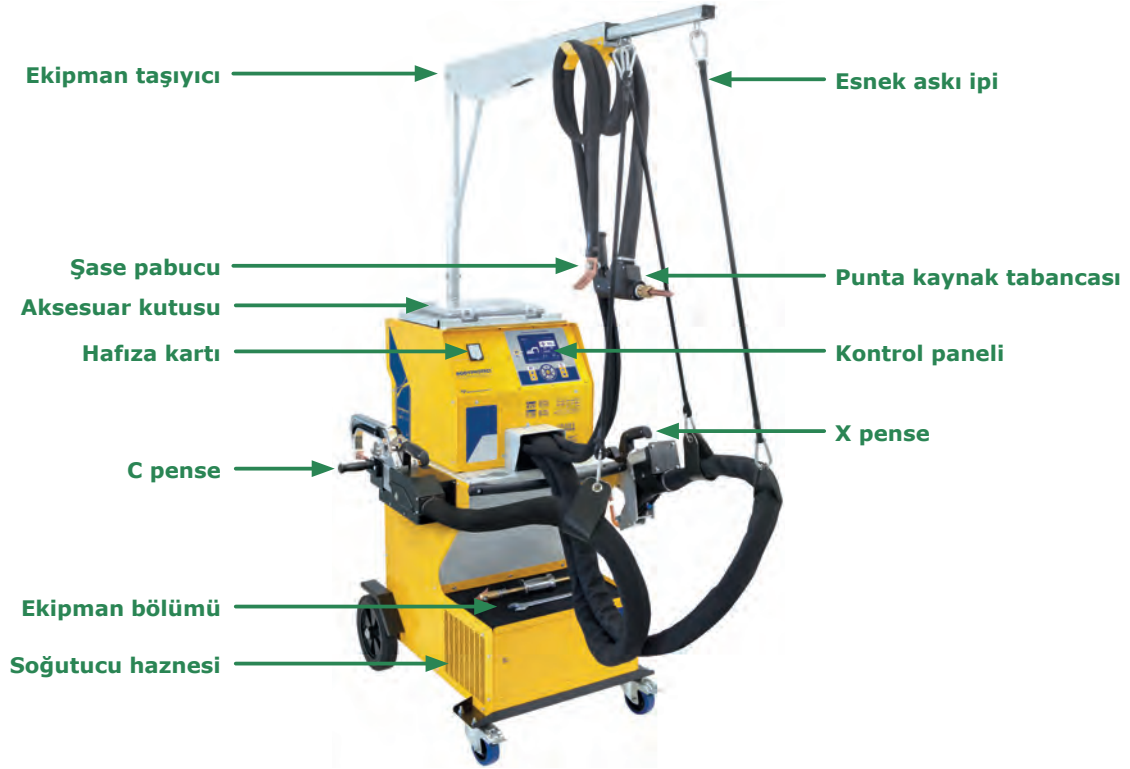
Görsel 1.61: Çok yönlü punta kaynak makinesinin yapısı
