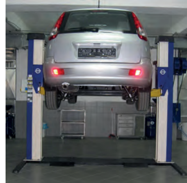
Görsel 3.86: Lift ile araç kaldırılması
