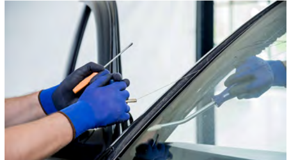
Görsel 5.12: İki kişi ile cam yapışkanının kesilmesi
