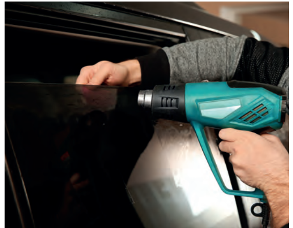
Görsel 3.52: Fön ile cam filmi uygulaması
