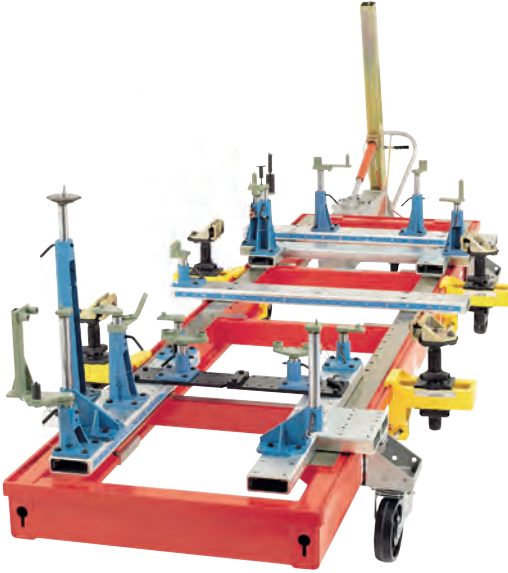
Görsel 4.19: Kalıplı sistem düzeltme tezgâhı
