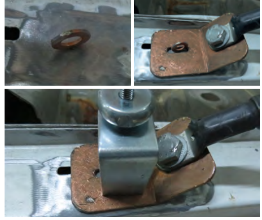
Görsel 1.69: Şase bağlantısının yapılışı
