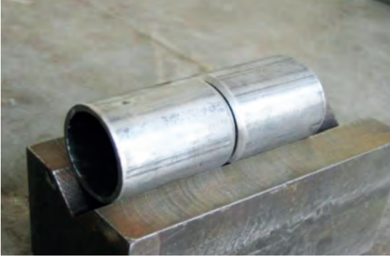
Görsel 1.121: Boruların sert lehimleme işlemine hazırlanması
