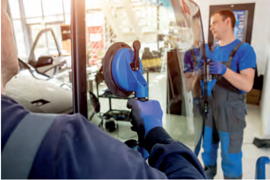
Görsel 5.14: Cam vantuzları ile cam taşınması
