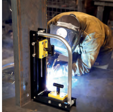
Görsel 3.72: Manyetik parça tutucunun kullanımı
