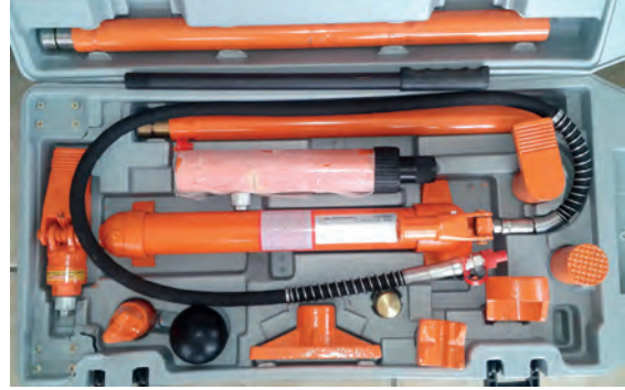
Görsel 4.27: 10 ton yük kapasiteli itme pistonu seti
