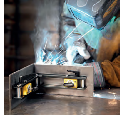
Görsel 3.73: Manyetik parça tutucu ile köşe kaynağı
