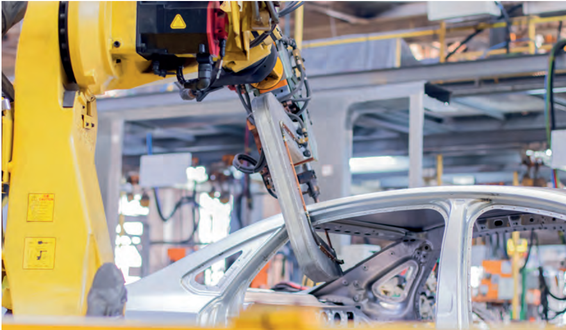
Görsel 1.59: Robotik punta kaynağı
