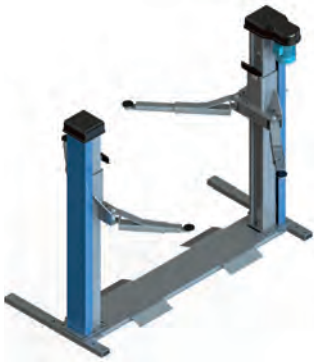
Görsel 3.84: Elektromekanik iki sütunlu lift
