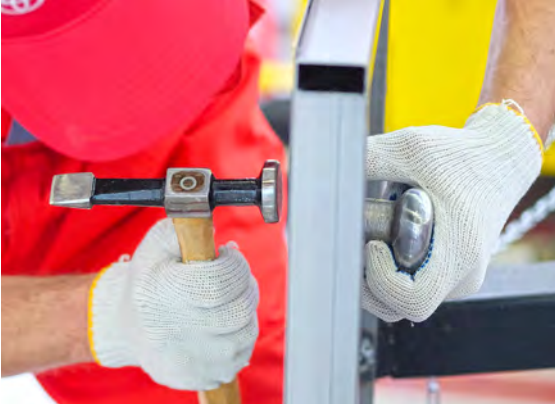
Görsel 5.63: Çekiç dayama yönteminin uygulanışı
