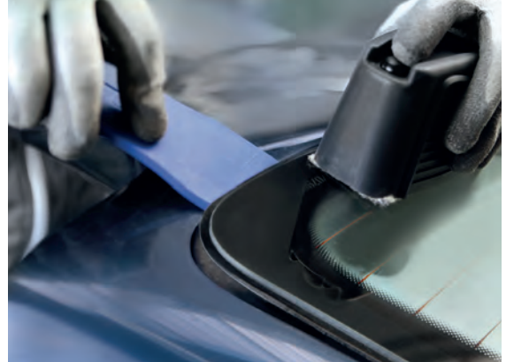
Görsel 3.62: Cam yapışkanının ısıtıcı ile sökülmesi
