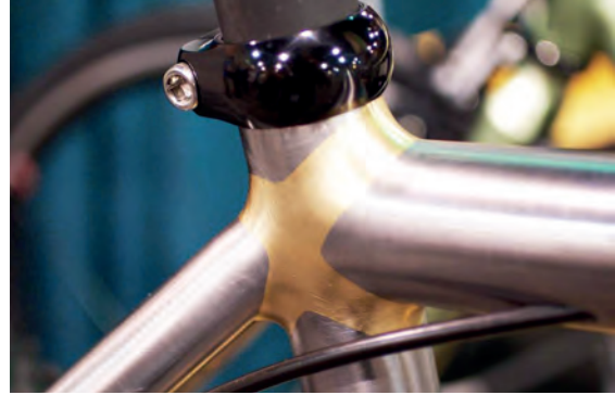
Görsel 1.122: Sert lehimleme ile birleştirilen borular
