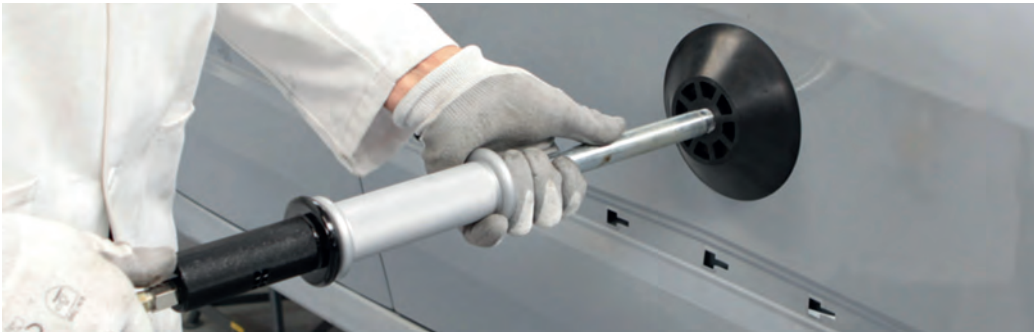
Görsel 2.66: Vakumlu çektirme cihazının kullanımı
