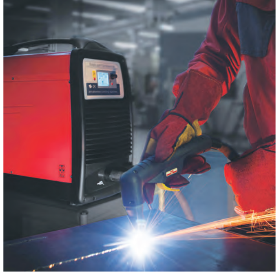
Görsel 3.54: Plazma kesme cihazının kullanımı
