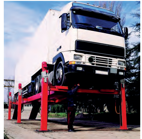
Görsel 3.101: Altı sütunlu lift ile ağır vasıta kaldırılması
