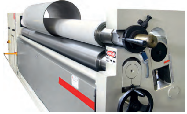
Görsel 5.35: Elektrikli silindir kıvrırma makinesi
