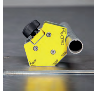
Görsel 3.70: Boru malzeme tutulması
