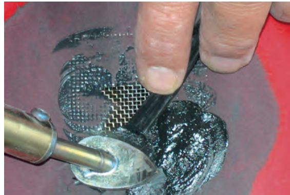
Görsel 3.48: Örgü telinin plastik kaynak çubuğu ile kaynatılması
