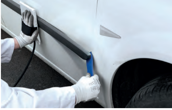
Görsel 3.63: Yan çitanın sökülmesi
