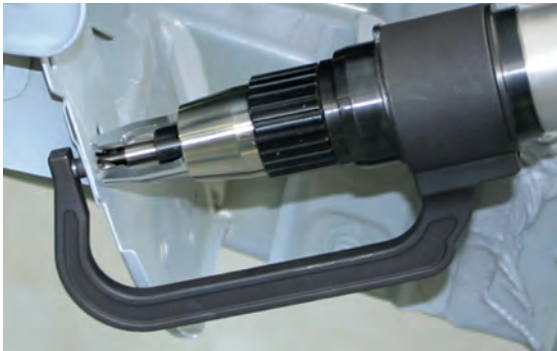
Görsel 2.22: Sac parçada punta çürütme işlemi
