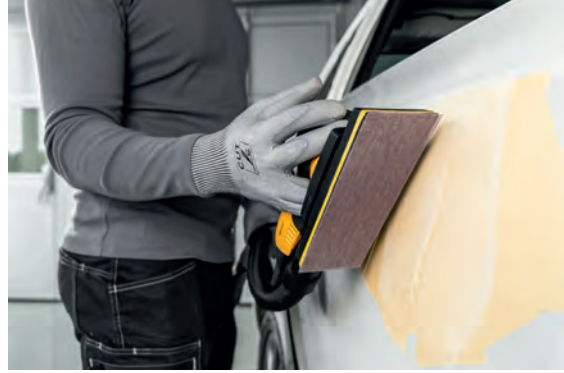
Görsel 3.29: Orbital zımpara makinesinin kullanımı
