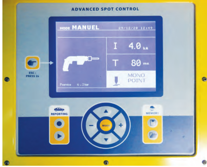
Görsel 1.62: Punta kaynak makinesi kontrol paneli
