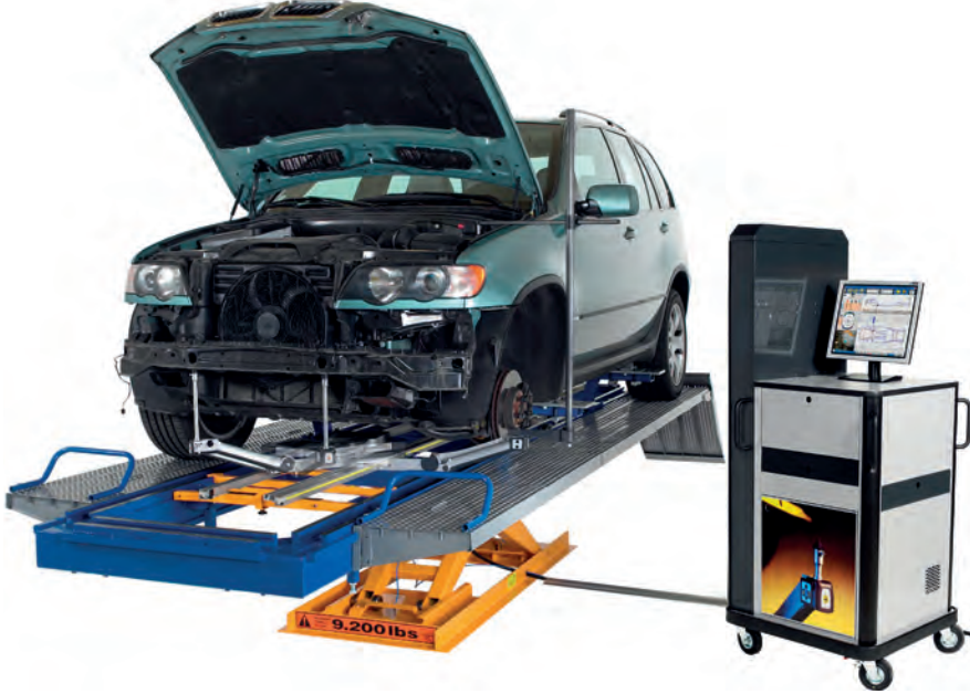
Görsel 4.12: Bilgisayarlı ölçüm sistemi ile araç gövdesinin ölçülmesi
