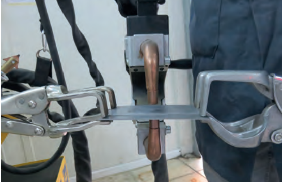
Görsel 1.51: Punta kaynağının yapılışı
