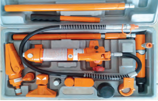
Görsel 4.26: 4 ton yük kapasiteli itme pistonu seti
