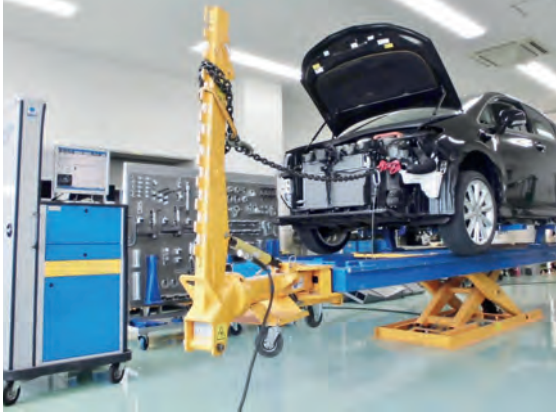
Görsel 4.17: Araç gövde düzeltme işlemi
