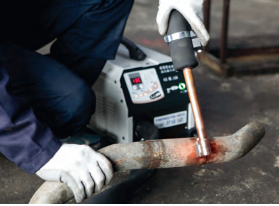
Görsel 3.59: Egzoz bağlantısının ısıtılması
