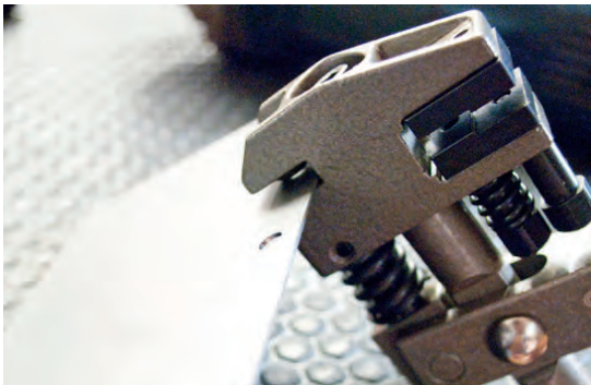
Görsel 5.23: Sac malzemede delik açılması
