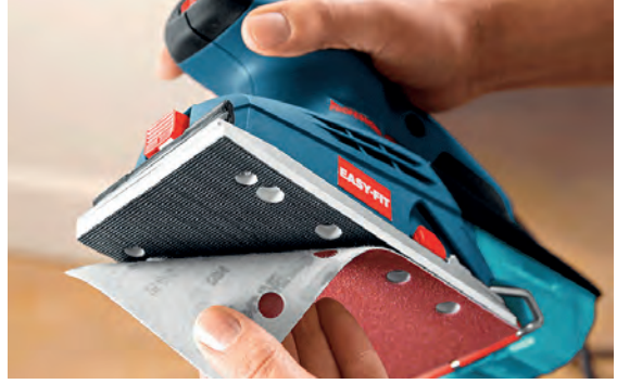
Görsel 3.25: Zımpara tabanlığı ve zımpara kâğıdı
