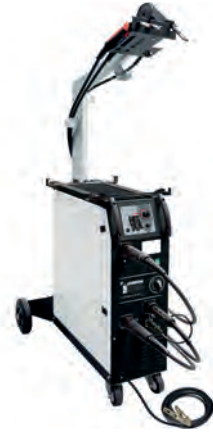
Görsel 1.88: Üç torçlu gazaltı kaynak makinesi
