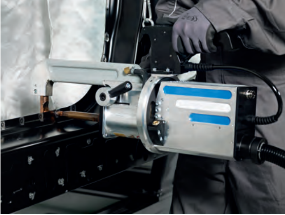
Görsel 1.65: C pense ile punta kaynağı
