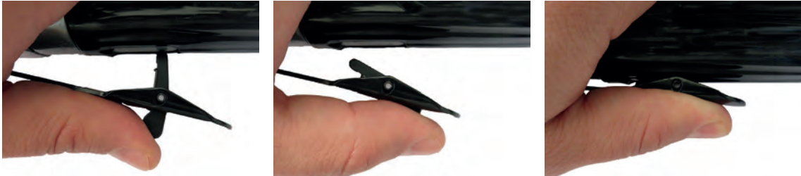
Görsel 2.14: Tetik emniyet mekanizmasının çalışması
