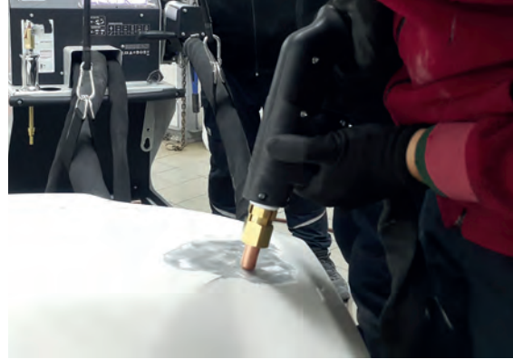
Görsel 1.75: Bakır elektrot ile şiş indirme
