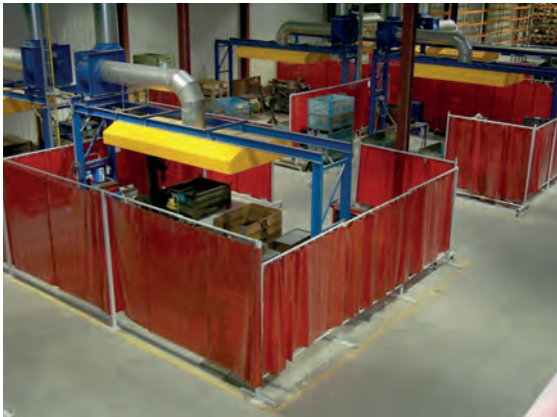
Görsel 1.37: Paravanlarla kabin hâline getirilmiş kaynak alanı
