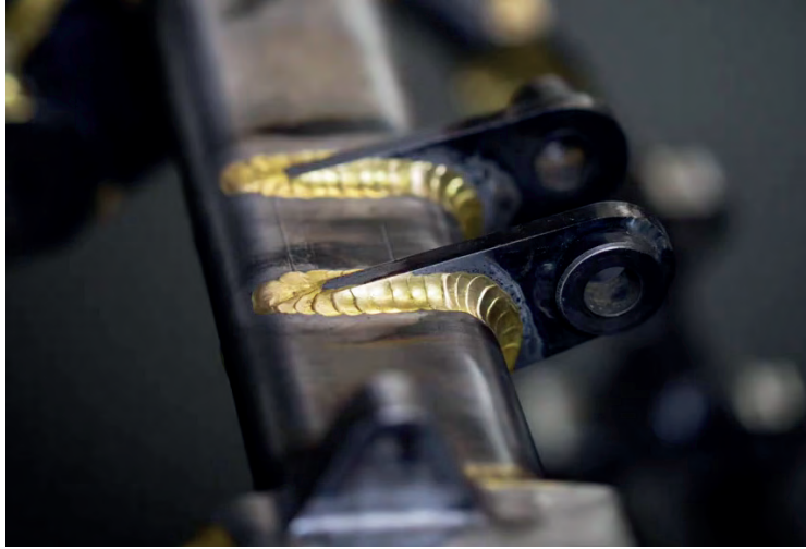
Görsel 1.116: Sert lehimleme ile yapılan birleştirme
