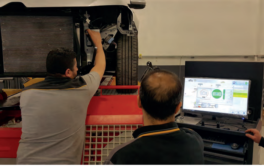
Görsel 4.9: Araç gövdesinin ön kısmında ölçüm yapılması
