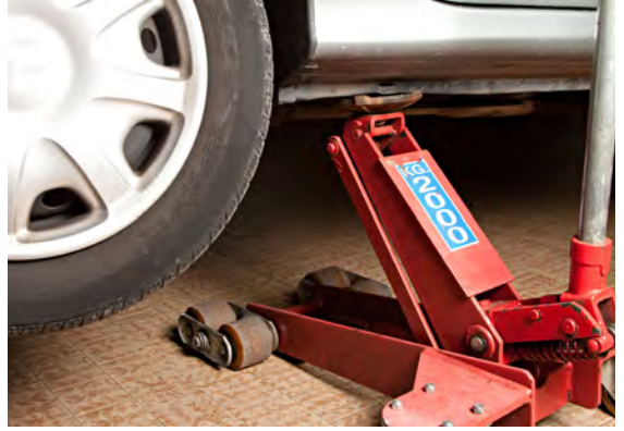
Görsel 4.30: Arabalı kriko ile araç kaldırılması
