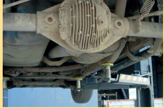
Görsel 3.90: Lift kollarının yerleştirilmesi
