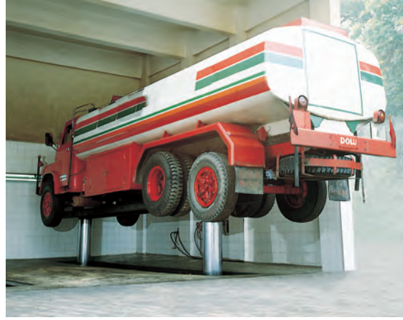
Görsel 3.103: Hidrolik pistonlu ağır vasıta liftinin kullanımı
