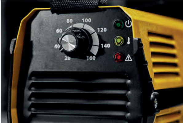
Görsel 1.48: Kaynak akımının ayarlanması
