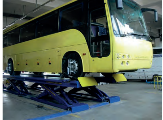
Görsel 3.118: Makaslı lift ile ağır vasıta kaldırılması
