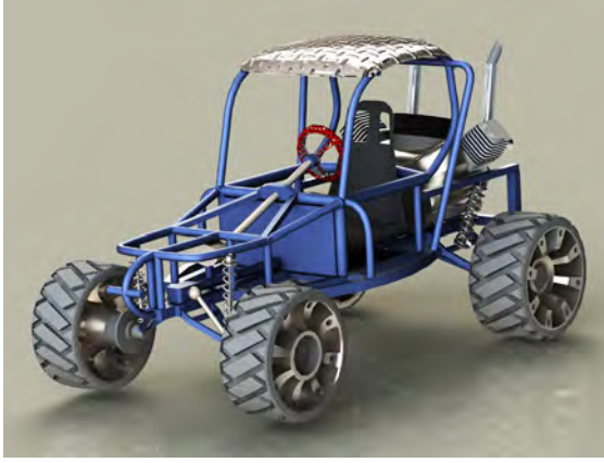
Görsel 5.1: Borudan imal edilmiş şasili buggy araç
