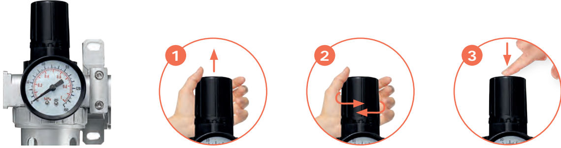
Görsel 2.9: Hava şartlandırıcıda basınç ayarlama işlemi
