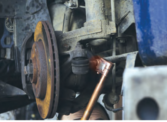
Görsel 3.57: Rot başının ısıtılması
