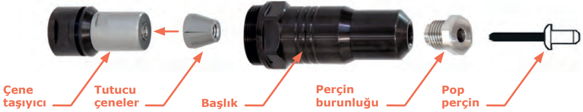
Görsel 2.50: Perçin tutucu çene mekanizmasının yapısı
