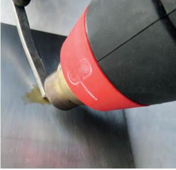
Görsel 1.108: Sıcak hava üfleyici ile lehimleme
