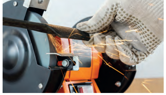
Görsel 3.20: Zımpara taşı tezgâhının kullanımı
