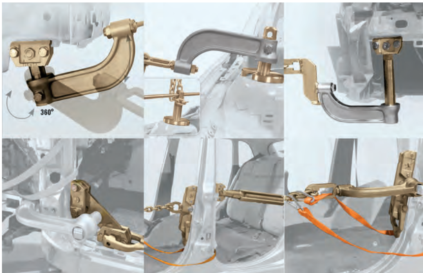
Görsel 5.17: Çektilme tertibatının kullanımı
