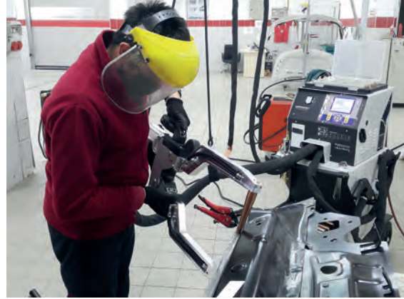
Görsel 1.66: X pense ile punta kaynağı
