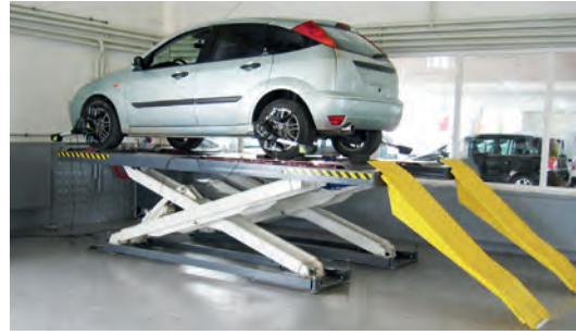
Görsel 3.112: Makaslı lift ile araç kaldırılması
