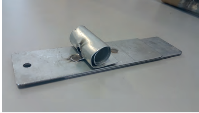
Görsel 1.80: Punta kaynağı kopma testi
