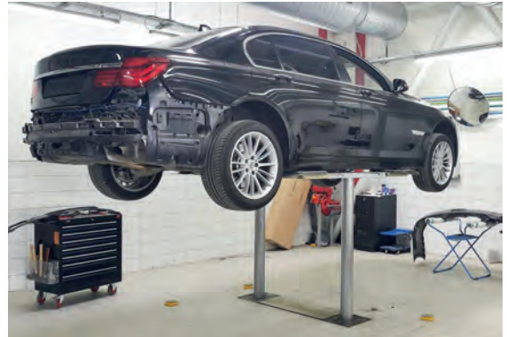
Görsel 3.97: Platformlu iki pistonlu lift ile araç kaldırılması
