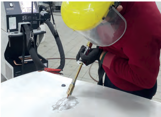
Görsel 1.76: Üçgen elektrot ile göçük çektirme
