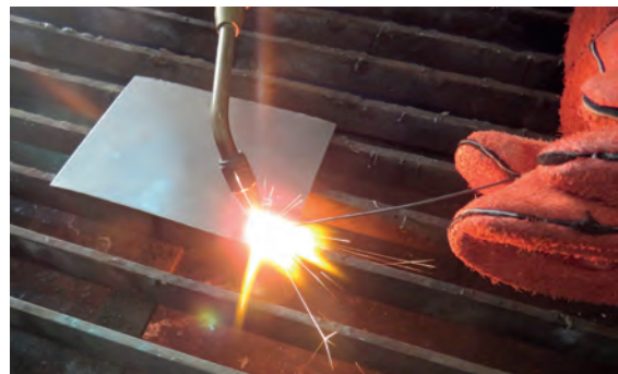
Görsel 1.16: Oksi-gaz kaynağında sağ kaynak uygulaması
