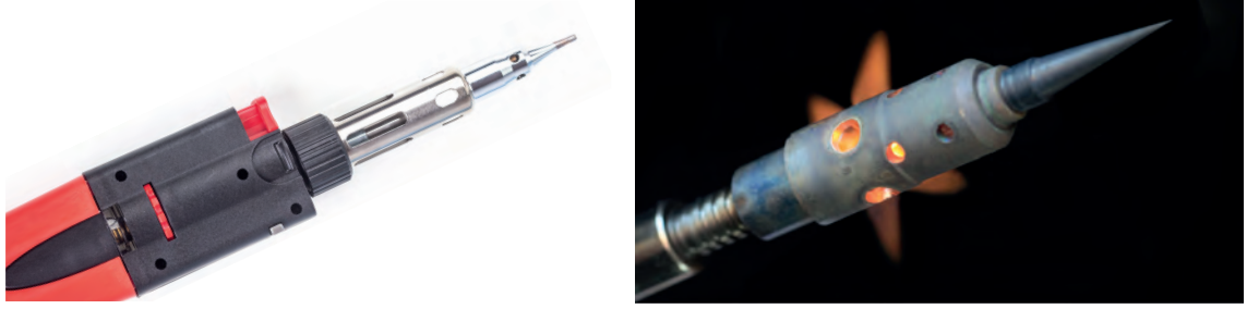
Görsel 1.113: Gazlı havya ve çalışması
