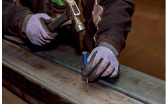
Görsel 5.58: Çekiç ve nokta ile markalama işlemi
