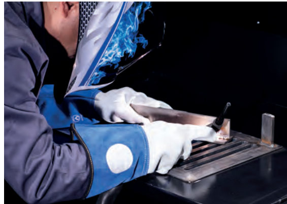
Görsel 1.99: TIG kaynağı ile alüminyum kaynatılması
