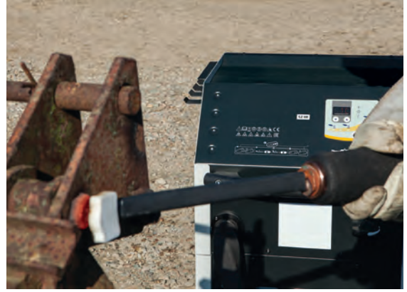
Görsel 3.60: Cıvata başının ısıtılması
