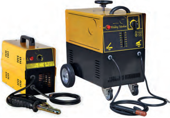
Görsel 1.22: Transformatör kaynak makineleri
