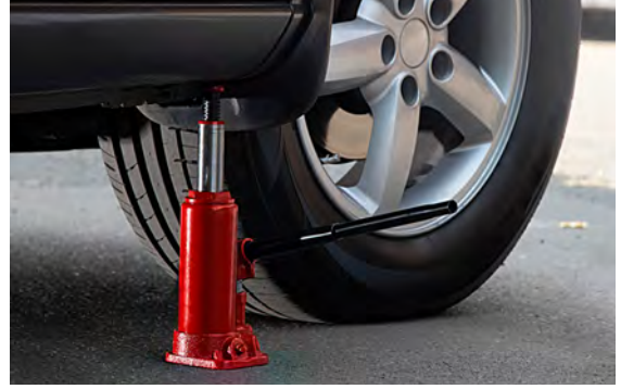
Görsel 4.22: Şişe kriko ile araç kaldırılması
