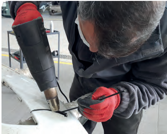
Görsel 3.51: Fön ile plastik kaynağı yapılması
