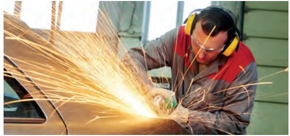
Görsel 3.9: Spiral taşlama ile gövde üzerinde taşlama işlemi
