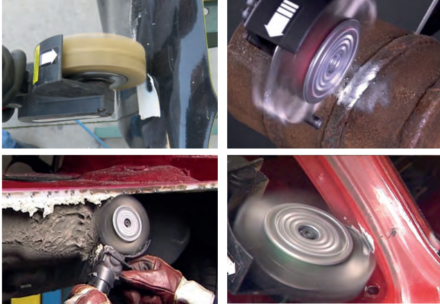
Görsel 2.64: Pnömatik yüzey temizleme cihazının kullanımı
