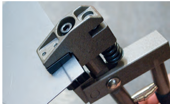
Görsel 5.24: Kenet pensesi ile parçanın hazırlanması
