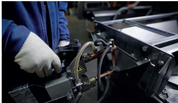
Görsel 1.50: Elektrik direnç kaynağı ile yapılan birleştirme uygulaması
