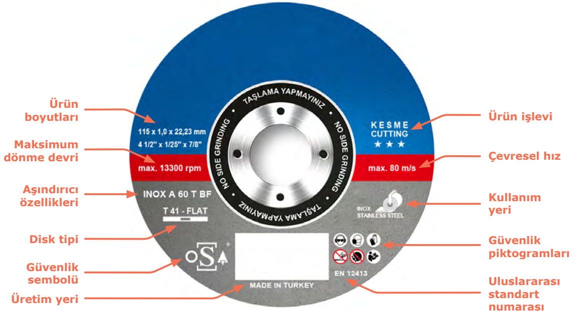
Görsel 2.12: Kesme diskinin üzerindeki etiket bilgileri
