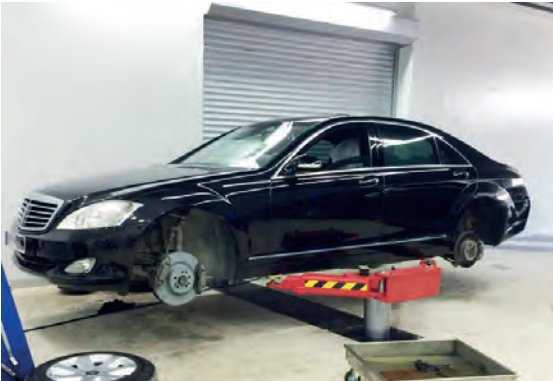
Görsel 3.96: Kollu iki pistonlu lift ile araç kaldırılması
