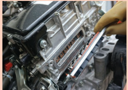
Görsel 1.33: Elektrik motorları kablosunun sökülmesi
