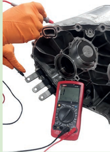
Görsel 3.21: Şaseye kaçak kontrolü
