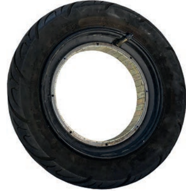
Görsel 5.12: Rotorun görsel kontrolü
