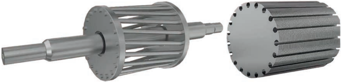
Görsel 3.6: Rotor sincap kafes yapısı ve rotor çelik plakaları
