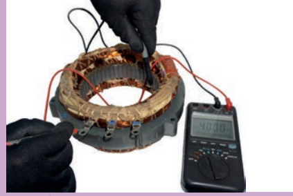
Görsel 7.12: Stator sargılarının kısa devre kontrolü
