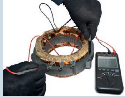
Görsel 5.21: Stator sargılarının şasiye kaçak kontrolü
