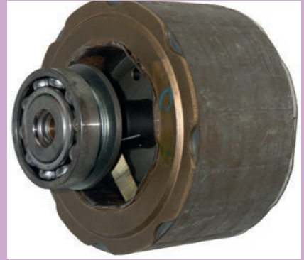
Görsel 7.9: Rotorun görsel kontrolü
