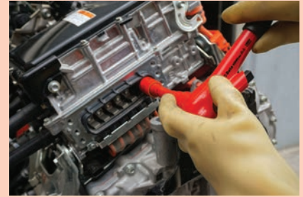
Görsel 1.32: Elektrik motoru yüksek gerilim terminallerinin sökülmesi
