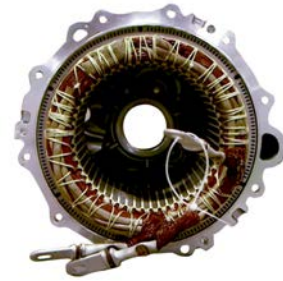
Görsel 4.14: Motor gövdesi ve stator sargıları
