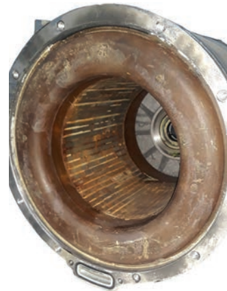
Görsel 3.3: Motor gövdesi ve stator
