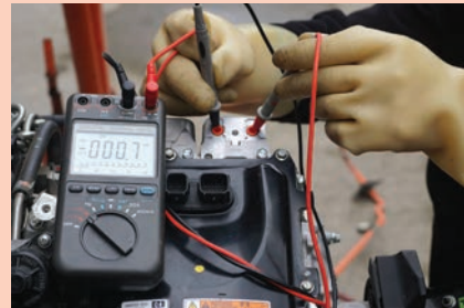
Görsel 1.25: İnvörtör grubu kondansatörü geriliminin ölçümü
