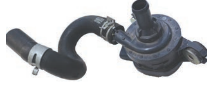
Görsel 8.6: Su pompası
