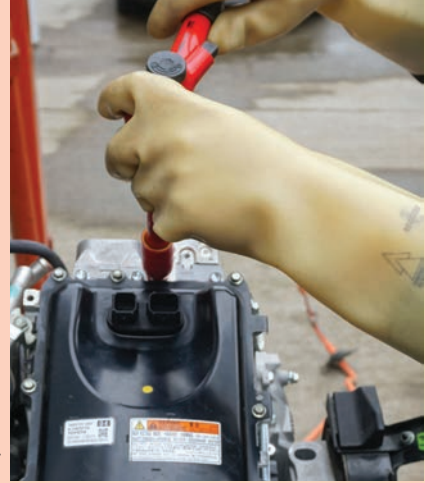
Görsel 1.28: Batarya kablosunun sökülmesi
