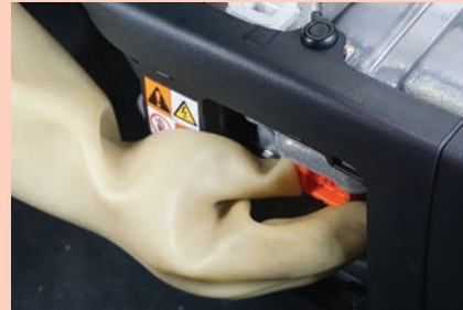
Görsel 1.24: Servis tapasının bataryadan sökülmesi
