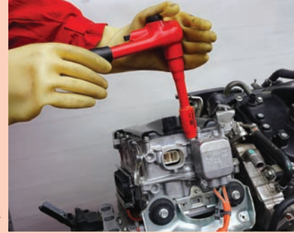
Görsel 1.29: Klima kablosunun sökülmesi
