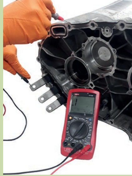
Görsel 4.17: Şaseye kaçak kontrolü
