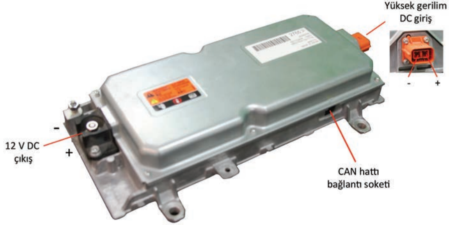
Görsel 1.22: Elektrikli bir araçta kullanılan DC-DC dönüştürücü
