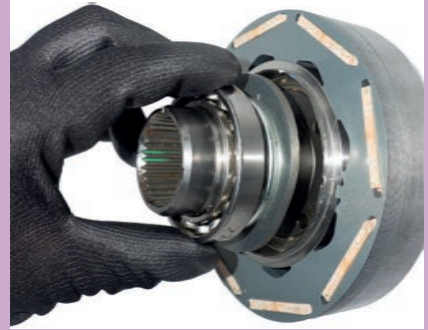
Görsel 7.8: Daimî mıknatıslı rotor rulmanlarının kontrolü
