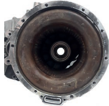
Görsel 3.18: Motor gövdesi ve stator sargıları
