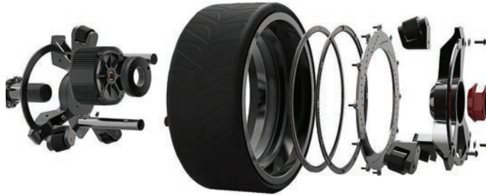
Görsel 6.10: Farklı yapıdaki tekerlek içi motorun yapısı
