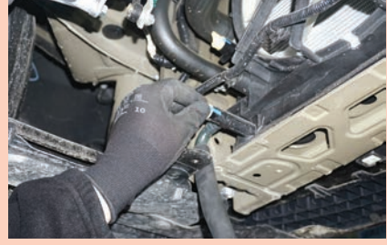
Görsel 1.26: İntertör soğutma suyunun boşaltılması
