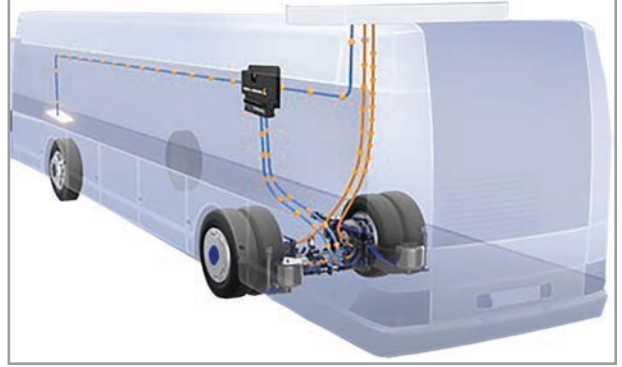
Görsel 6.8: Tekerlek içi motor kullanan elektrikli bir otobüs
