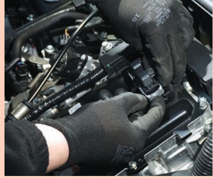
Görsel 1.27: Kablo demeti socketinin ayrılması
