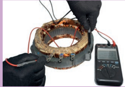
Görsel 7.13: Stator sargılarının şasiye kaçak kontrolü
