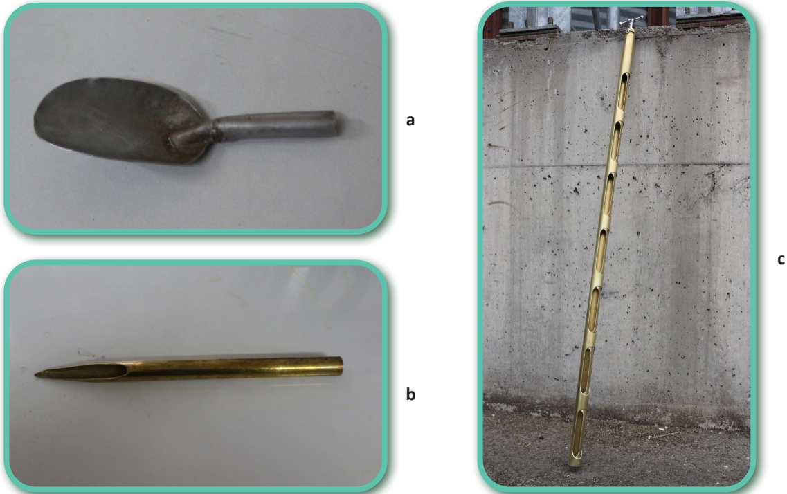
Görsel 1.9: Numune alma araçları (a: Bakkal küreği, b: El sondası, c: Çuval sondası)
