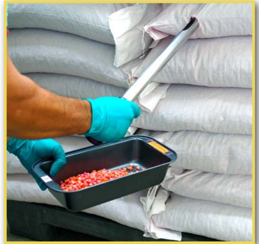
Görsel 1.6: Çuvaldan sonda ile numune alınması
