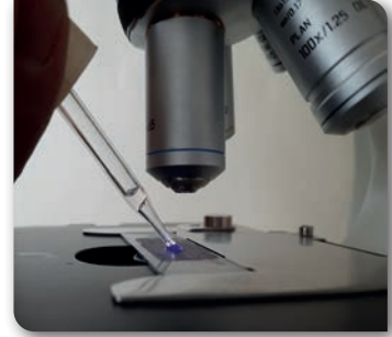
Görsel 7.12: Preparatta inceleme yapılacak alana sedir yağı damlatılması
