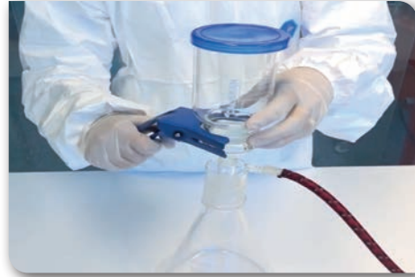
Görsel 2.38: Filtrasyon düzeneğinin kontrol edilmesi
