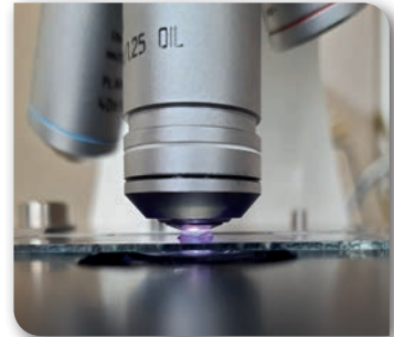
Görsel 7.13: İmmersiyon objektif ucunun sedir yağına temas ettirilmesi
