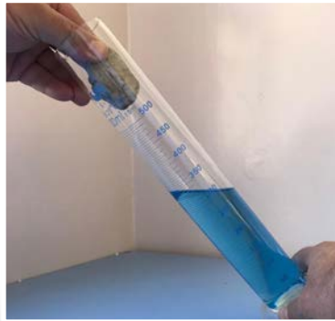
Görsel 1.4: Boyutları ölçülemeyen katı maddelerde hacim ölçümü
