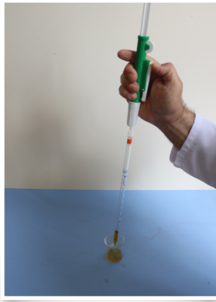
Görsel 1.18: Sıvının mandala basılarak boşaltılması
