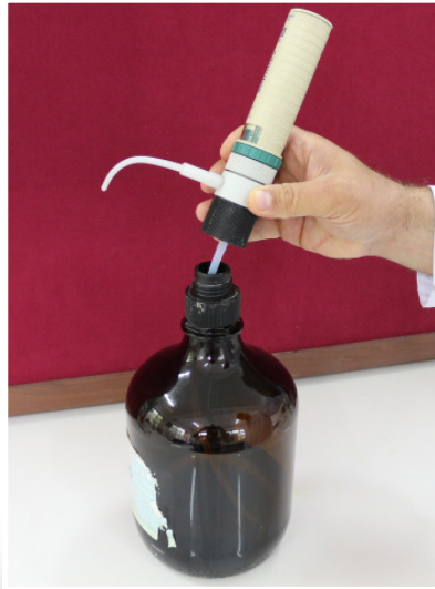
Görsel 1.25: Dispenser ile hacim ölçümü
