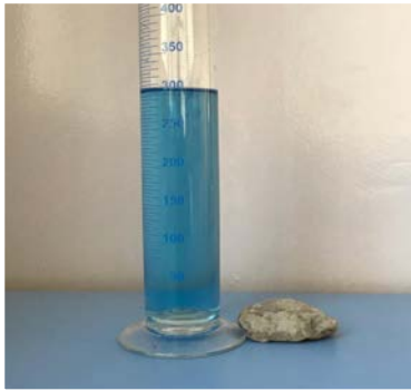
Görsel 1.4: Boyutları ölçülemeyen katı maddelerde hacim ölçümü
