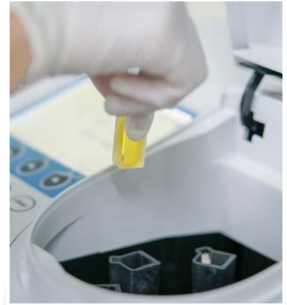
Görsel 5.16: Spektrofotometrede okuma
