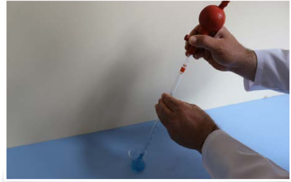
Görsel 1.14: Pipetten sıvı boşaltma
