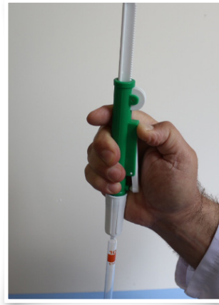
Görsel 1.19: Pipet pompasının mandalina basılması
