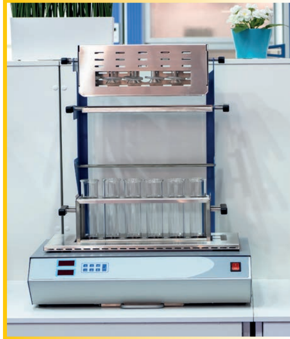
Görsel 1.28: Yakma ünitesi
