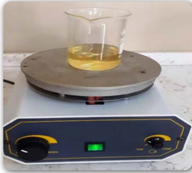
Görsel 8.15: Manyetik karıştırıcıda numunenin çözündürülmesi
