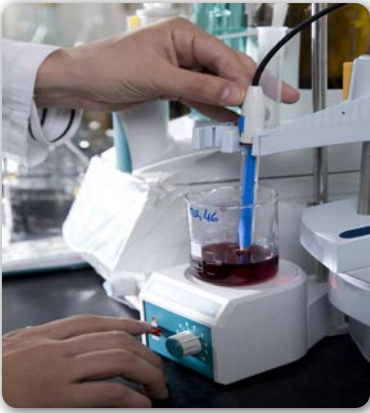
Görsel 1.22: Koyu gıdalarda titrasyon asitliği tayini ön hazırlık işlemi
