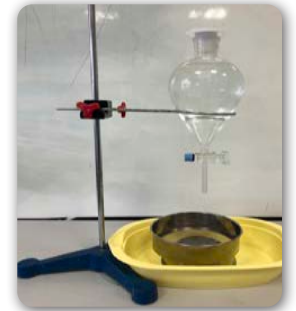
Görsel 3.27: Yıkama düzeneği (ayırma hunisi)
