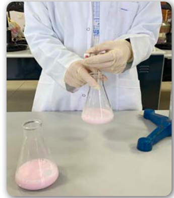
Görsel 6.19: Standart renk çözeltisi ve titrasyon işlemi
