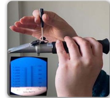
Görsel 1.12: El refraktometresinin kalibrasyonu
