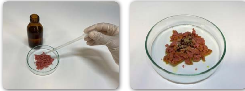
Görsel 7.18: Nessler çözeltisi ile amonyak testi
