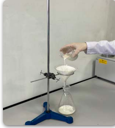
Görsel 6.8: Süt numunesinin pamuk diskten süzülmesi
