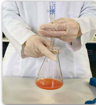
Görsel 6.18: Peynirde tuz tayininde titrasyon işlemi
