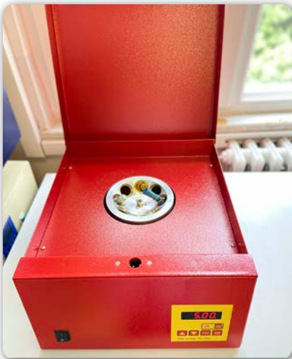
Görsel 6.16: Bütirometrenin gerber santrifüjüne yerleştirilmesi
