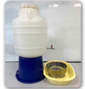
Görsel 3.26: Yıkama düzeneği (musluklu bidon)
