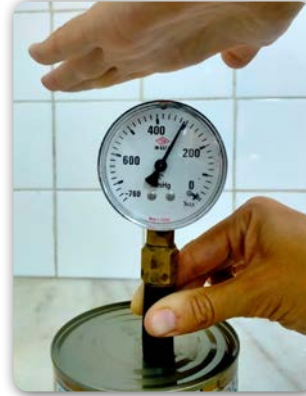
Görsel 2.15: Vakummetre kullanımı
