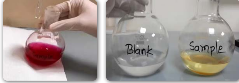
Görsel 5.5: Titrasyonda renk dönüşümü (titrasyon öncesi ve sonrası)
