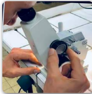
Görsel 1.11: Abbe refraktometresinin kalibrasyonu
