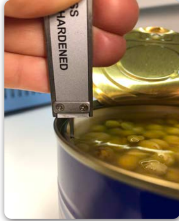
Görsel 2.17: Kumpasla brüt tepe boşluğu ölçümü
