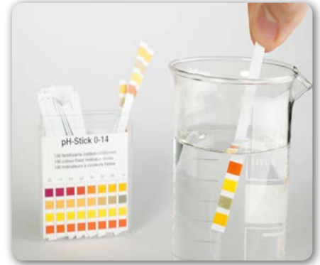
Görsel 1.19: pH indikatör kâğıdı ile ölçüm
