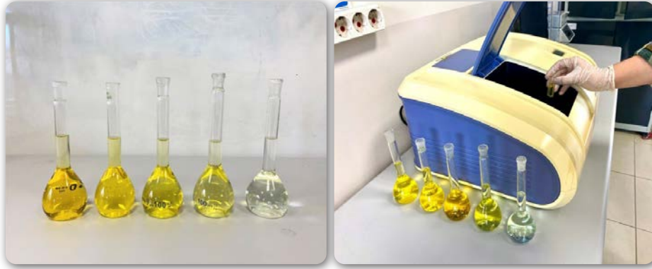
Görsel 7.24: Çözelti serisi ve spektrofotometrede okuma
