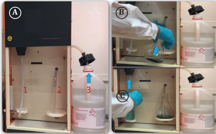
Görsel 4.10: Damıtma ünitesine sodyum hidroksit (A), borik asit (B) ve numune tüpünün (C) yerleştirilmesi
