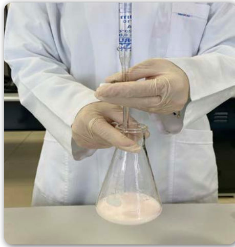
Görsel 6.13: Titrasyon yöntemi ile asitlik tayini
