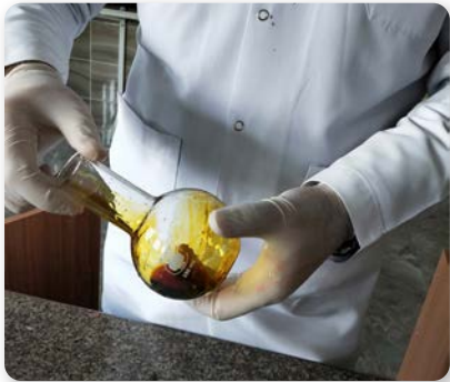
Görsel 1.2.1: Kromik asit çözeltisi ile cam malzeme temizliği
