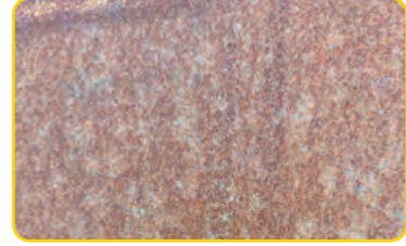
Görsel 1.4: Çeliğin üniform korozyonu
