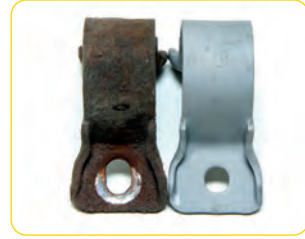
Görsel 1.7: Aşınmalı korozyona uğramış metaldeki değişim
