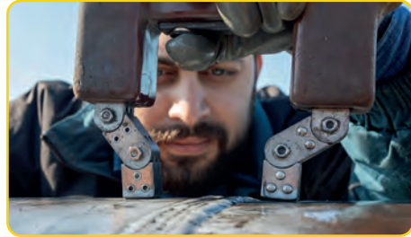
Görsel 1.14: Manyetik partikül incelemesi
