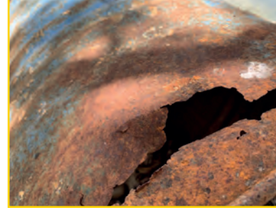
Görsel 1.22: Petrol tankında erozyon
