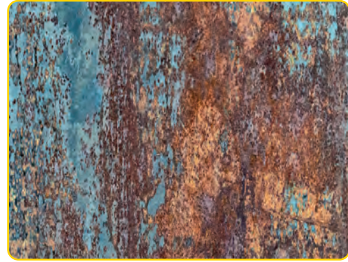
Görsel 1.19: Atmosferik korozyonun metale etkisi
