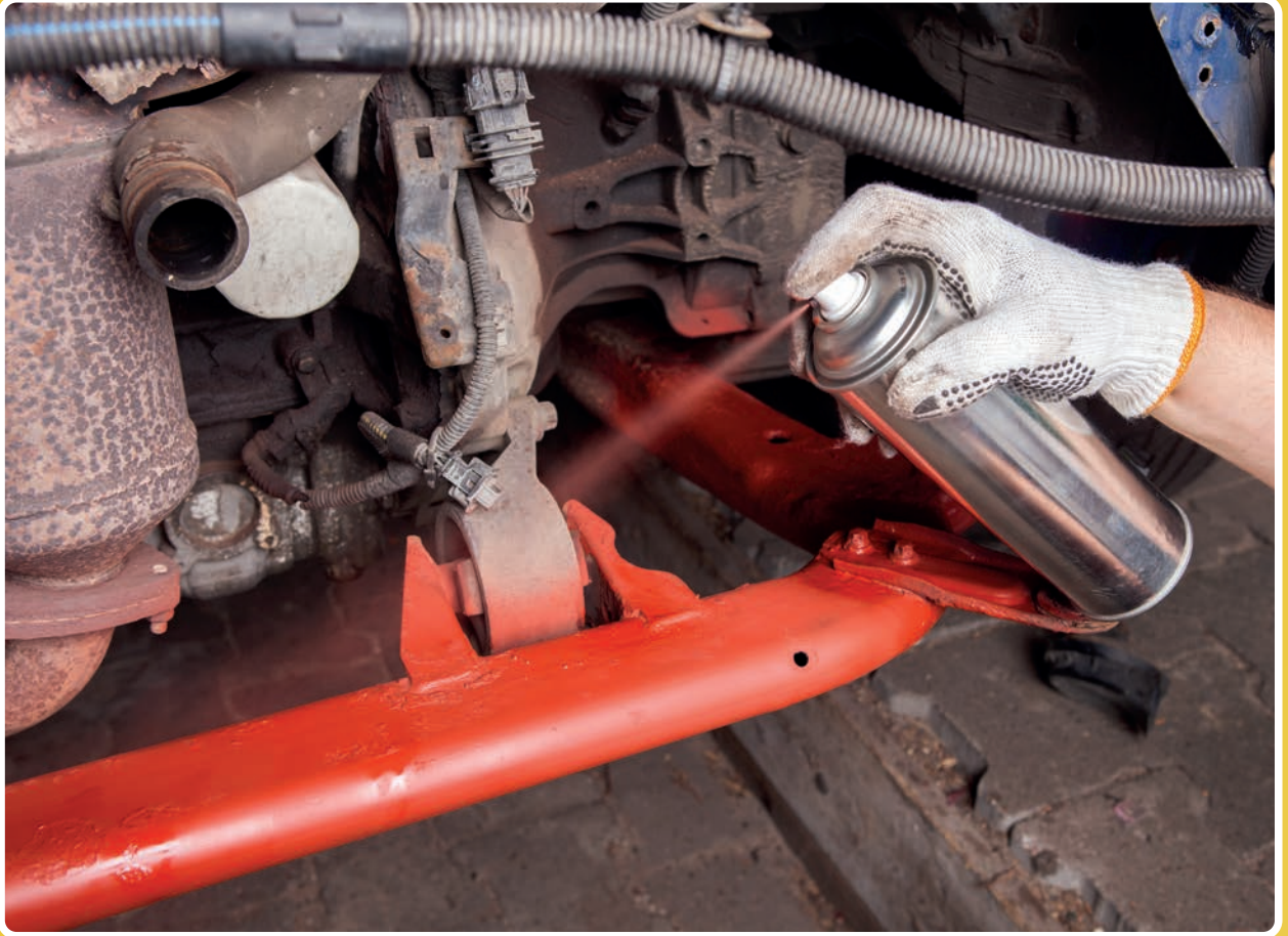
Görsel 9.6: Korozyonu önlemek için yapılan boyama işlemi
