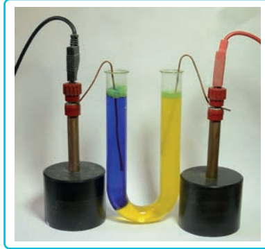
Görsel 9.3: Asitlik derecesine göre korozyon ve renk değişimi
