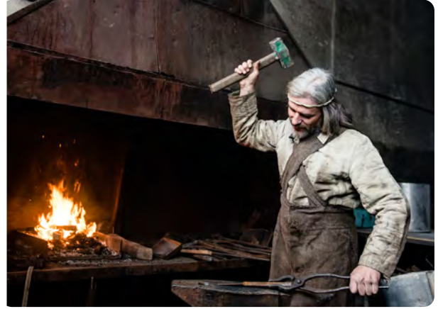
Görsel 5.1: Sıcak demirin maşa ile tutulması
