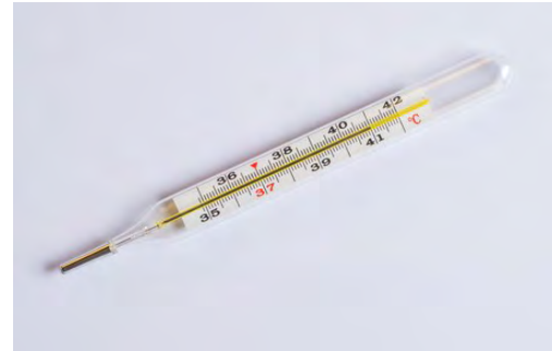
Görsel 3.2: Sıvı genişlemeli cam muhafazalı termometre
