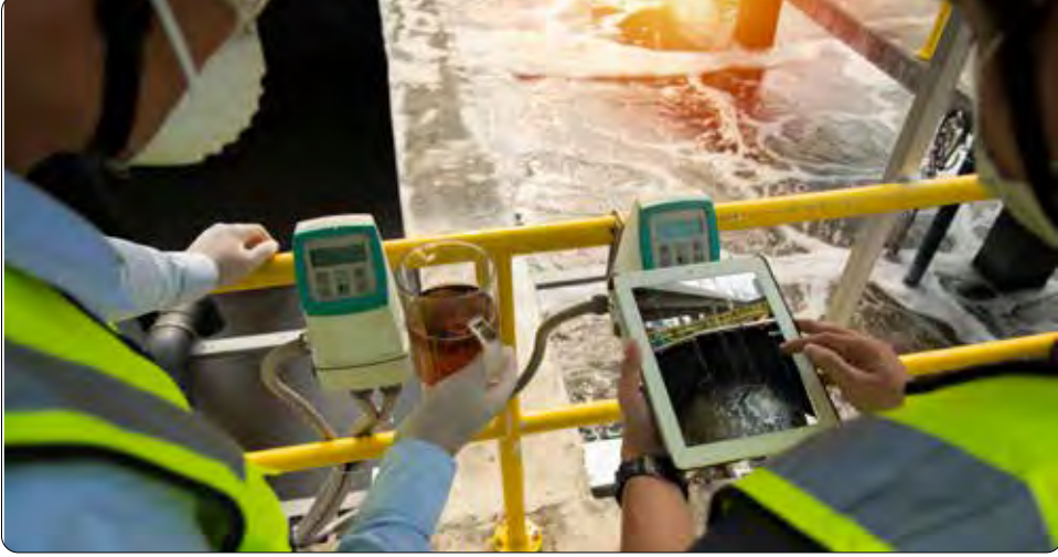
Görsel 8.4: Sudaki oksijen kontrolü
