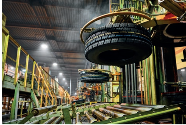
Görsel 5.16: Üniformita makinesinde lastik kontrolü
