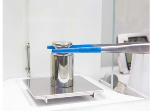
Görsel 1.1.3: Analitik terazinin kalibrasyon doğrulaması.
