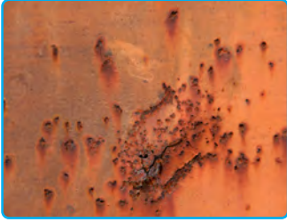
Görsel 1.18: Çukur korozyonu
