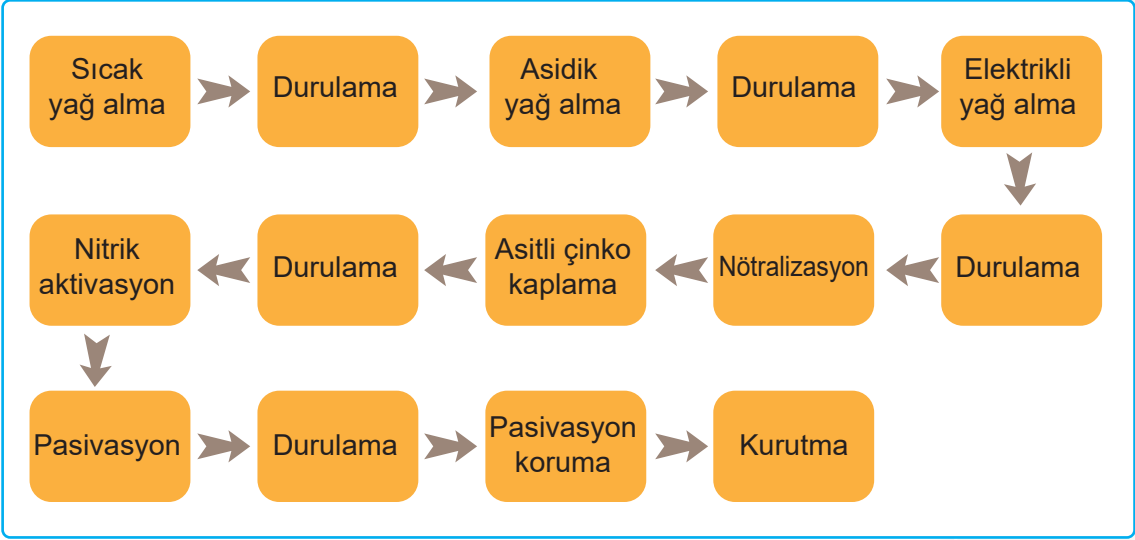
Şekil 4.4: Genel bir çinko prosesi kaplamasında iş şeması
