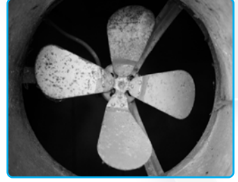
Görsel 3.17: Kavitasyona uğramış pompa pervanesi
