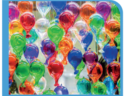
Görsel 3.9: İçerdiği metal oksitleri ile renklendirilmiş camlar
