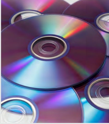
Görsel 4.4: CD yüzeyinde çizgiler üzerinden ışığın ayrılması
