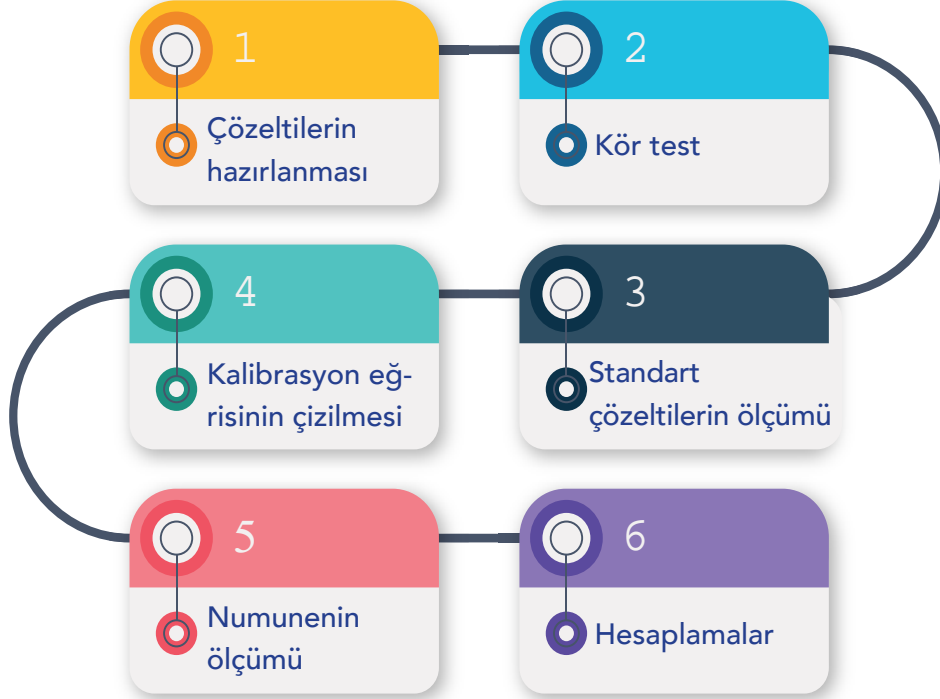
Şema 1.1: Spektrofotometrik analiz işlem basamakları
