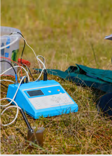
Görsel 8.4: Toprakta iletkenlik ölçümü
