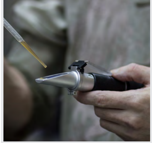
Görsel 5.13: El refraktometresi ile ölçüm
