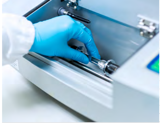
Görsel 6.8: Numunenin polarimetreye yerleştirilmesi
