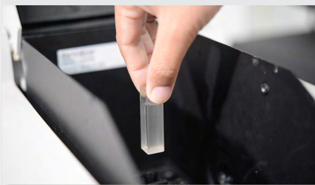
Görsel 2.3: Numunenin hazneye yerleştirilmesi
