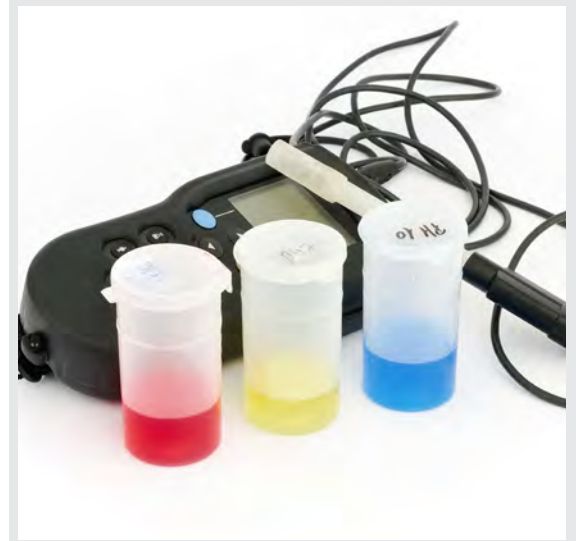
Görsel 7.8: pH metre ile ölçümlerde kullanılan farklı tampon çözeltiler
