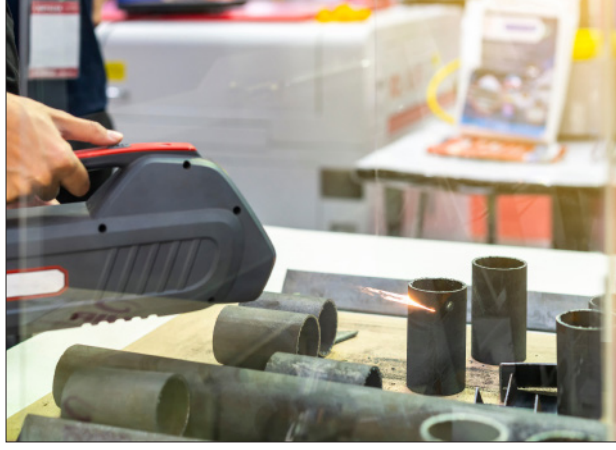
Görsel 2.13: Lazer yöntemiyle yüzey temizleme işlemi
