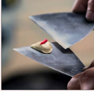
Görsel 5.7: Karıştırılan macun ve sertleştirici component
