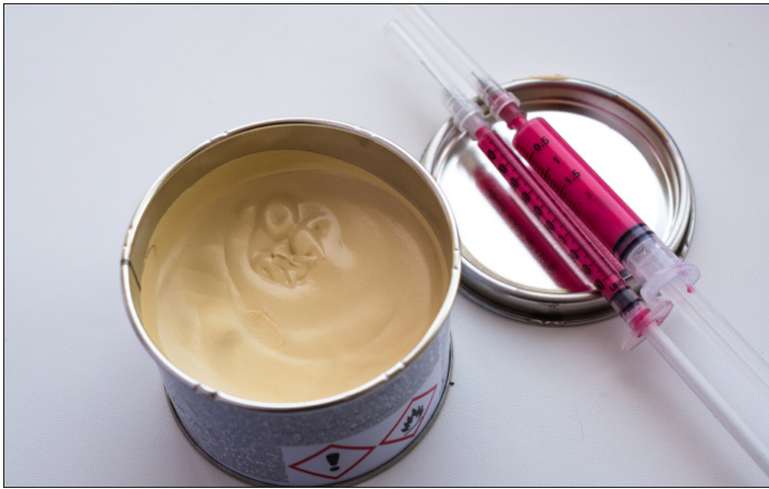
Görsel 5.2: Macun ve sertleştiricinin oranlarını ayarlamakta kullanılan alet
