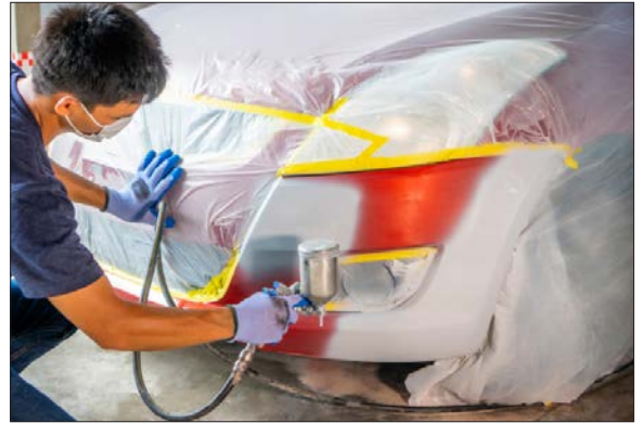
Görsel 7.12: Plastik tampon üzerine plastik astar uygulaması
