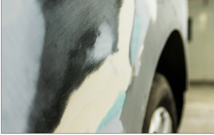
Görsel 5.1: Çelik macun uygulanmış metal yüzey
