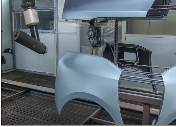
Görsel 2.11: Robot kullanılarak yapılan boya sökme işlemi
