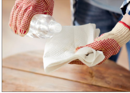
Görsel 2.10: Solvent sürülerek temizlenen ahşap yüzey
