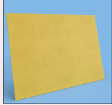
Görsel 6.25: Astar boya uygulanmış MDF panel
