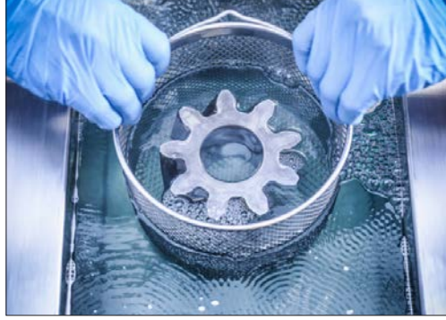
Görsel 2.7: Ultrasonik cihazla temizlenen metal parça
