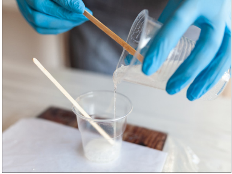
Görsel 5.10: Sertleştirici komponent kullanılan epoksi dolgu macunu
