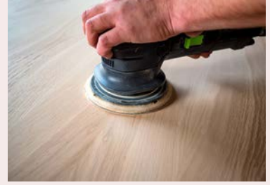
Görsel 1.57: Yüzeyi zımparalanan ahşap
