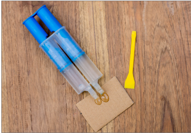
Görsel 5.9: Epoksi macun ve sertleştirici komponentin hazırlanması
