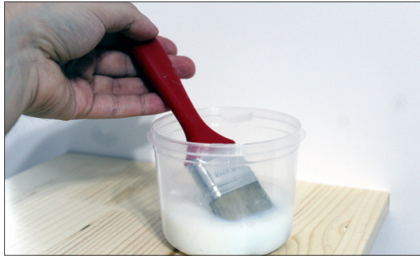
Görsel 6.7: Sıva yüzeye uygulamaya hazır şeffaf astar
