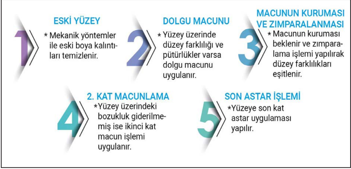
Görsel 6.15: Eski yüzeyler için uygulanması gereken işlem sırası
