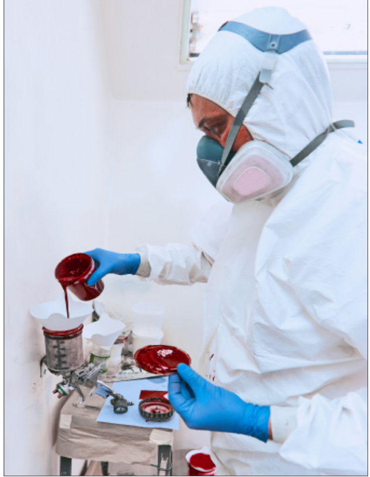
Görsel 1.2: Uçucu organik bileşiklere karşı güvenlik önlemleri almış boya elemanı
