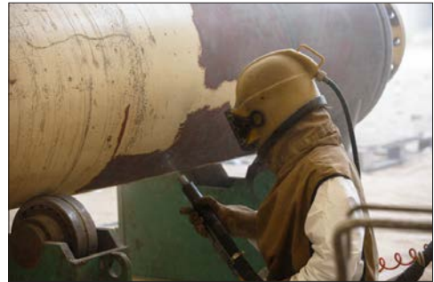
Görsel 2.4: Çabuk kopan pas ve oksit tabakasının kum püskürtme ile temizlenmesi
