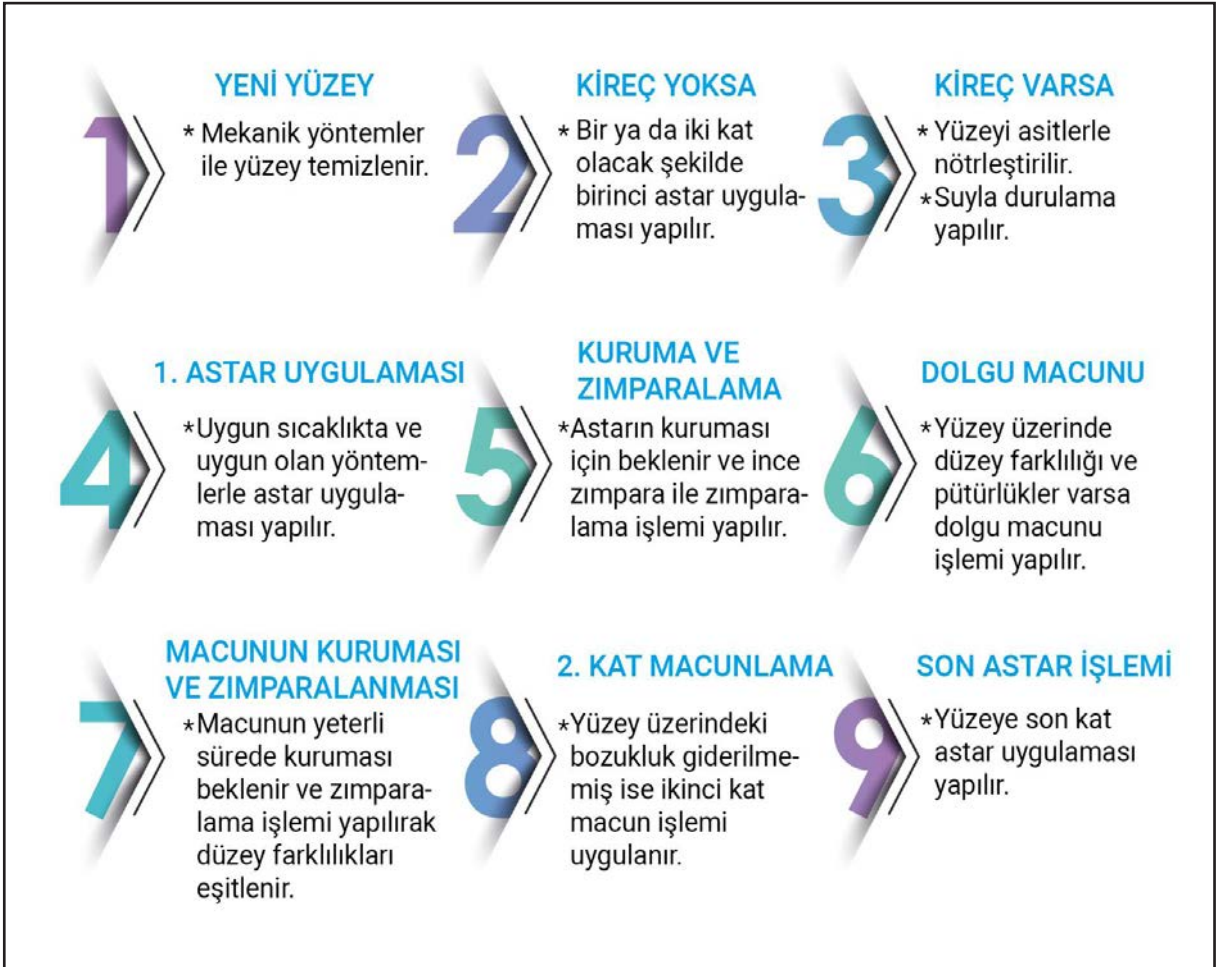
Görsel 6.14: Yeni yüzeyler için uygulanması gereken işlem sırası
