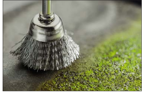
Görsel 2.3: Metal üzerinden pas ve çapakların elektrikli aletlerle temizlenmesi
