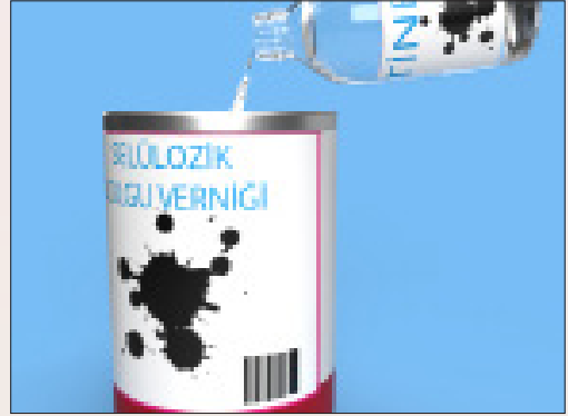
Görsel 4.10: Tiner ile inceltilen dolgu verniği
