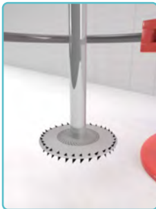
Görsel 6.22: Karıştırıcı bıçağın şafta bağlanması
