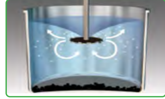
Görsel 2.22: Karıştırıcı shaftı çok yüksekte
