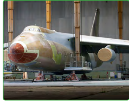
Görsel 6.12: Uçak yüzeyine yapılan son kat boya uygulaması
