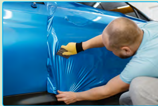
Görsel 6.21: Sökülebilir boya uygulamaları.
