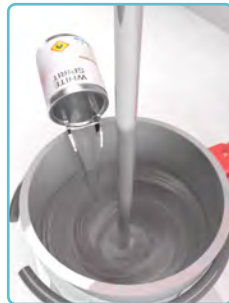
Görsel 6.23: Kazana gaz yağı ilavesi
