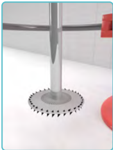
Görsel 6.15: Karıştırıcı bıçağın şafta bağlanması
