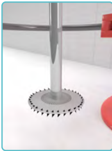
Görsel 6.6: Karıştırıcı bıçağın şafta bağlanması
