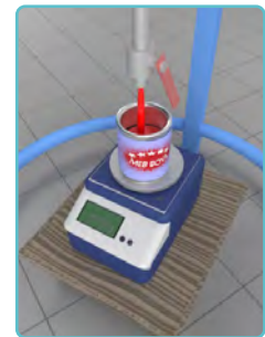
Görsel 4.9: Dolum işleminin yapılması
