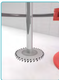
Görsel 5.11: Karıştırıcı bıçağın şafta bağlanması
