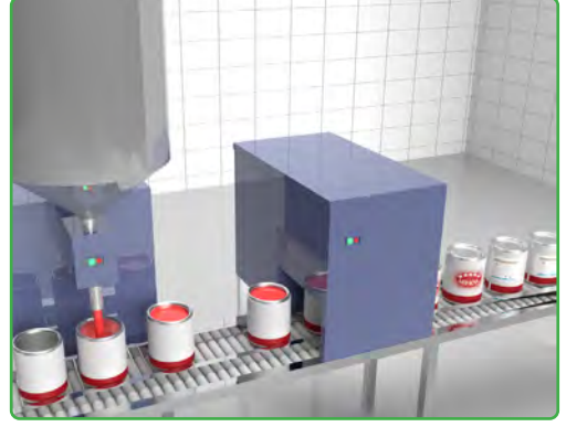
Görsel 4.5: Otomatik çalışan boya dolum makinesi
