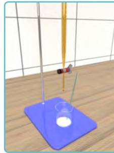
Görsel 1.33: Büretten keten tohumu yağı damlatılması
