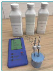
Görsel 1.24: Kalibre edilen pH metre
