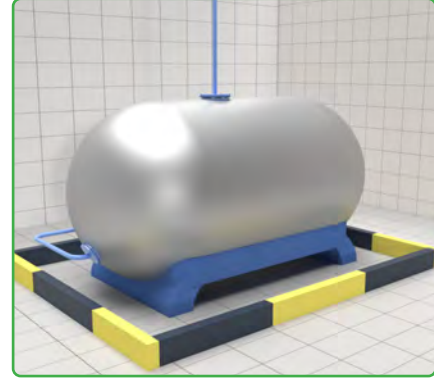
Görsel 4.15: Sızıntılara karşı önlem olarak etrafı set ile çevrilmiş sıvı depolama tankı
