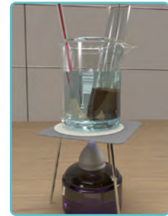
Görsel 1.38: Termokromik boyanın ısıtılması
